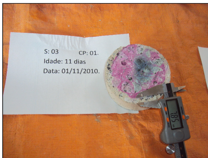
Foto 16. Detalhe do sistema de medição da frente de carbonatação no corpo de prova (CP01) após aplicação de fenolftaleína.
