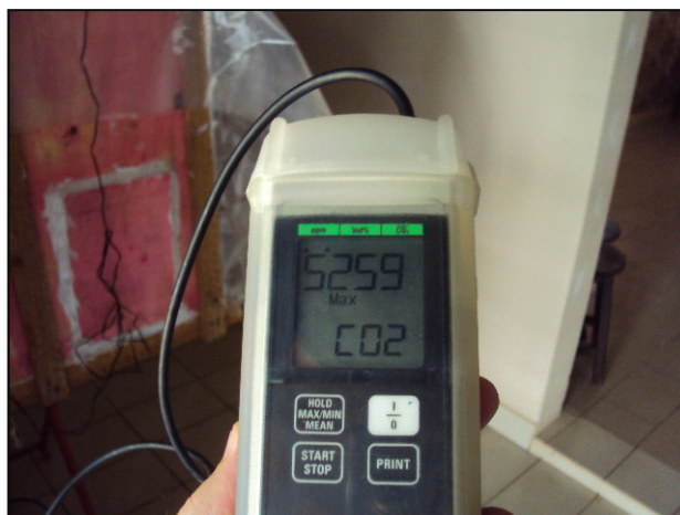
Foto 13. Ensaio de concentração de CO 2 com medidor eletrônico.
