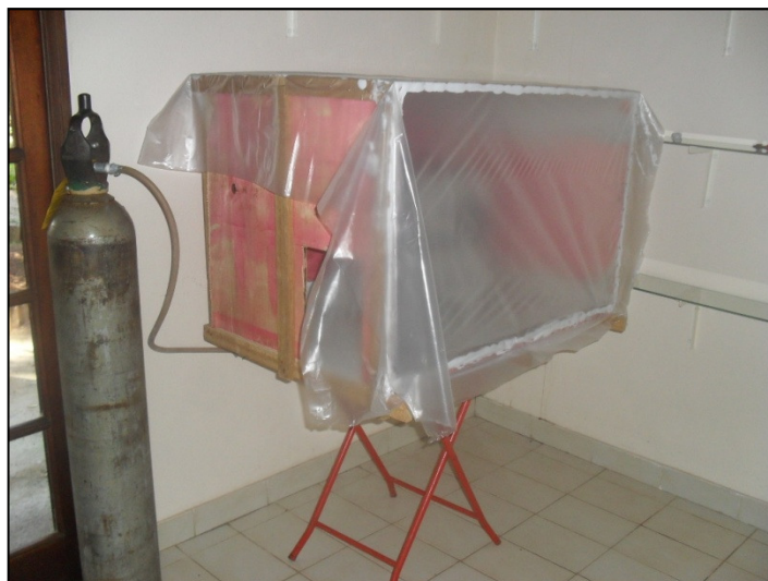
Foto 8. Câmara de Carbonatação
