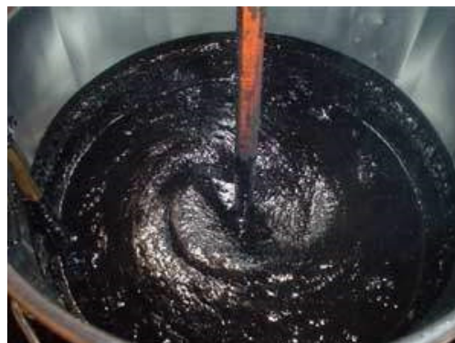
FIGURA 2.10 – Asfalto + Borracha de Pneu.
