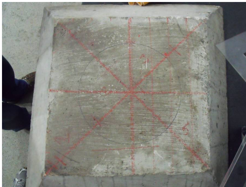
Fotografia 03 – Placa de concreto com marcação para realização do ensaio de ultra-som para medição indireta
