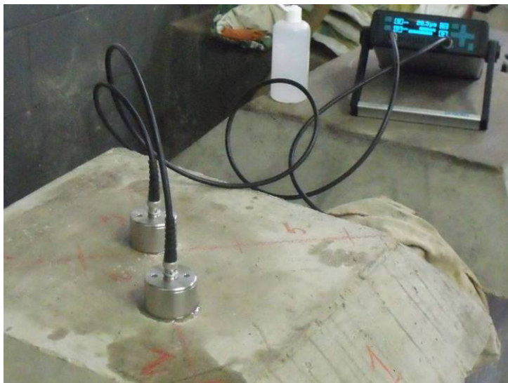
Fotografia 04 – Realização do ensaio de ultra-son pela medição indireta
