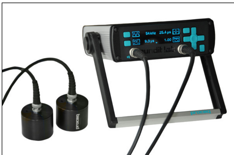
Figura 10 – Aparelho de ultra-som PundtLab
