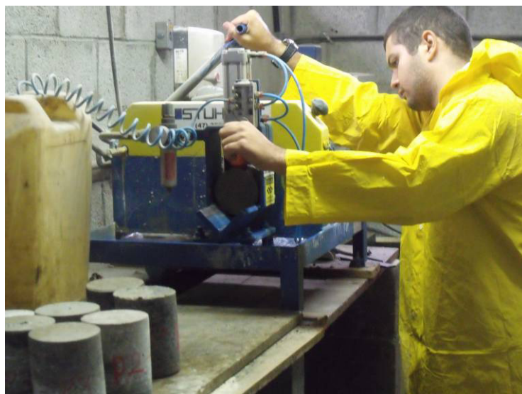
Fotografia 06 – Retificação dos corpos-de-prova
