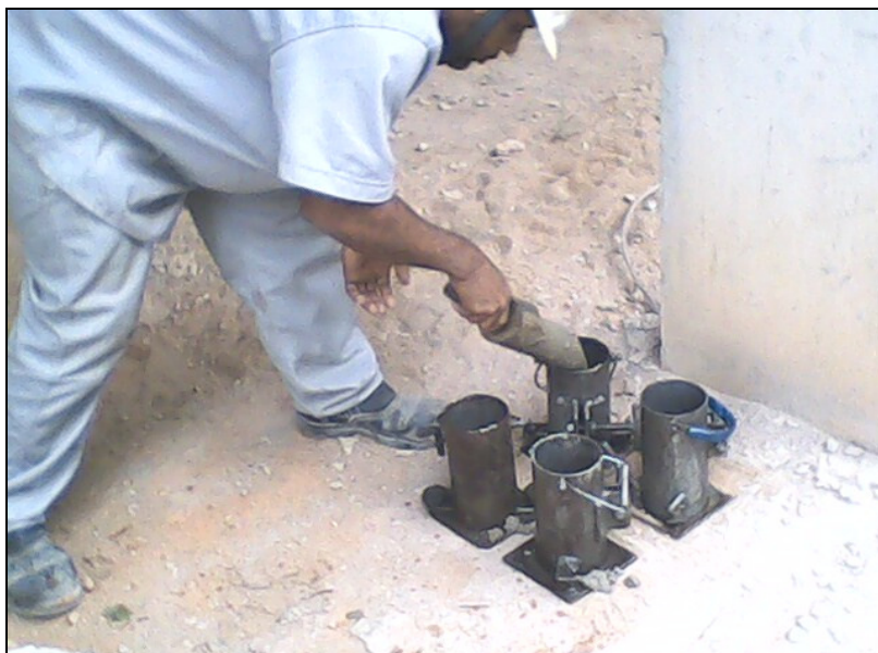
Fotografia 01 – Moldagem dos corpos de prova
