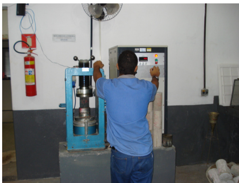
Fotografia 09 – Ensaio de compressão dos testemunhos extraídos das placas
