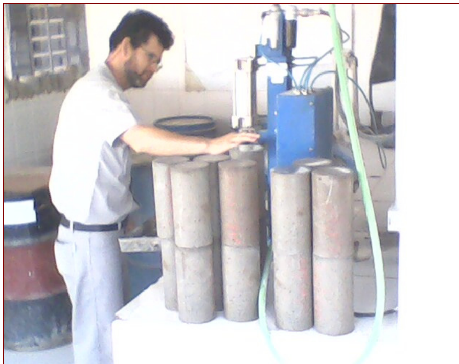
Fotografia 2 – Capeamento ou retificação dos corpos de prova
