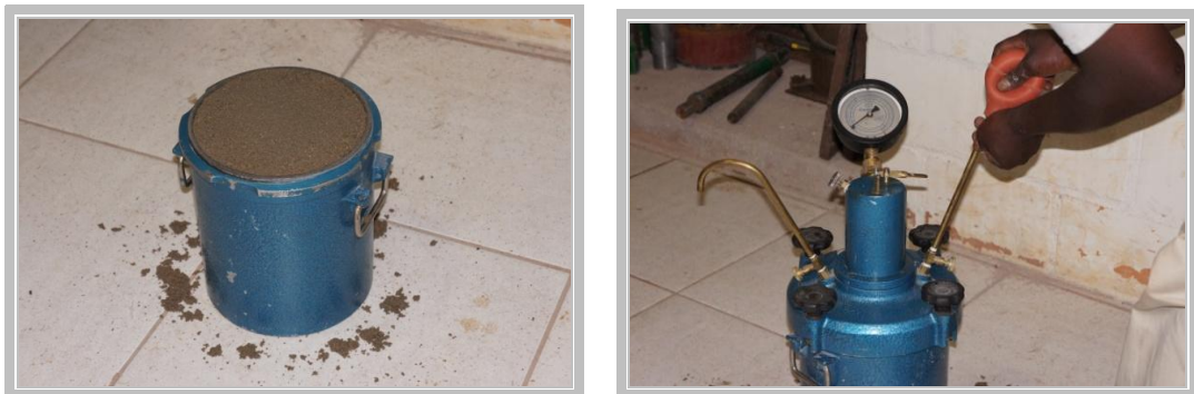
Fotos 16 e 17 – Vistas da realização do ensaio de teor de ar incorporado.
