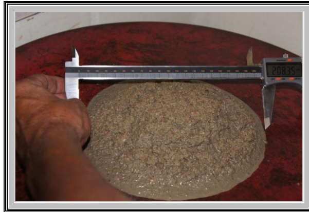
Foto 12 – Vista da medição do índice consistência
