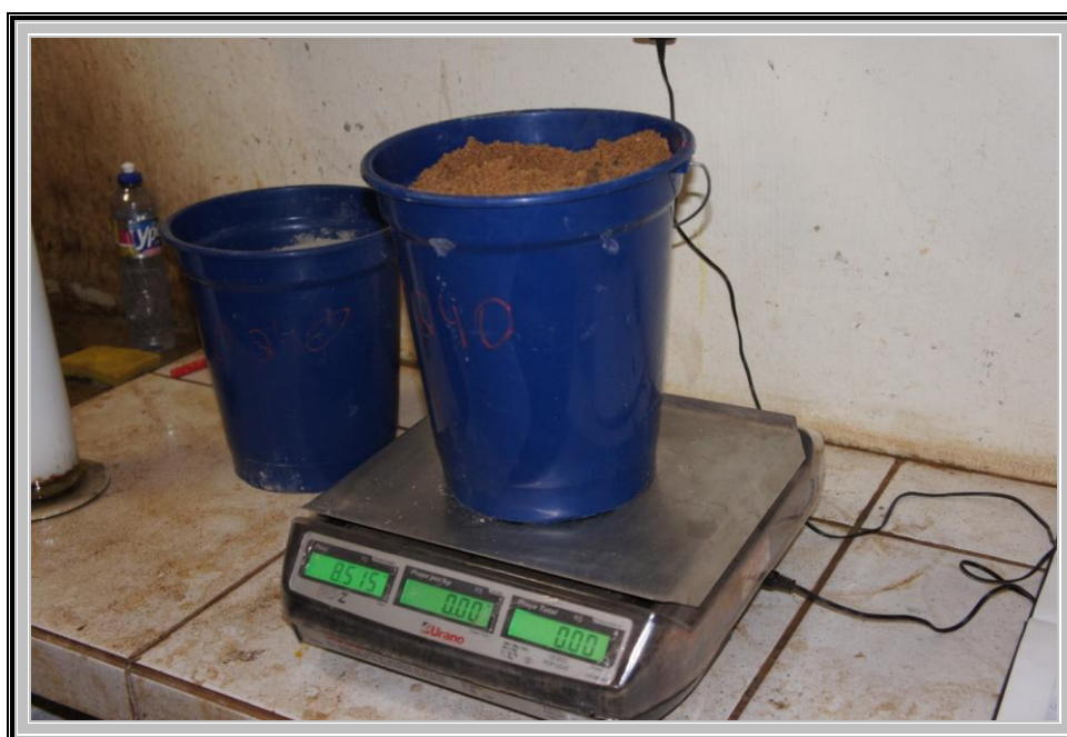
Foto 2 – Vista da pesagem da areia na balança.
