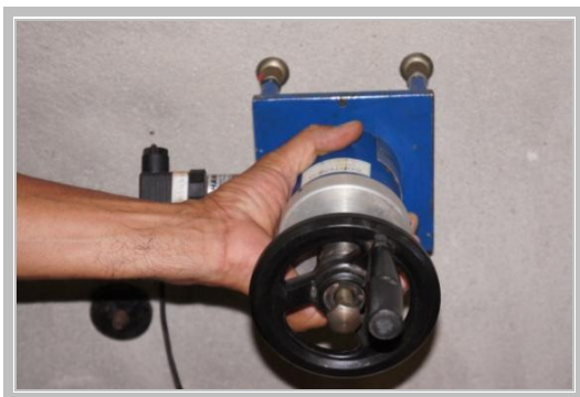
Fotos 21 e 22 – Vista da execução do ensaio no painel de argamassa.
