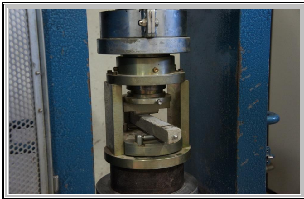
Foto 18 – Vista do corpo de prova na prensa para realização do ensaio de tração na flexão.
