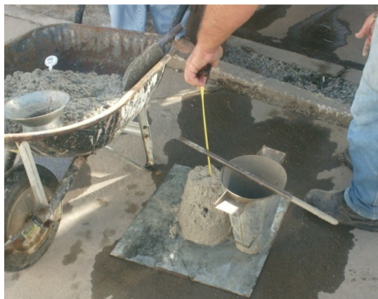
Figura 10 - Ensaio de abatimento de tronco de cone
