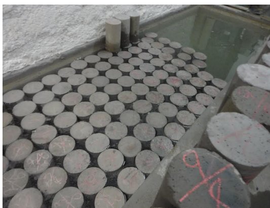
Foto 12 – Cura dos corpos de prova
