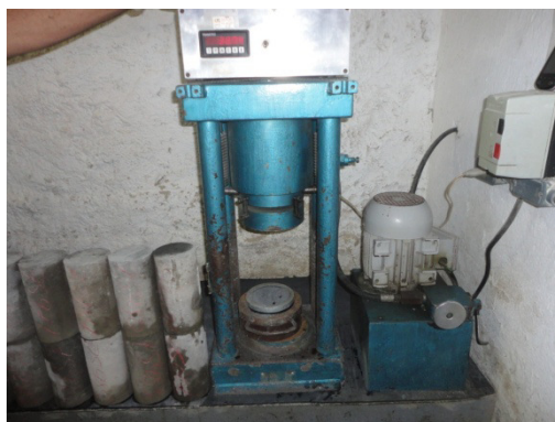
Foto 13 – Equipamento de ensaio para teste de resistência à compressão
