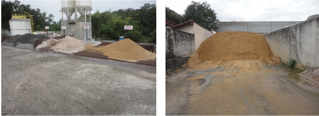
Figuras 7 e 8 - Baías de estocagem de agregados
