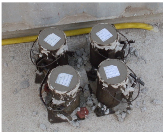
Foto 11 - Moldagem dos corpos de prova
