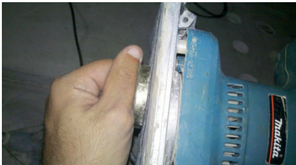
Foto 27: Lixamento da face inferior das pastilhas
