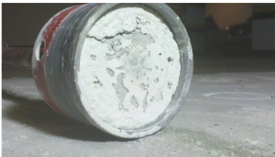
Foto 34: Corpo-de-prova rompido na interface argamassa/substrato durante o corte
