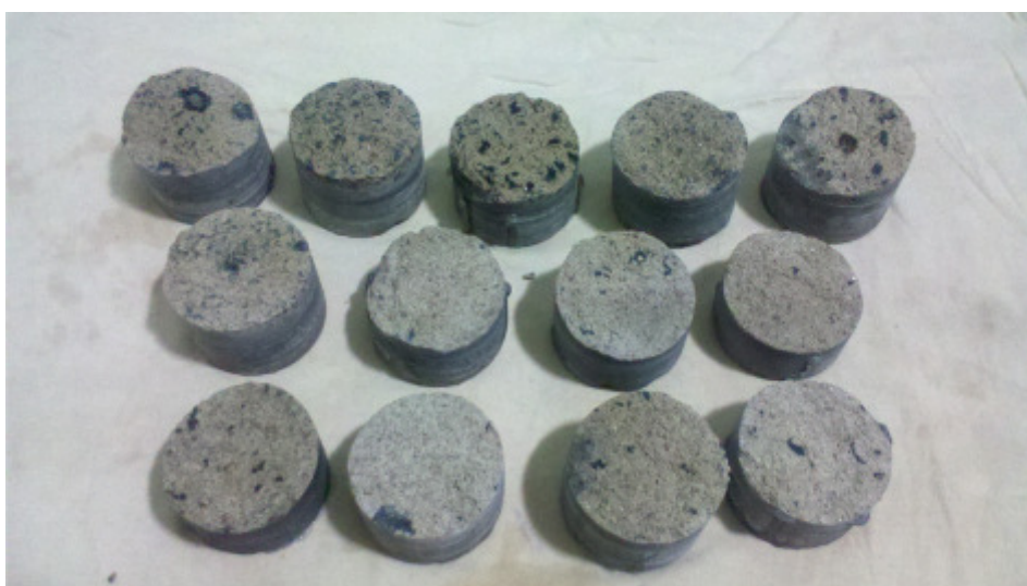
Foto 35: – Comparação entre as superfícies de ruptura ocorridas no substrato.
