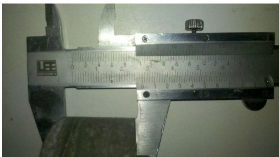
Foto 26: Medição da espessura do CP para confirmação da interface de ruptura
