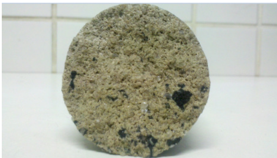
Foto 24: Interface de ruptura do CP rompido durante o processo de corte.
