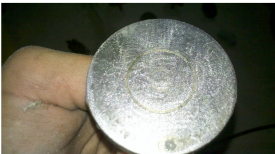
Foto 28: Resultado após a conclusão do lixamento
