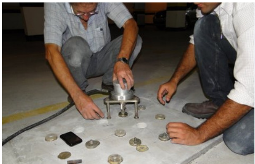
Foto 30: Ensaio de arrancamento
