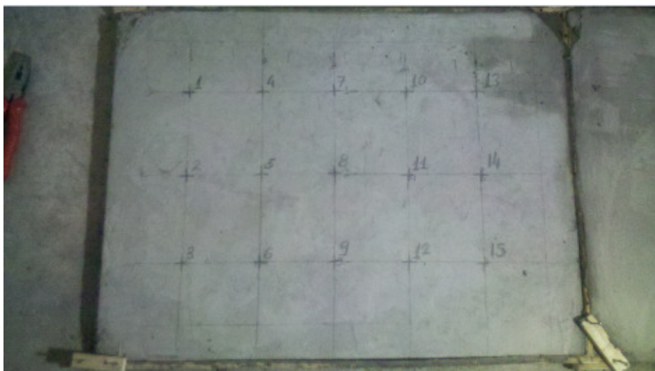
Foto 22: Distribuição dos pontos de corte sobre área de referência
