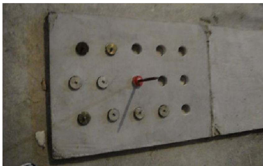
Foto 29: Área de referência com as pastilhas coladas e posicionadas para o ensaio
