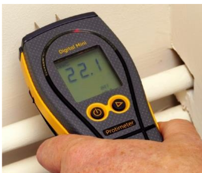
Figura 22: Exemplo de medição de umidade com umidímetros de pinos (PROTIMETER, 2020)
