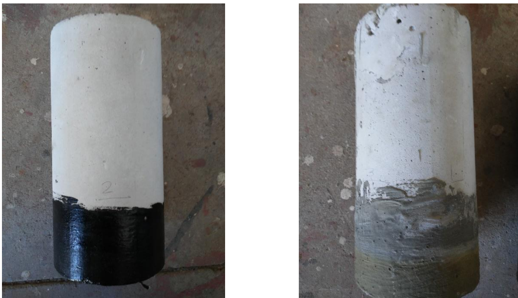
Figura 24: Corpos-de-prova com aplicação de emulsão asfáltica e argamassa polimérica (AUTORES, 2020)
