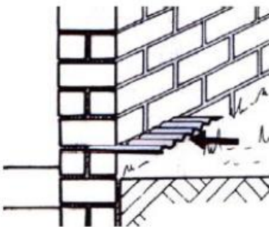
Figura 21: Introdução forçada de chapa metálica (BRITO, 2003)
