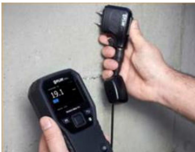
Figura 29: Procedimento de medição com umidímetro de pinos (FLIR, 2020)
