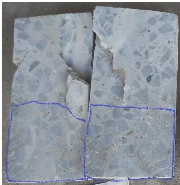
Figura 27: Altura de elevação capilar no interior de um corpo-de-prova (AUTORES,2020)
