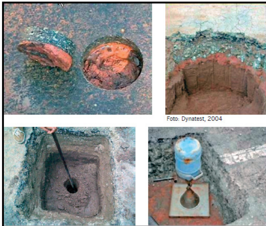
Figura 22 – Exemplos de extração de corpos de prova e de poços de sondagem em pavimentos em uso.
