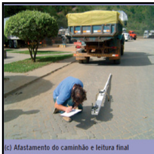
Figura 26 – Passos do ensaio com a viga Benkelman
