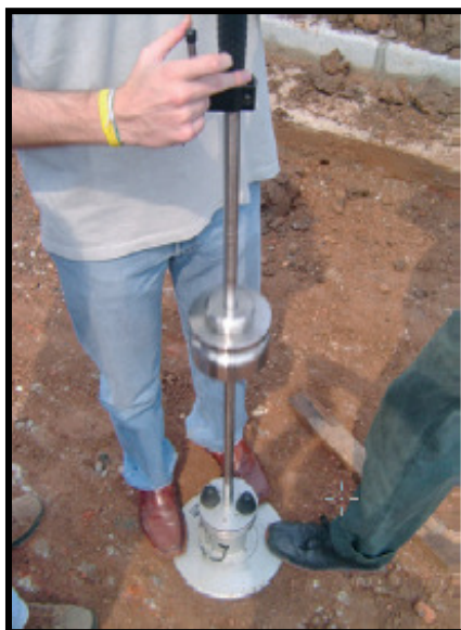
Figura 24 – Equipamento de avaliação expedita do módulo elástico do pavimento (Foto: Abdou, 2005).
