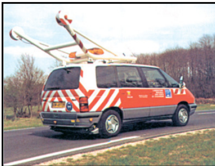
(a) Palas com laser e câmara filmadora digital (foto: LCPC, 2003).
