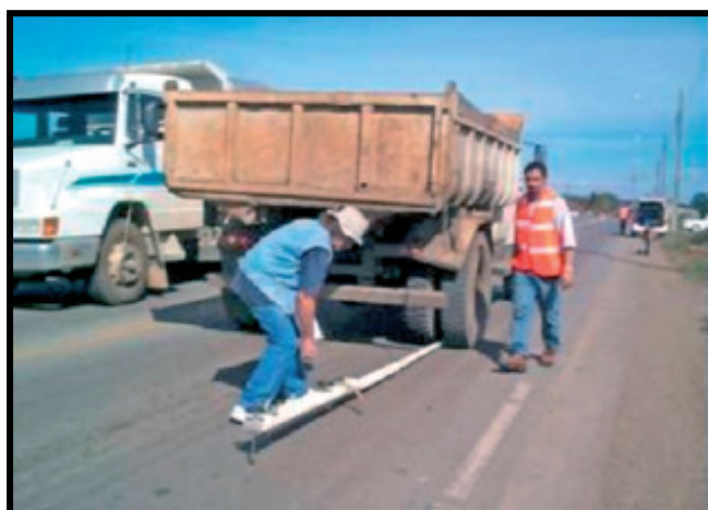
(b) Medida com viga Benkelman em campo
