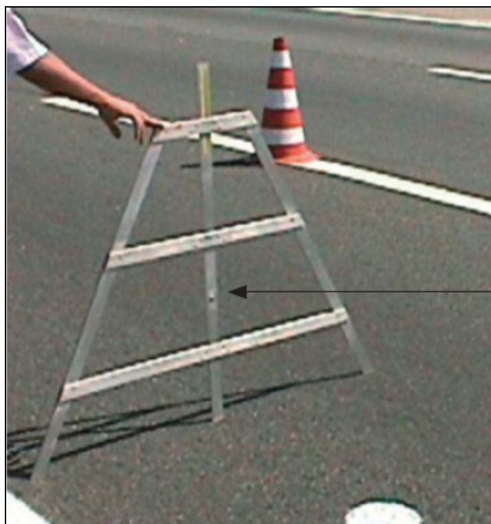
Figura 19 – Treliça metálica para medida dos afundamentos em trilha de roda.
