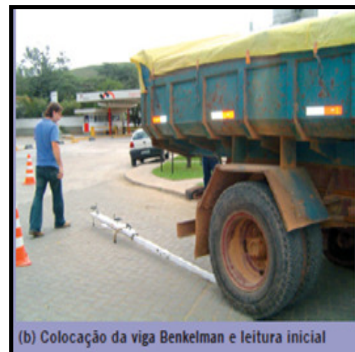
Figura 26 – Passos do ensaio com a viga Benkelman
