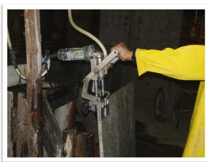
Figura 11: Furadeira para realizar furo na lateral da placa
