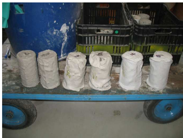
Figura 3.17. Revestimento polimérico flexível, da esquerda para a direita, nas concentrações de 5%, 20% e 50% após 29 dias em imersão em ácido sulfúrico.
