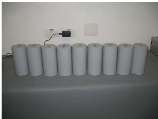
Figura 3.3. Resina epóxi base água aplicada nos corpos-de-prova
