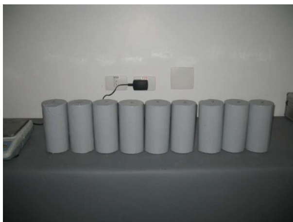
Figura 3.4. Resina epóxi bi-componente aplicada nos corpos-de-prova
