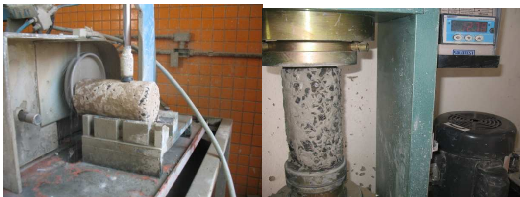
(a) (b) Figura 3.49. Equipamento utilizado para desbaste do topo do CP (a); Prensa utilizada para ruptura dos CP's (b).
