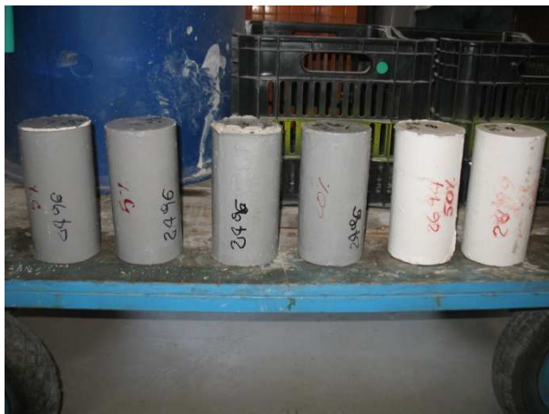
Figura 3.42. Resina base poliuretano, da esquerda para a direita, nas concentrações de 5%, 20% e 50% após 28 dias em imersão em ácido sulfúrico.
