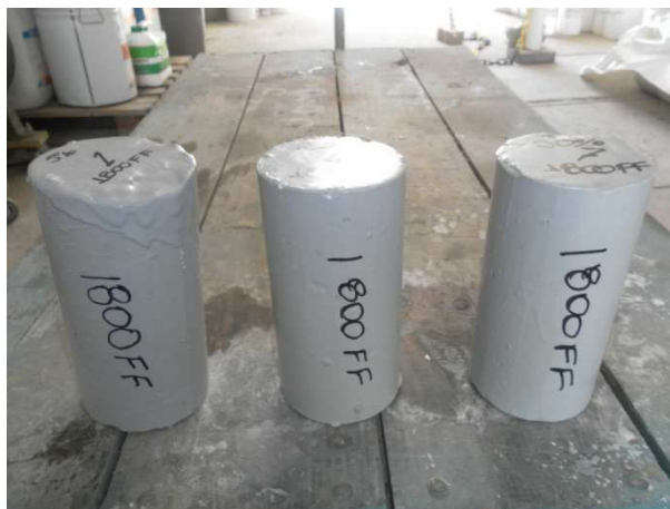
Figura 3.35. Resina epóxi bi-componente, da esquerda para a direita, nas concentrações de 5%, 20% e 50% após 14 dias em imersão em ácido sulfúrico.
