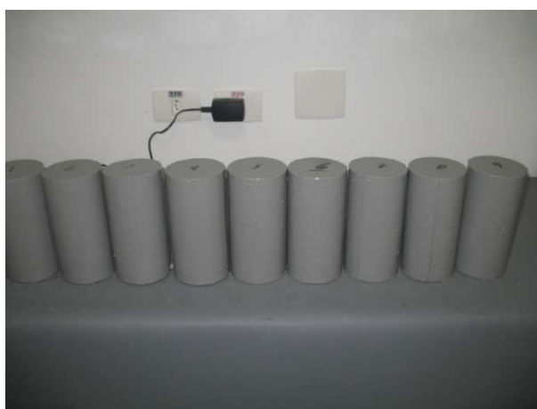
Figura 3.5. Resina base poliuretano aplicada nos corpos-de-prova
