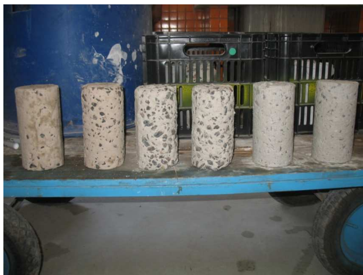
Figura 3.48. CP's de Referência, da esquerda para a direita, nas concentrações de 5%, 20% e 50% após 29 dias em imersão em ácido sulfúrico
