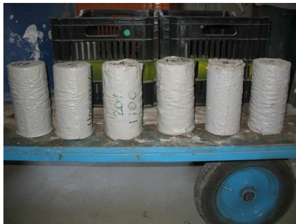
Figura 3.30. Resina epóxi base água da esquerda para a direita, nas concentrações de 5%, 20% e 50% após 29 dias em imersão em ácido sulfúrico.
