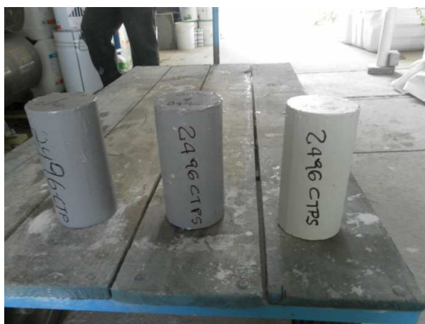
Figura 3.41. Resina base poliuretano, da esquerda para a direita, nas concentrações de 5%, 20% e 50% após 14 dias em imersão em ácido sulfúrico
