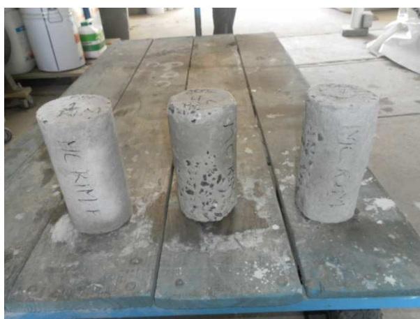
Figura 3.23. Revestimento mineral, da esquerda para a direita, nas concentrações de 5%, 20% e 50% após 14 dias em imersão em ácido sulfúrico.
