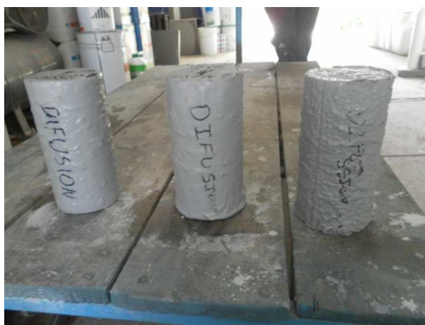
Figura 3.29. Resina epóxi base água, da esquerda para a direita, nas concentrações de 5%, 20% e 50% após 14 dias em imersão em ácido sulfúrico.
