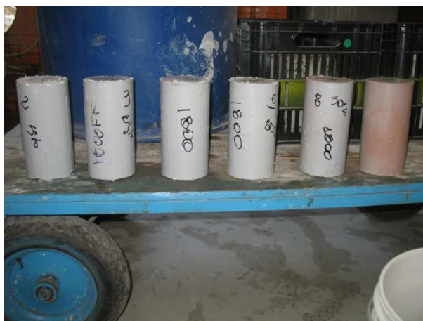
Figura 3.36. Resina epóxi bi-componente, da esquerda para a direita, nas concentrações de 5%, 20% e 50% após 29 dias em imersão em ácido sulfúrico.
