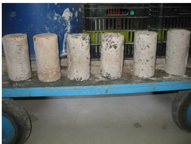
Figura 3.24. Revestimento mineral, da esquerda para a direita, nas concentrações de 5%, 20% e 50% após 29 dias em imersão em ácido sulfúrico.
