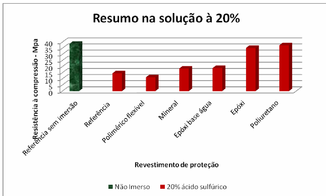
Gráfico 4.8. Variação da resistência à compressão dos corpos-de-prova na solução à 20%
