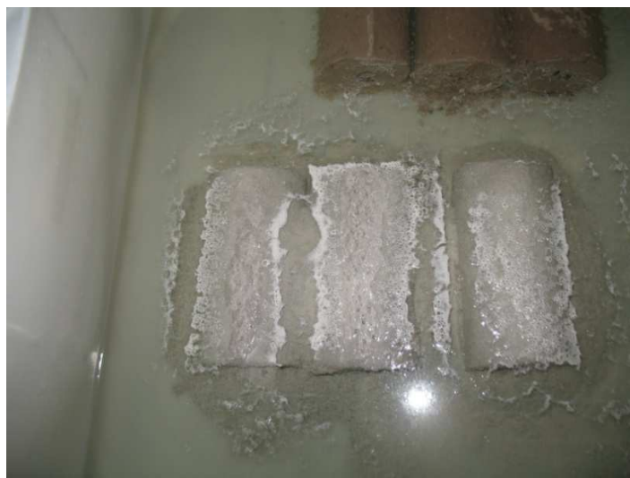
Figura 3.20. Revestimento mineral depositado no fundo do tanque após 14 dias em imersão em ácido sulfúrico com concentração de 5%
