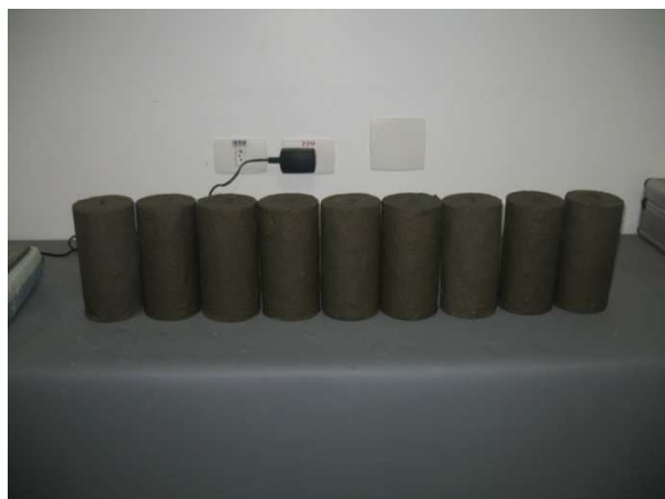
Figura 3.1. Revestimento polimérico flexível aplicados nos corpos-de-prova
