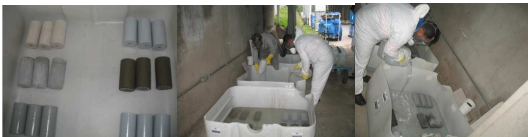
Figura 3.7. Corpos-de-prova dispostos nos tanques antes da solução
