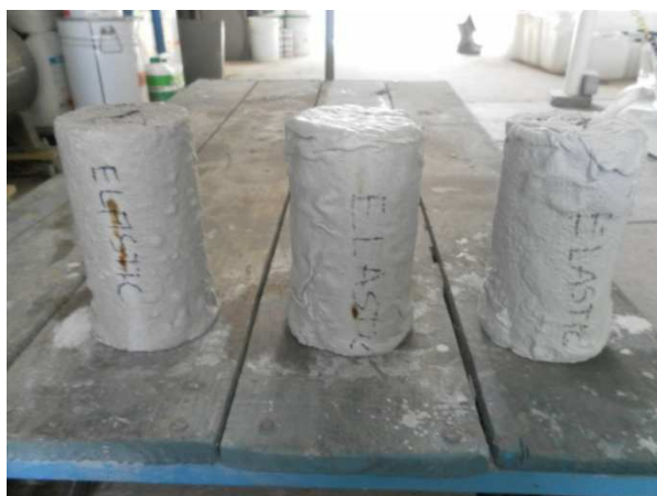
Figura 3.16. Revestimento polimérico flexível, da esquerda para a direita, nas concentrações de 5%, 20% e 50% após 14 dias em imersão em ácido sulfúrico.
