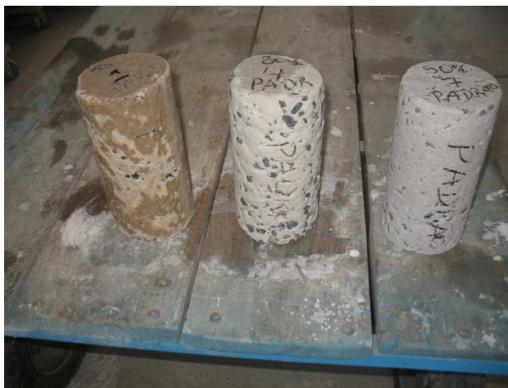
Figura 3.47. CP's de Referência, da esquerda para a direita, nas concentrações de 5%, 20% e 50% após 14 dias em imersão em ácido sulfúrico.
