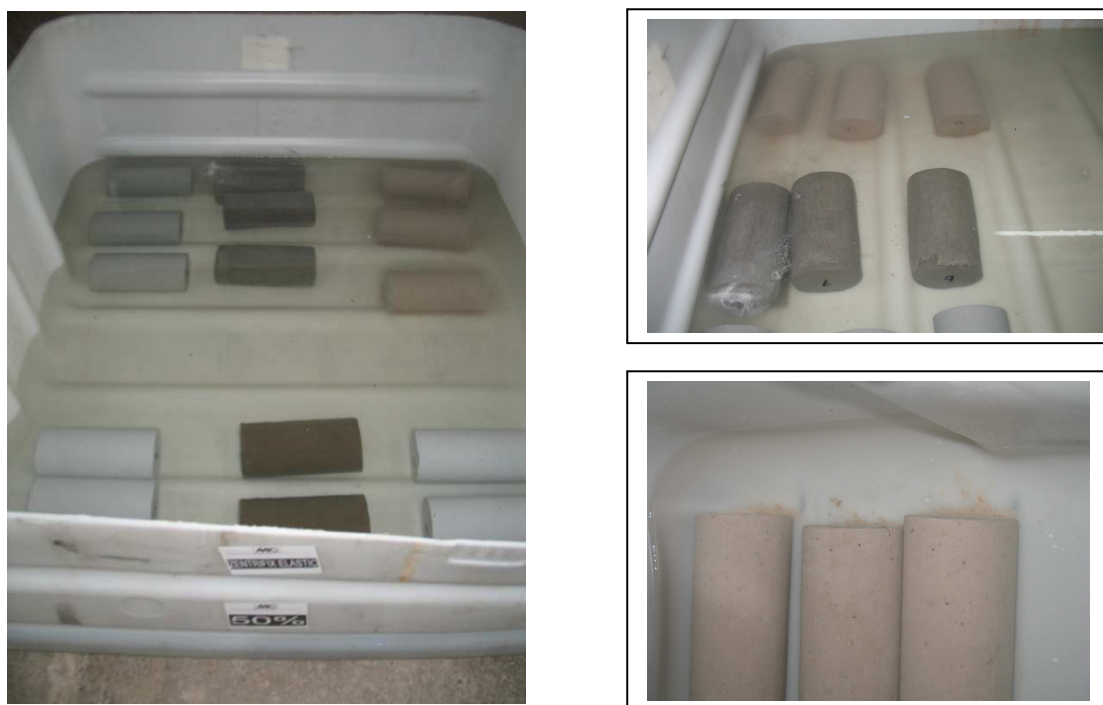
Figura 3.8. Constatações de reações logo após a adição da solução a 50%
