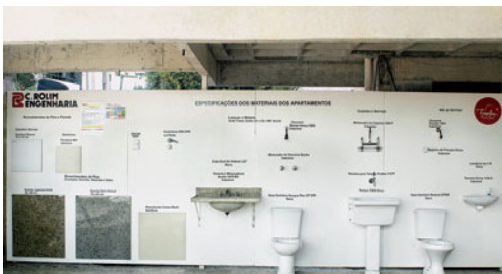
Figura 8 – Painel de especificação de materiais
