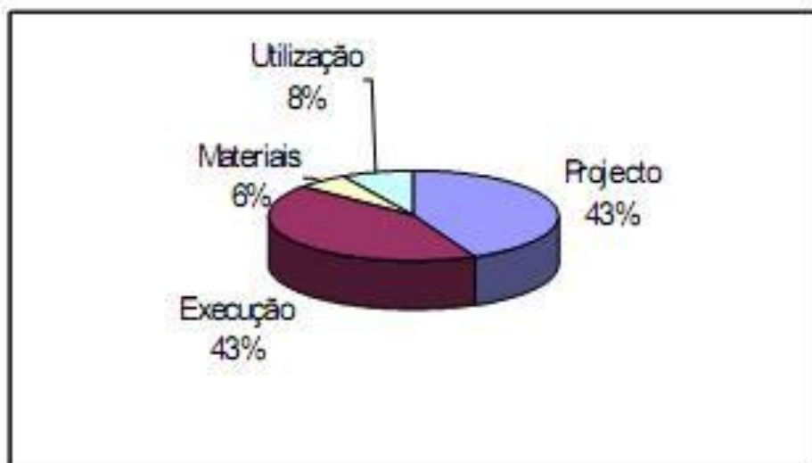
Principais sinistros de edificação – Fonte Martins (2006)
