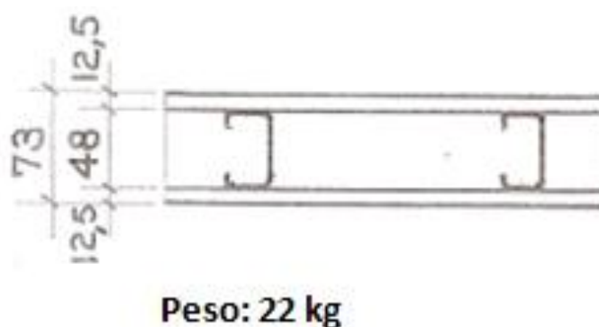
Figura 20: Parede de drywall com espessura mínima.
