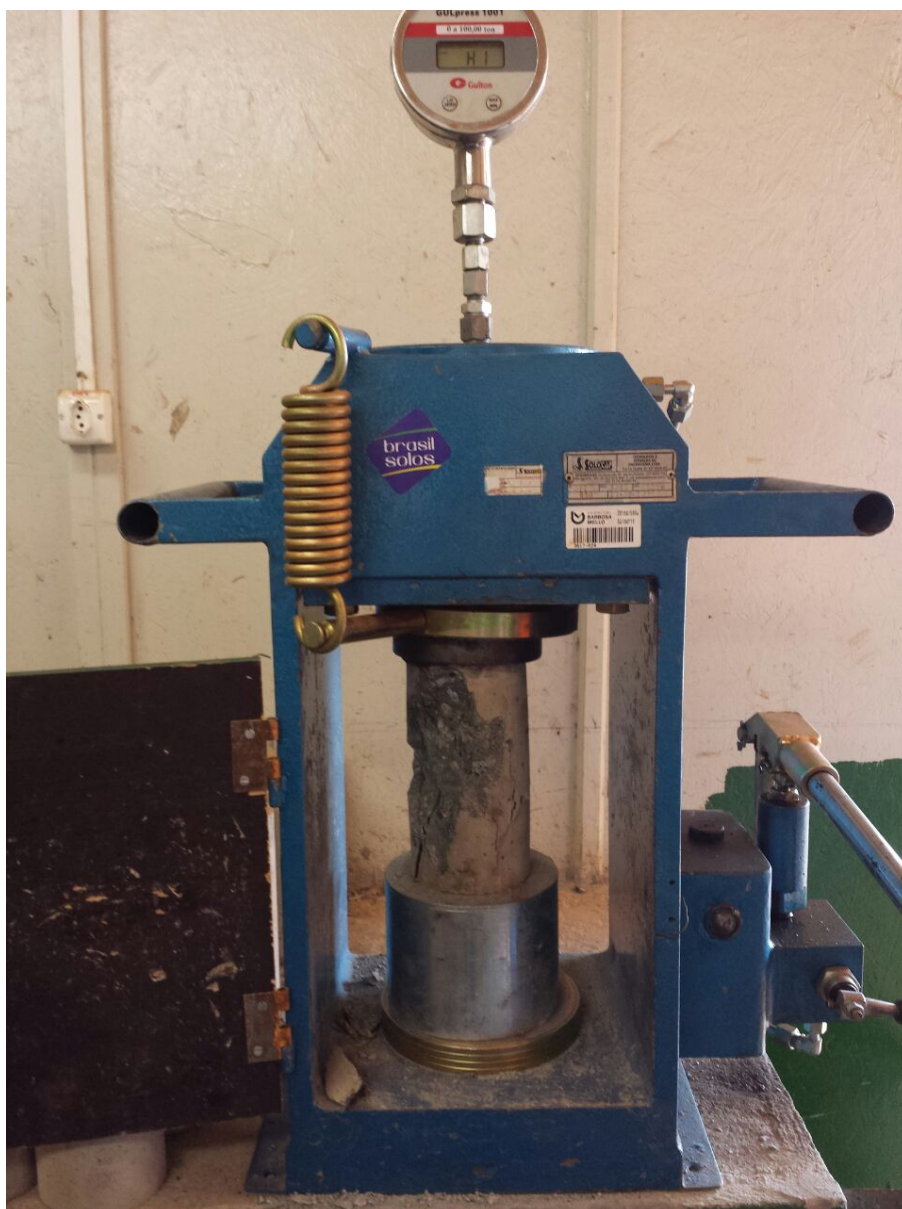
Figura 2 – Teste de corpo de prova de concreto
