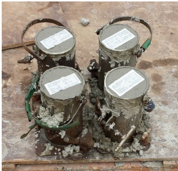
Figura 1 – Coleta de corpos de prova de concreto
