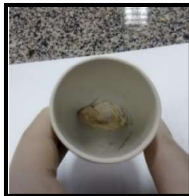
FIGURA 17. Calcinação do papel filtro (Mazer et al. 2014)
