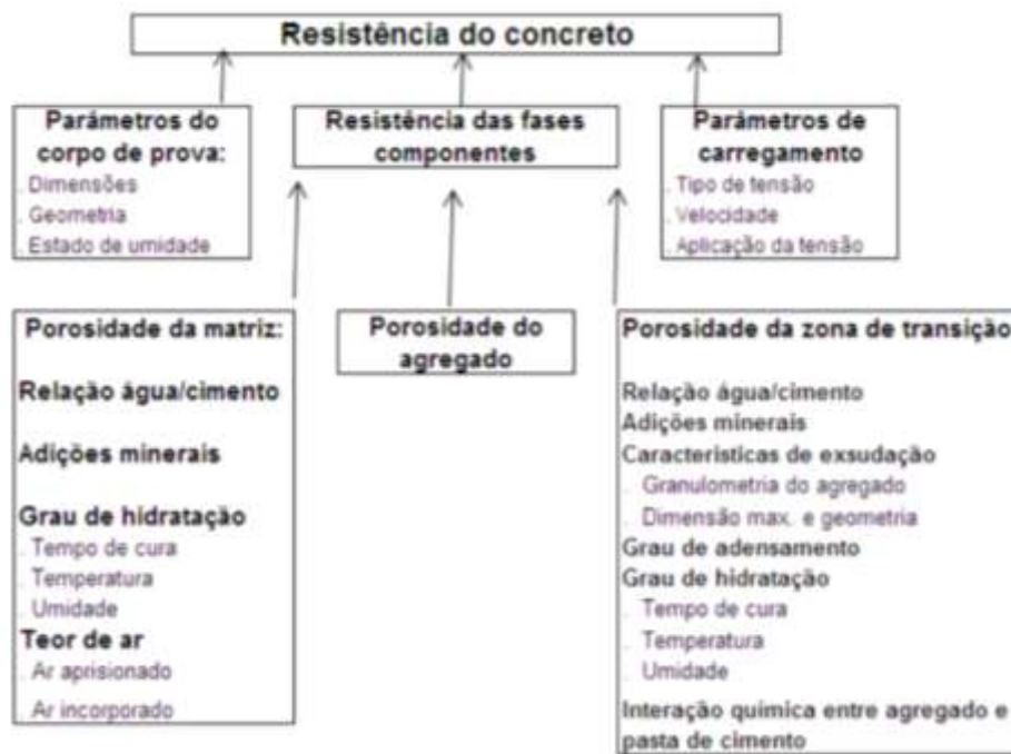
FIGURA 11. Fatores que influenciam a resistência à compressão do concreto. (Adaptado de Mehta e Monteiro, 1994).
