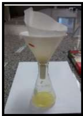
FIGURA 14. Filtragem após ataque ácido (Mazer et al. 2014)
