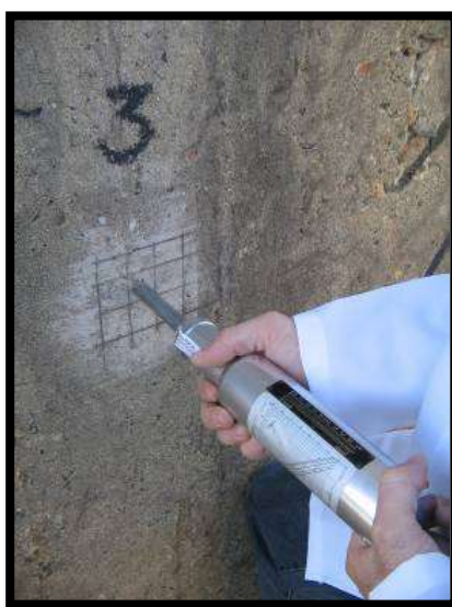
FIGURA 22. Aparelho de Esclerômetro em funcionamento (Luiz, 2016)
