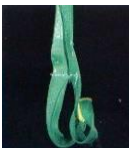
Fotos 18 – Danos nas cintas de içamento de carga.
