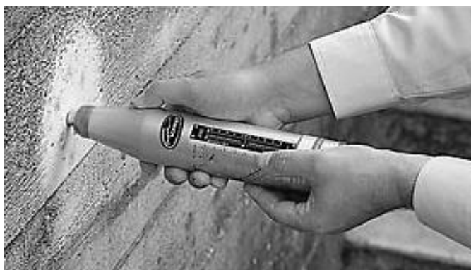
Figura 5 - Aplicação do esclerômetro de reflexão e gráfico de correção (Fonte: www.proceq.com , acesso em 10/12/2013).
