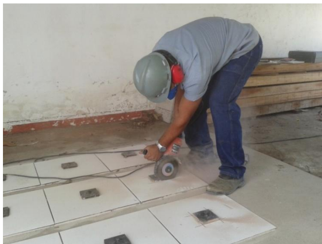
Figura 36 – Corte dos corpos de prova.
