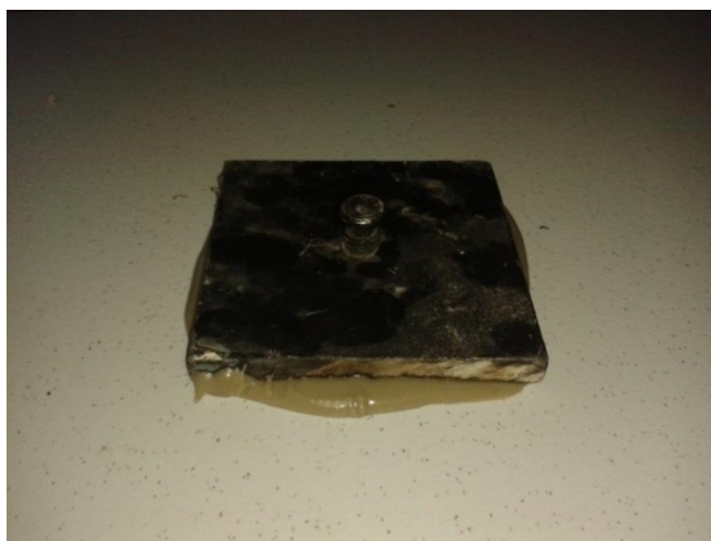
Figura 35 – Plastilha metálica colada na placa cerâmica.
