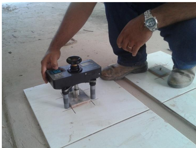
Figura 5 – Equipamento utilizado no ensaio de resistência de aderência à tração.
