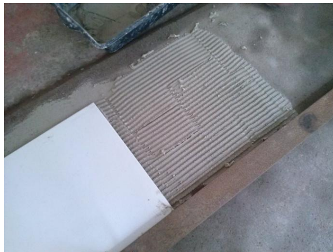
Figura 18 – Argamassa colante aplicada no contrapiso (amostra 1).
