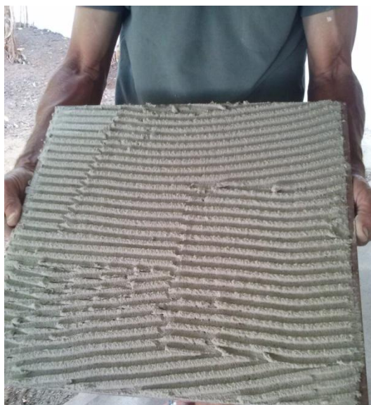
Figura 24 – Argamassa colante aplicada no tardo (amostra 2).
