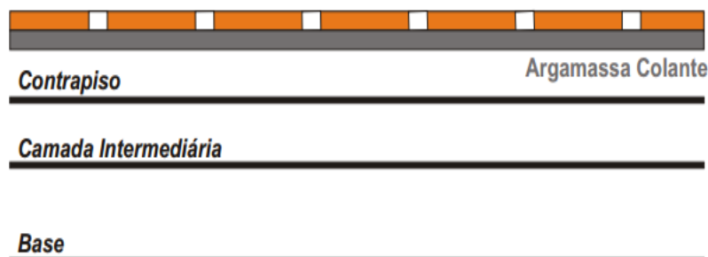
Figura 1- Camadas sistema cerâmico de piso.
