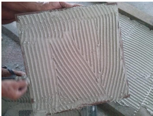
Figura 19 – Argamassa colante aplicada no tardo (amostra 1).
