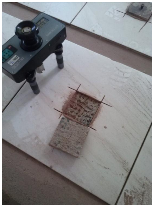
Figura 40 – Corpo de prova após ruptura.
