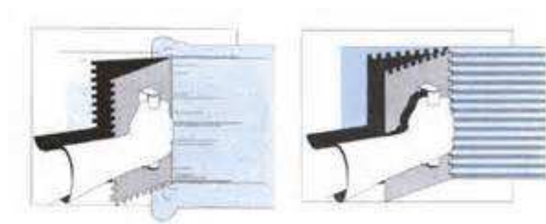
FIGURA 4-5– SEQUENCIA DE APLICAÇÃO DA ARGAMASSA COLANTE, NBR 13753 (ABNT, 1996).
