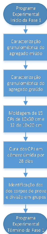
Figura 18 – Fase 01: Caracterização dos materiais utilizados e moldagem das amostras
