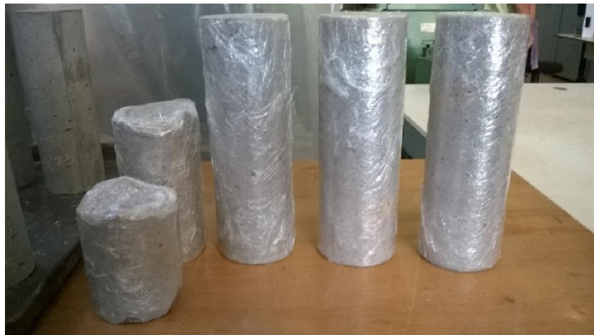
Figura 37 – Vista dos corpos de prova vedados com filme plástico.
