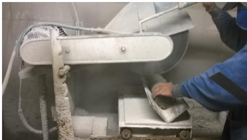
Figura 39 – Posicionamento do corpo de prova para corte de camada.
