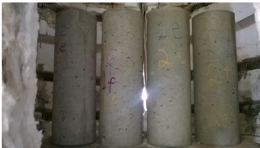
Figura 28 – Posicionamento dos corpos de prova no forno para o aquecimento até 200 °C (Grupo 2).
