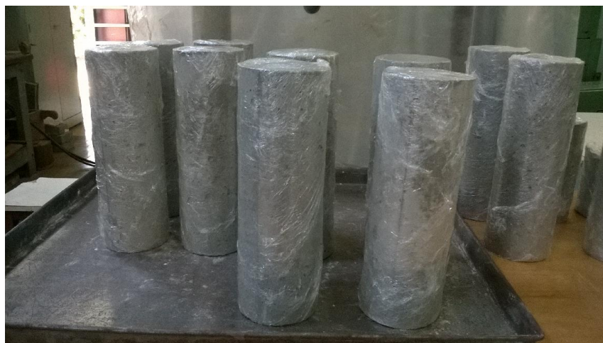
Figura 25 – Vista dos corpos de prova envolvidos em plástico filme, entre o aquecimento na estufa e o aquecimento no forno.
