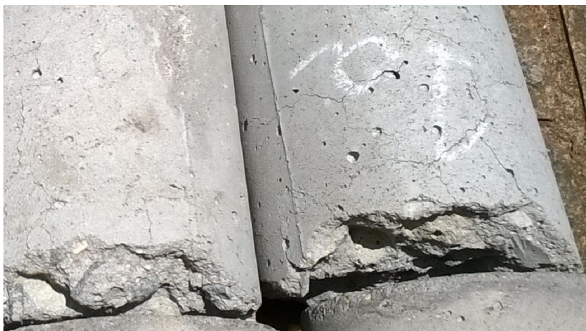
Figura 46 – Detalhe da fissuração dos corpos de prova aquecidos a 600 °C.
