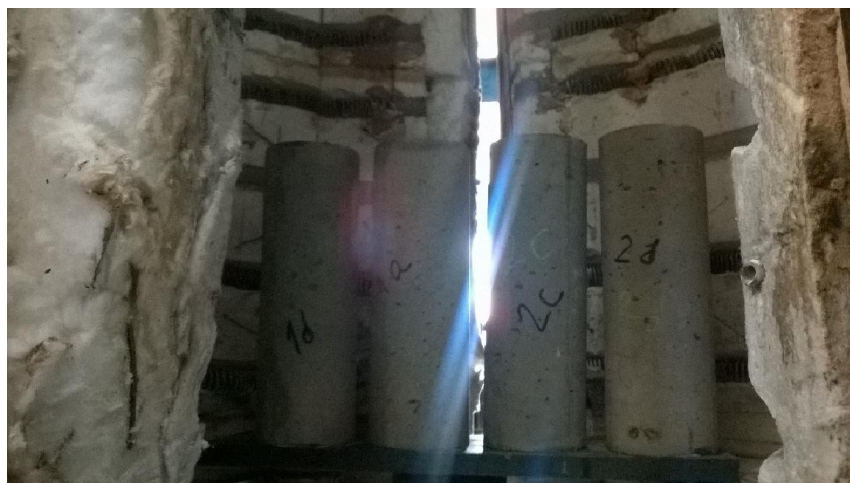
Figura 30 – Posicionamento dos corpos de prova no forno para o aquecimento até 600 °C (Grupo 5).
