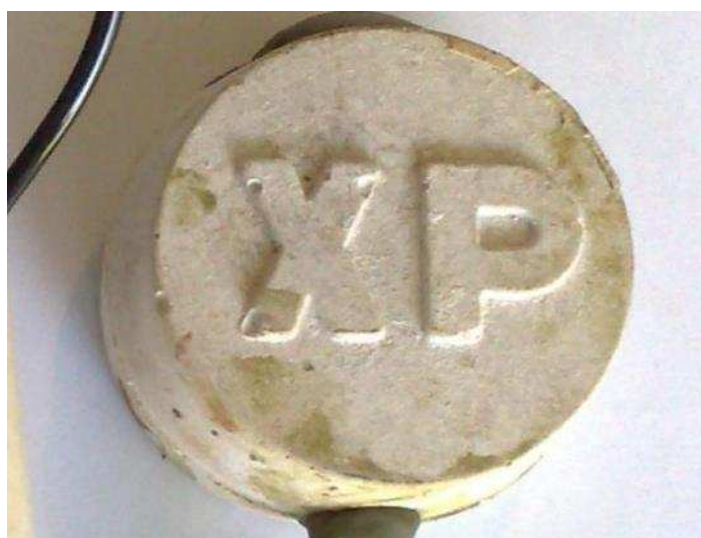
Figura 14 – Detalhe da pastilha utilizada na proteção catódica (VECTOR, 2014).
