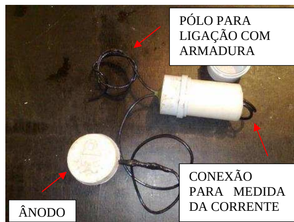
Figura 21 – Detalhe do dispositivo para leitura da corrente (MATTOS et al. , 2010).
