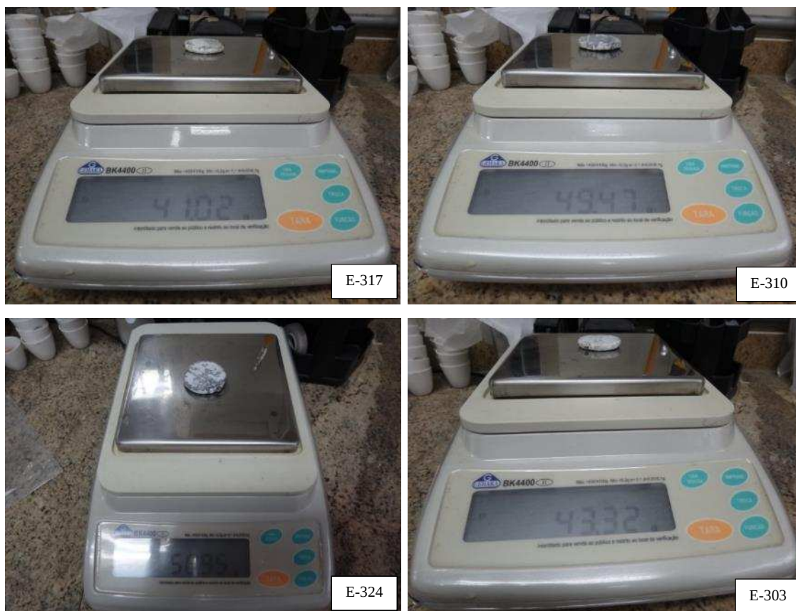
Figura 27 – Vista geral dos ânodos sendo aferidos através de pesagem (Acervo pessoal, 2014).
