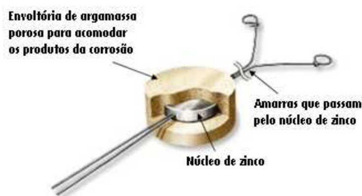
Figura 4 - Detalhe de um ânodo de sacrifício de zinco. (SERGI e PAGE, 1999)
