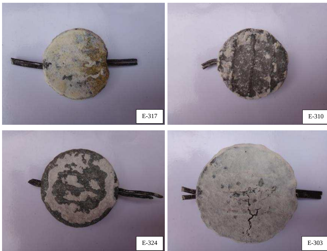
Figura 37 – Detalhe dos ânodos removidos nas estacas (Acervo pessoal, 2014).
