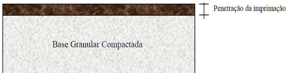
Figura 3 – Penetração da imprimação
