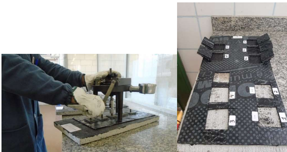
Figura 19: execução dos testes de aderência e placa já testada.
