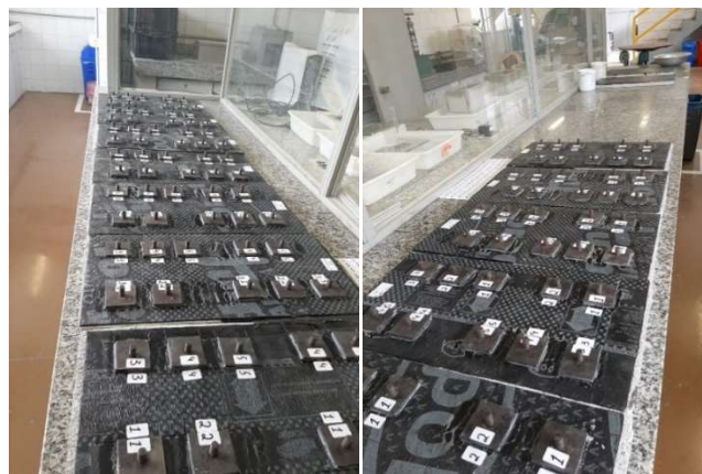
Figura 17: Pastilhas coladas com epóxi
