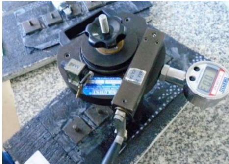
Figura 18: Aparelho Aderímetro da Solotest.
