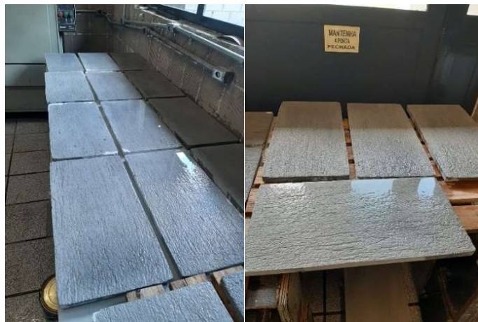
Figura 11 Placas padrões regularizadas encharcadas.
