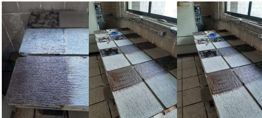
Figura 15: Aplicação de Primer nas placas padrões regularizados
