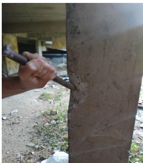
Figura 25 – Fotos ensaio de carbonatação nº 02 – Abertura da quina para se chegar à parte interna do elemento. Fonte: Autores
