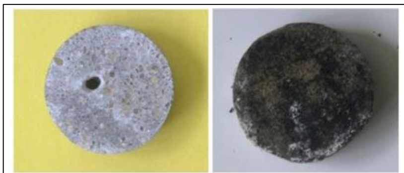
Figura 7 - Fotos comparativas entre amostra de concreto referência e amostra de concreto exposta por um ano em uma câmara de umidade, apresentando crescimento de fungos tipo Fusarium , como biofilme preto. Fonte: GEORGE, 2013, p. 10.
