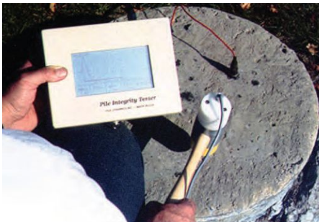
Figura 7 - Ensaio de Integridade e Equipamento PIT (Hussein e Likins, 2005)
