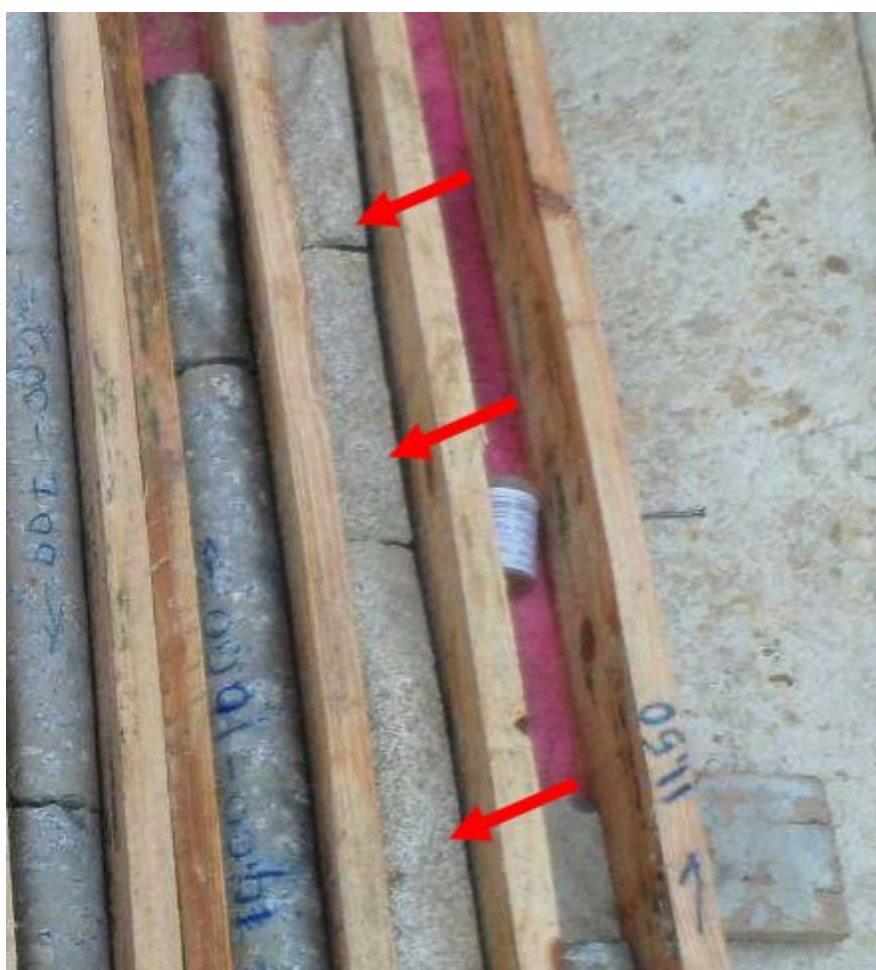
Figura 17 - Trechos com Vazios Laterais da Estaca P-80
