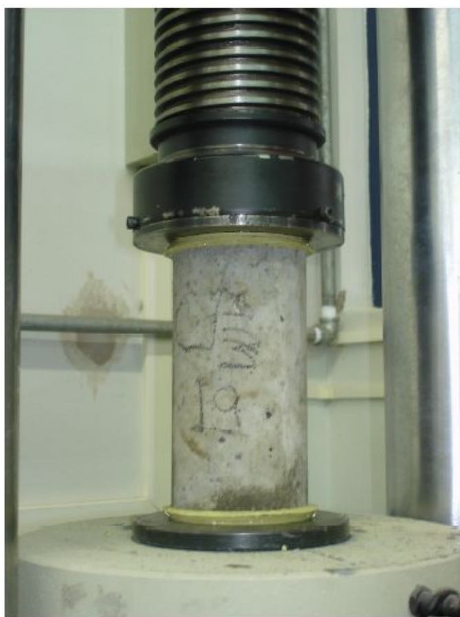
Figura 10 - Corpo de Prova Cilíndrico em Ensaio para Determinação da Resistência à Compressão do Concreto (Notas de aula Fundamentos do Concreto Armado – Prof Dr Paulo Sergio do Santos Bastos UNESP, 2011)
