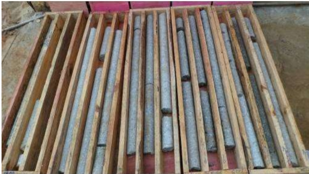
Figura 12 - Testemunhos de Concreto - Estaca P41 - Utilização de Lama Bentonítica como Fluido Estabilizante
