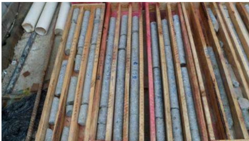
Figura 13 - Testemunhos de Concreto - Estaca P60 - Utilização de Lama Polimérica como Fluido Estabilizante
