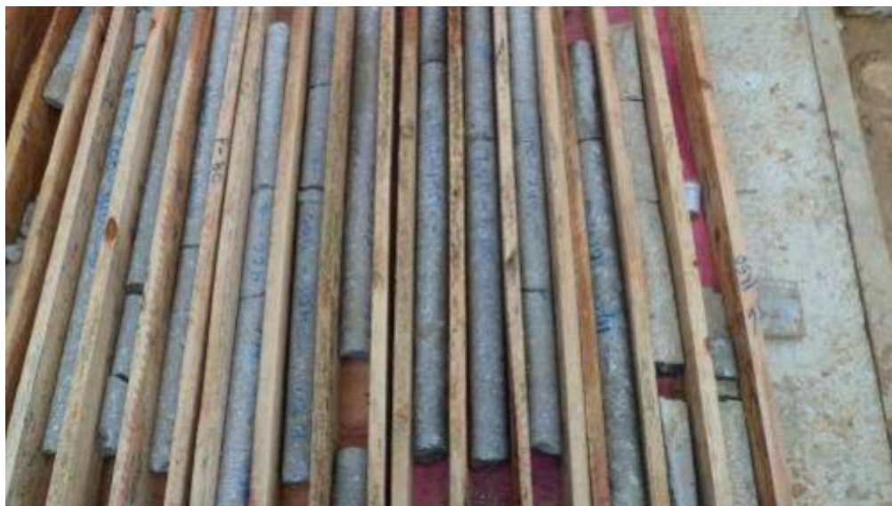
Figura 14 - Testemunhos de Concreto - Estaca P80 - Utilização de Lama Polimérica como Fluido Estabilizante
