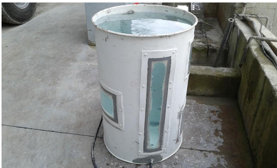
Figura 12 - Teste de estanqueidade do tambor com água.
