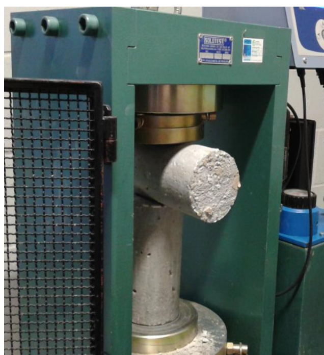
Figura 20 – Rompimento dos corpos de provas na prensa.
