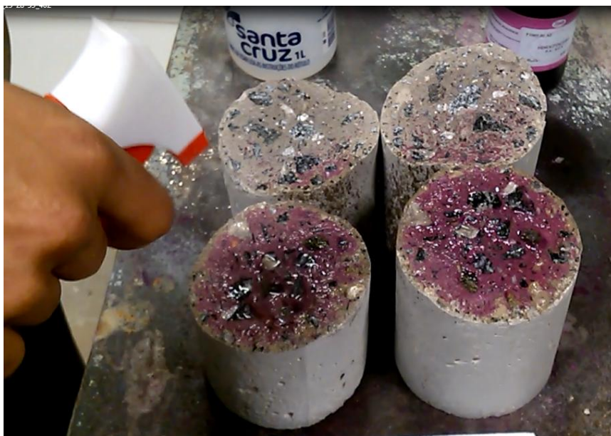
Figura 21 – Partes recém fraturadas aspergidas com solução de fenolftaleína.
