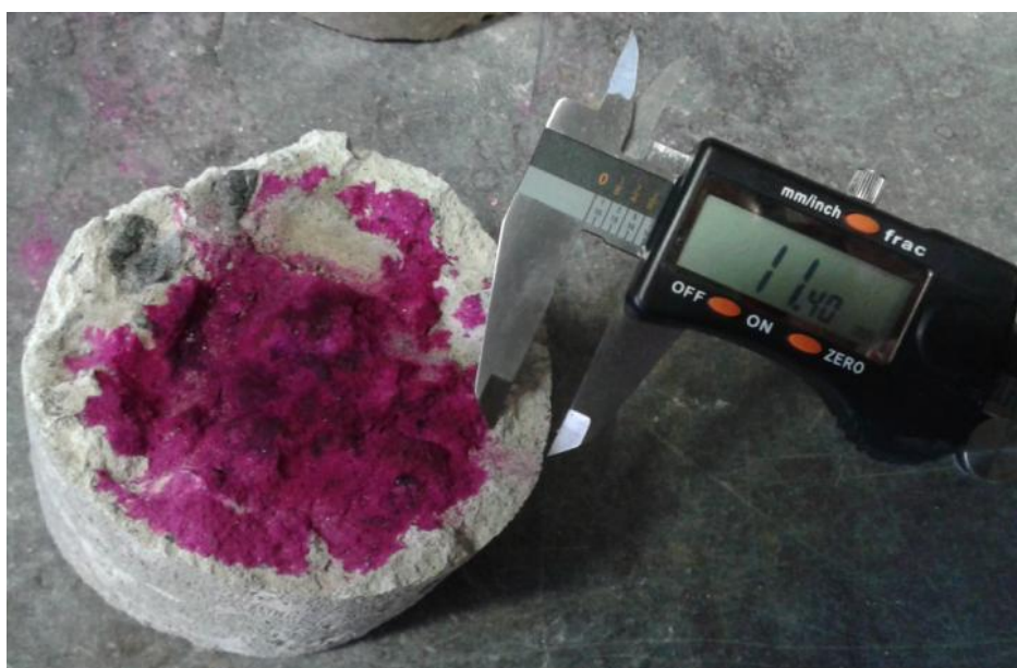
Figura 22 – Medida da frente de carbonatação.
