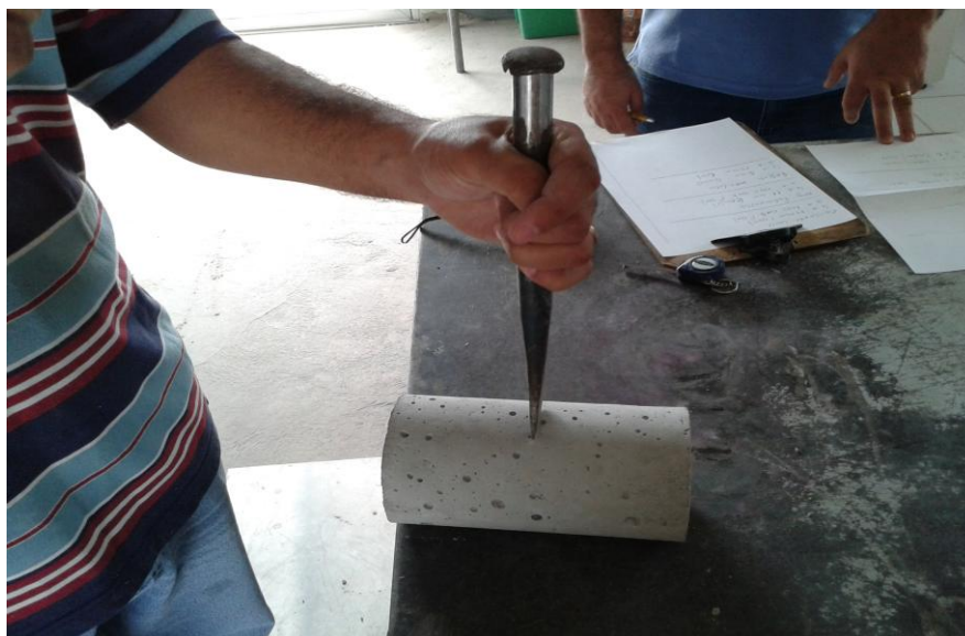
Figura 19 – Rompimento superficial manual com ponteiro metálico no centro dos corpos de prova.
