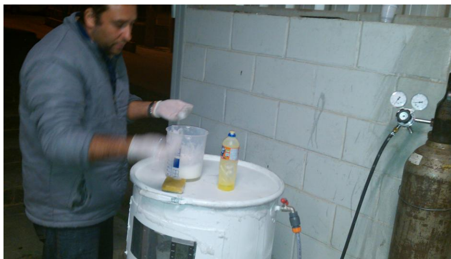
Figura 13 - Testes de estanqueidade do tambor e da tampa da câmara de carbonatação.
