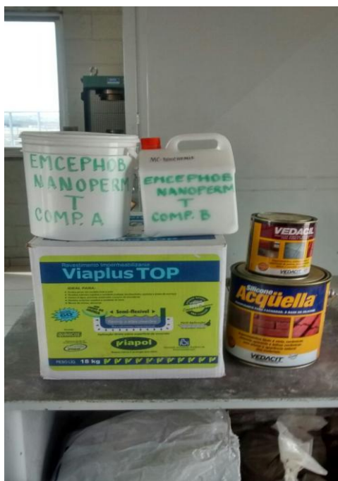
Figura 02 - Produtos de proteção superficial empregados nos corpos de prova.
