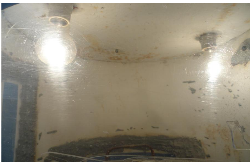
Figura 18 - Instalação de 2 (duas) lâmpadas incandescentes no interior da câmara.
