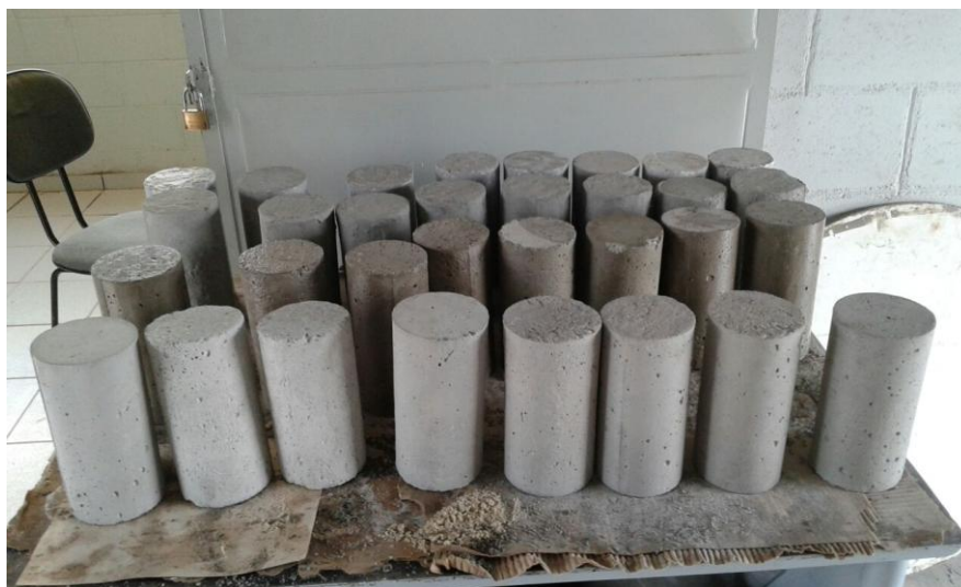
Figura 08 - Corpos de prova com produtos de proteção aplicados.
