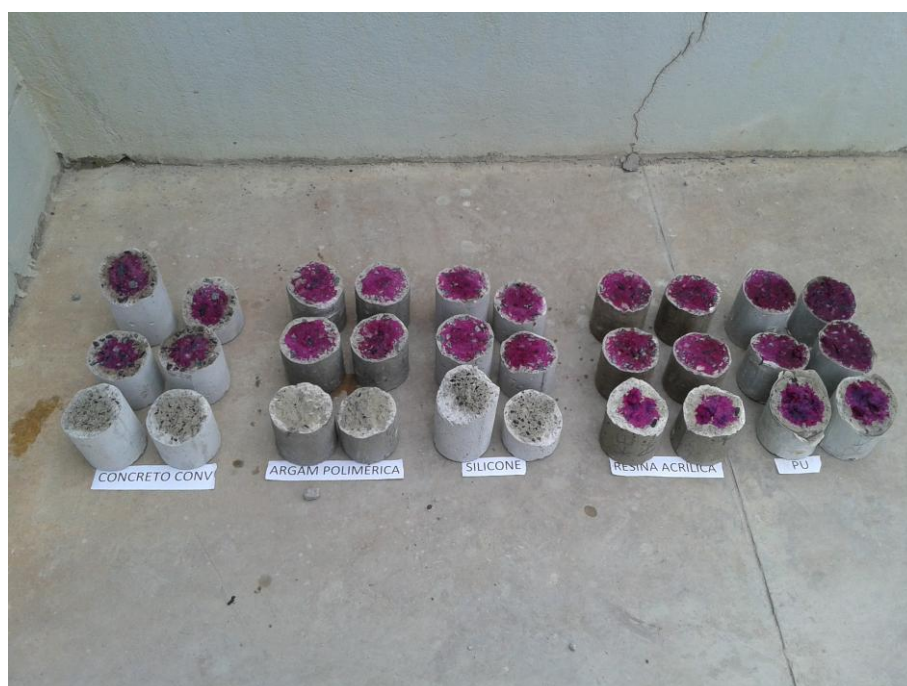
Figura 27 - Corpos de prova rompidos aos 28 dias, demonstrando as áreas carbonatadas, após aplicação de solução com fenolftaleína.
