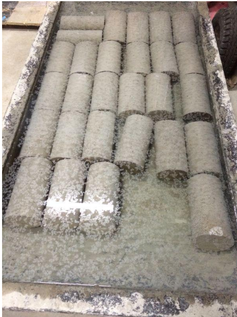
Foto 10 – Início do processo de cura úmida dos CP's
