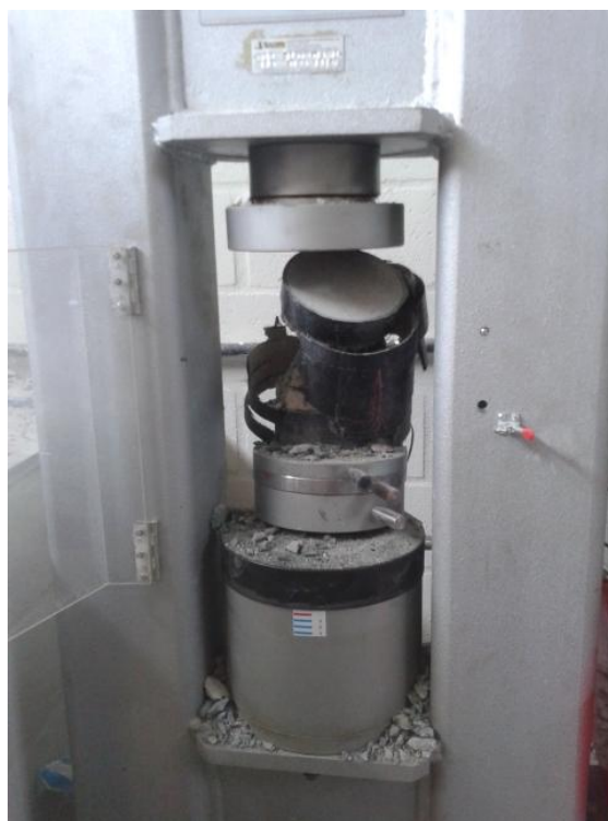
Foto 27 – Rompimento de um CP com 4 camada de reforço de fibra de carbono
