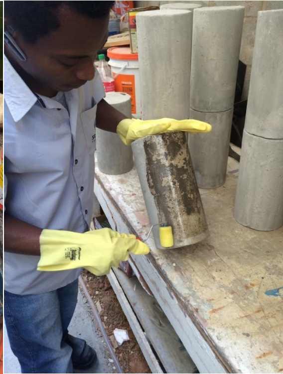
Foto 12 – Aplicação do primer
