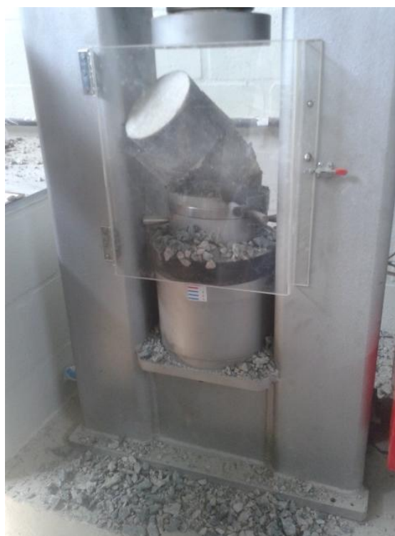
Foto 26 – Rompimento de um CP com 3 camada de reforço de fibra de carbono
