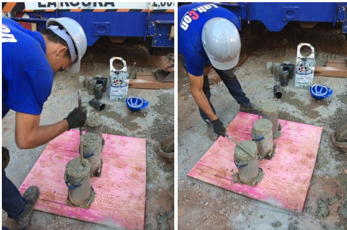
Fotos 7 e 8 – Moldagem dos CP's
