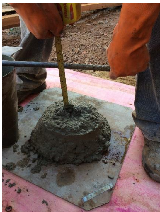
Fotos 3, 4, 5 e 6 – Determinação do abatimento do concreto através do Slump Test
