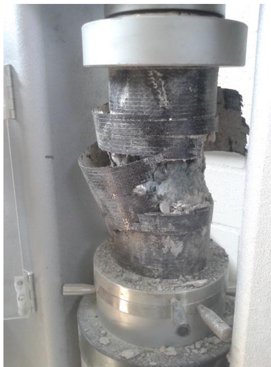
Foto 25 – Rompimento de um CP com 2 camada de reforço de fibra de carbono
