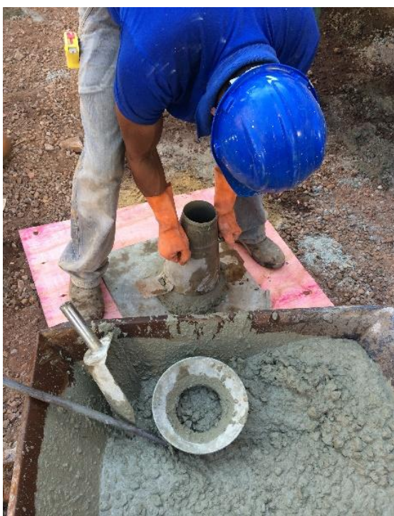
Fotos 3, 4, 5 e 6 – Determinação do abatimento do concreto através do Slump Test
