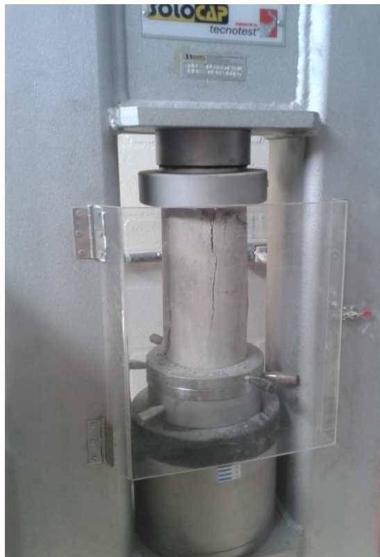
Foto 23 – Início do rompimento do CP
