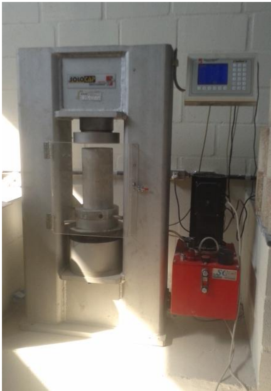
Foto 22 – CP antes do início rompimento
