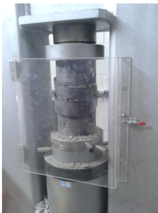
Foto 24 – Rompimento de um CP com 1 camada de reforço de fibra de carbono
