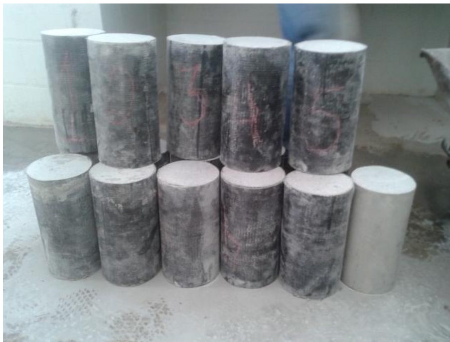
Foto 20 – CP's confinados com fibra de carbono e retificados
