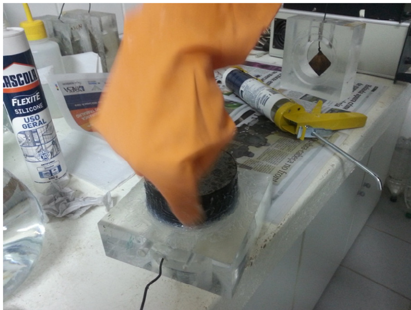
Figura 32. Processo de acabamento da fixação e vedação de amostras.
