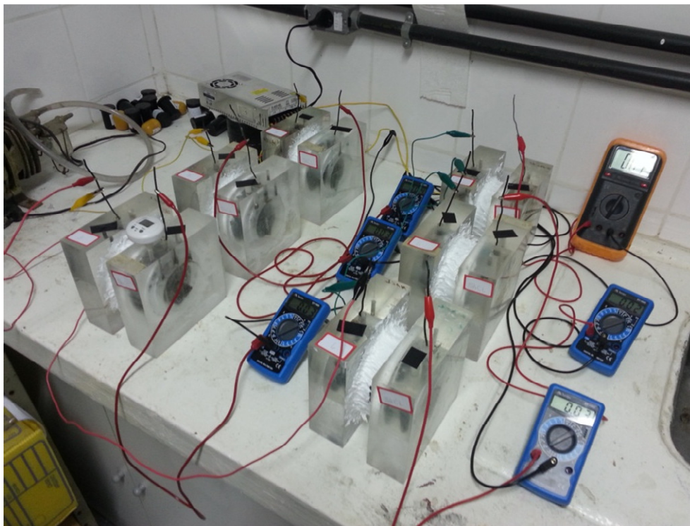
Figura 38. Execução de ensaio de penetração acelerada, vista lateral.
