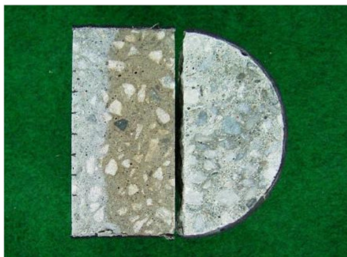
Figura 16. Amostras após aspersão de nitrato de prata (Pelcon Materials Testing ApS).
