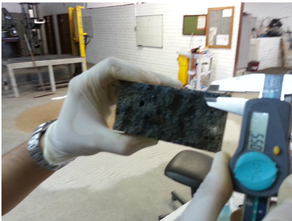
Figura 46. Medição em amostra com paquímetro após aspersão de nitrato de prata.
