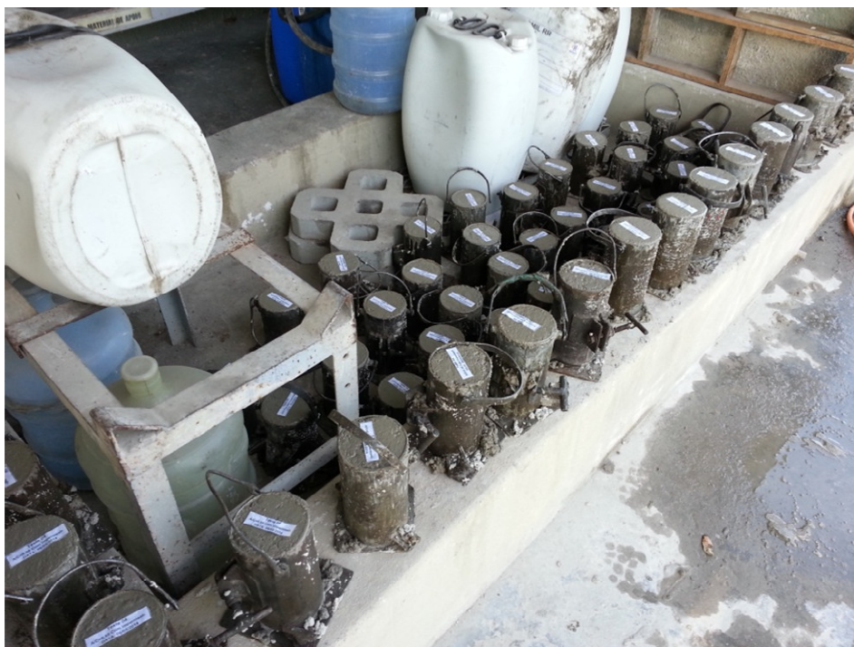
Figura 24. Conclusão de moldagem de corpos de prova.
