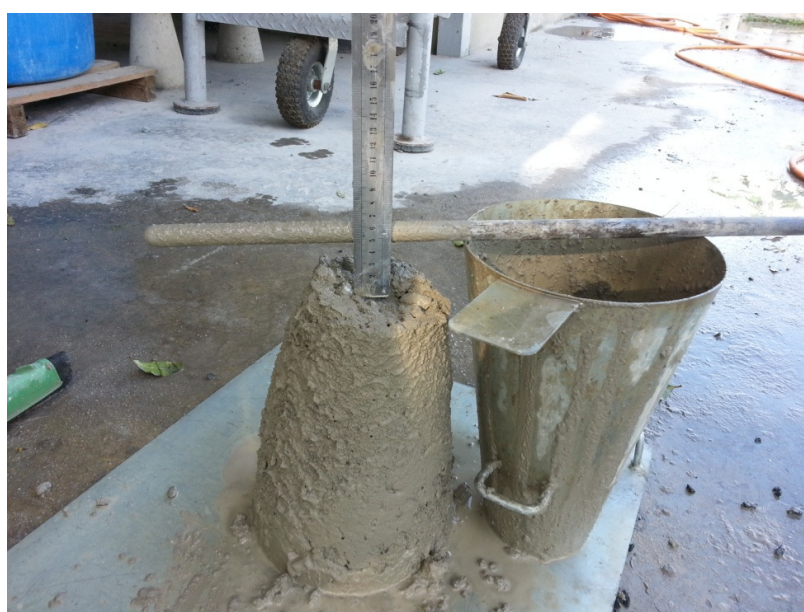
Figura 23. Teste de abatimento de tronco de cone.
