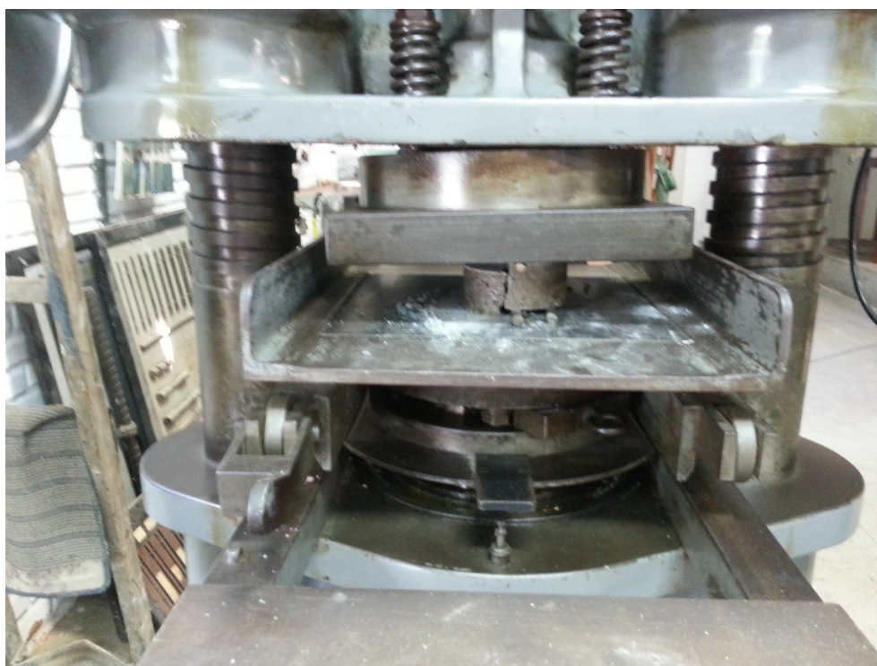
Figura 41. Momento do rompimento das amostras.
