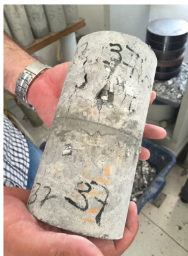
Figura 32- Aspecto de ruptura ELC
