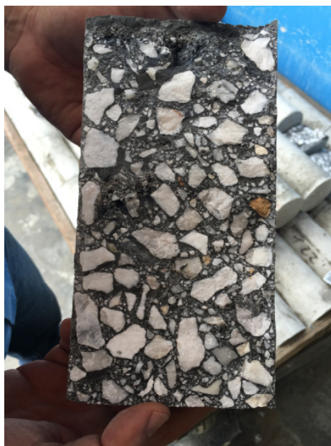
Figura 29- Aspecto de ruptura REFT
