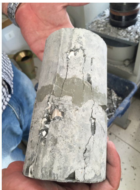
Figura 30- Aspecto de ruptura ERT
