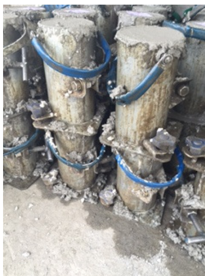
Figura 14- Moldes metálicos para concreto
