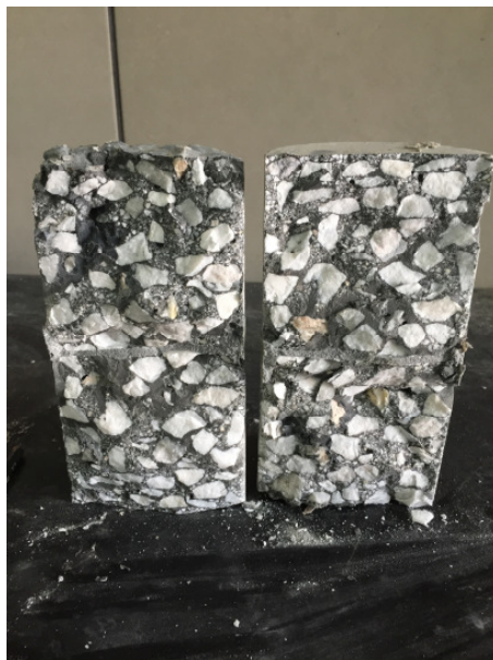
Figura 26- Aspecto de ruptura ERT
