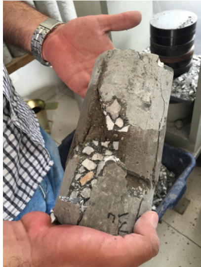
Figura 31- Aspecto de ruptura CRC
