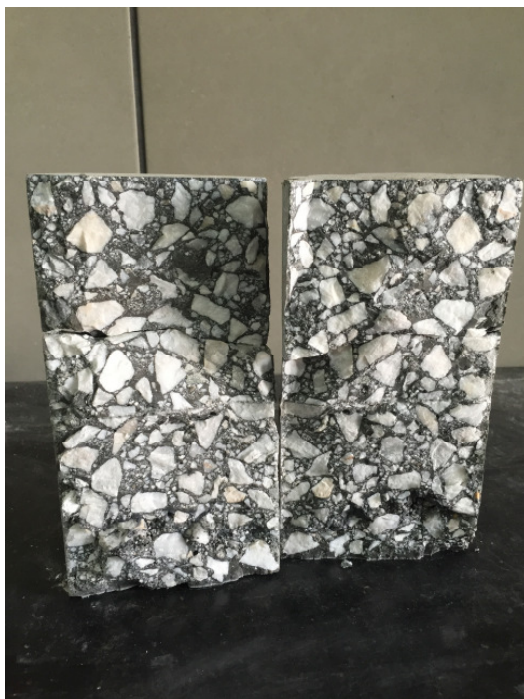
Figura 25- Aspecto de ruptura ELT
