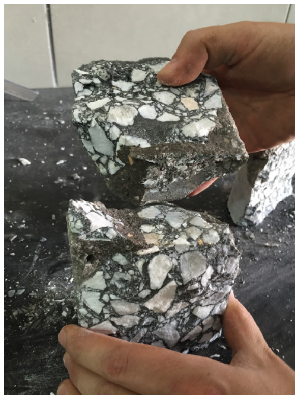
Figura 28- Aspecto de ruptura CRT
