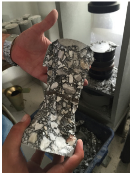
Figura 33- Aspecto de ruptura CLC
