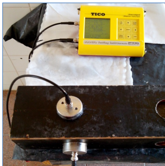
Foto 6 – Ensaio de VPU semidireta.
