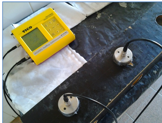
Foto 7 – Ensaio de VPU indireta.
