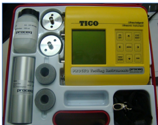
Foto 3 – Equipamento de Ultrassom modelo TICO fabricante PROCEC Testing Instruments.
