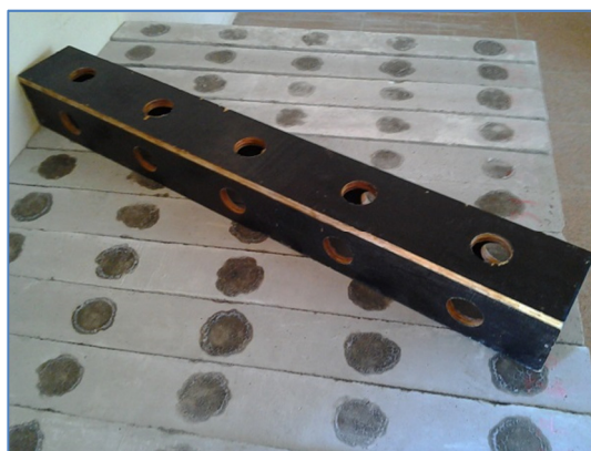
Foto 4 – Gabarito para ensaio de ultrassom.
