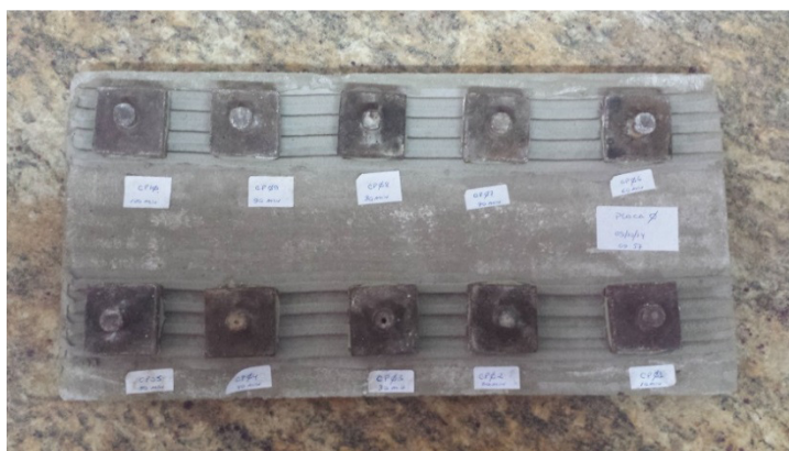
Figura 32. Colagem das pastilhas metálicas sobre as placas cerâmicas.
