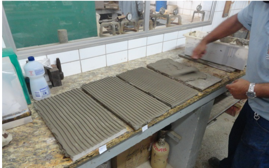
Figura 26. Formação dos cordões no sentido longitudinal do substrato.
