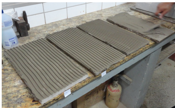
Figura 29. Espalhamento da argamassa colante.
