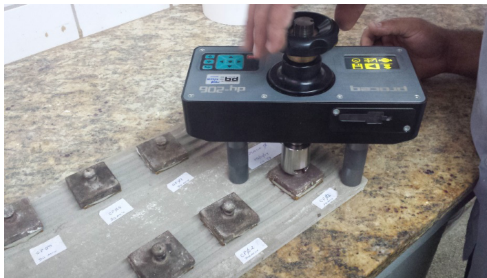
Figura 33. Ensaio de arrancamento das placas cerâmicas.
