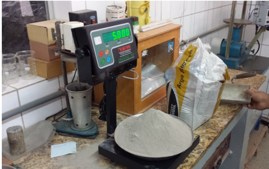
Figura 22. Dosagem da argamassa.
