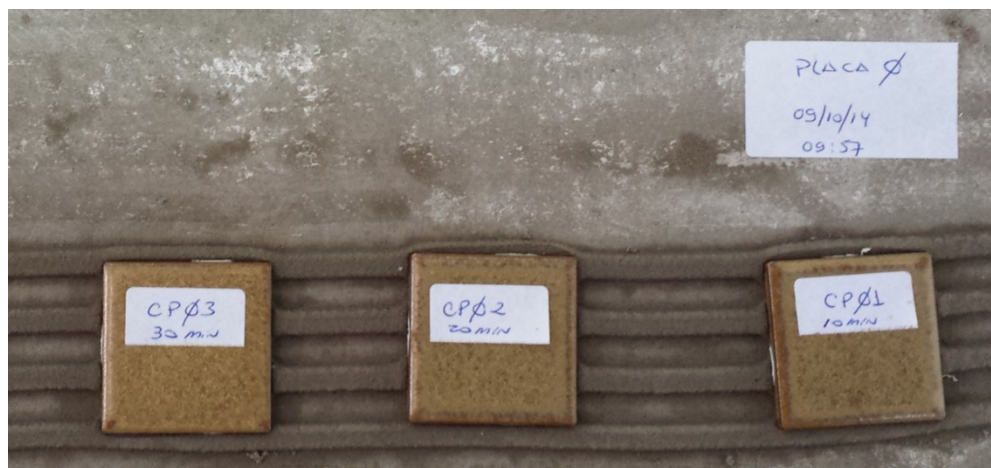
Figura 15. Detalhe da fixação da pastilha cerâmica 45x45mm.
