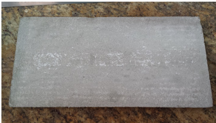
Figura 21. Substrato padrão de concreto normatizado pela ABNT 14081-2.
