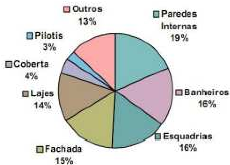
Figura 54– Locais da edificação mais afetados por problemas de infiltração (CORREIA, 1998)
