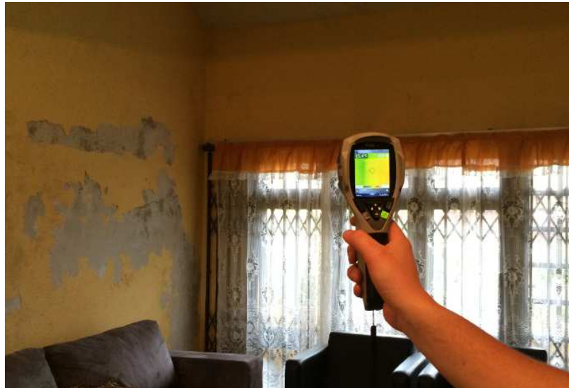
Figura 85– Utilização da câmera térmica para tentar determinar indícios de umidade
