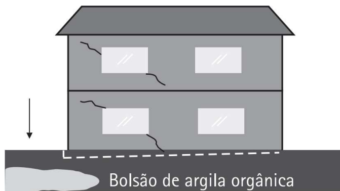
Figura 8 - Recalque devido à falta de homogeneidade no solo Fonte: MILITITSKY et al., 2015
