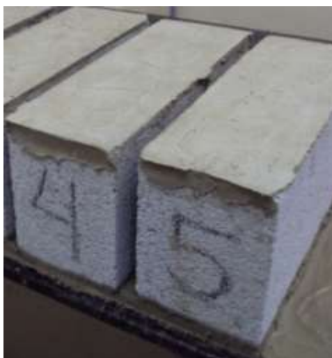
Figura 18. Segunda etapa do capeamento do bloco de concreto.
