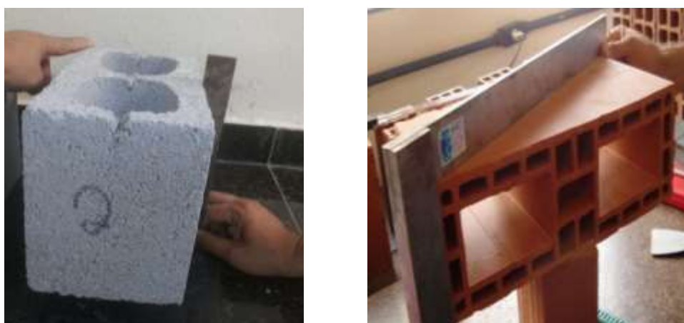
Figura 24. Medição de planeza e desvio em relação ao esquadro.
