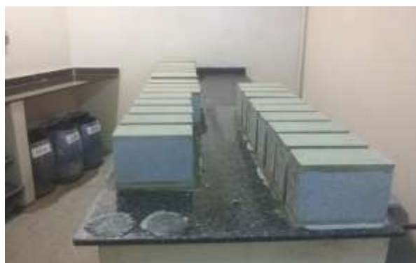
Figura 16. Bancada utilizada no capeamento dos cerâmicos e de concreto.
