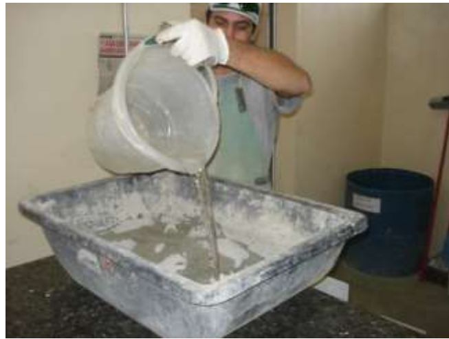
Preparação da argamassa para moldagem dos prismas
