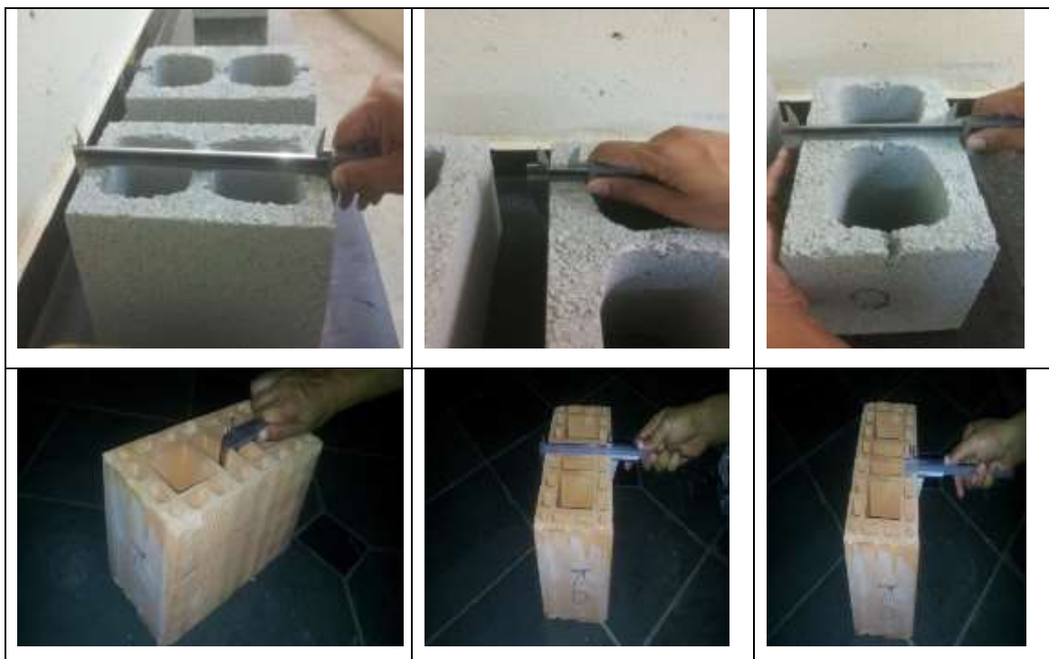
Figura 23. Medição das características geométricas dos blocos.
