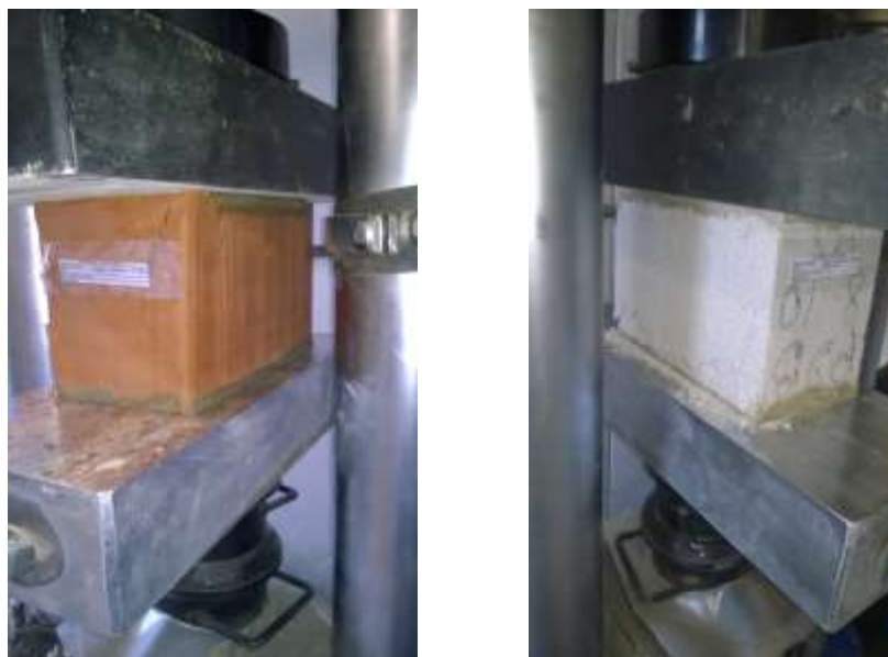
Figura 28. Ensaio de resistência à compressão de bloco cerâmico e de concreto.
