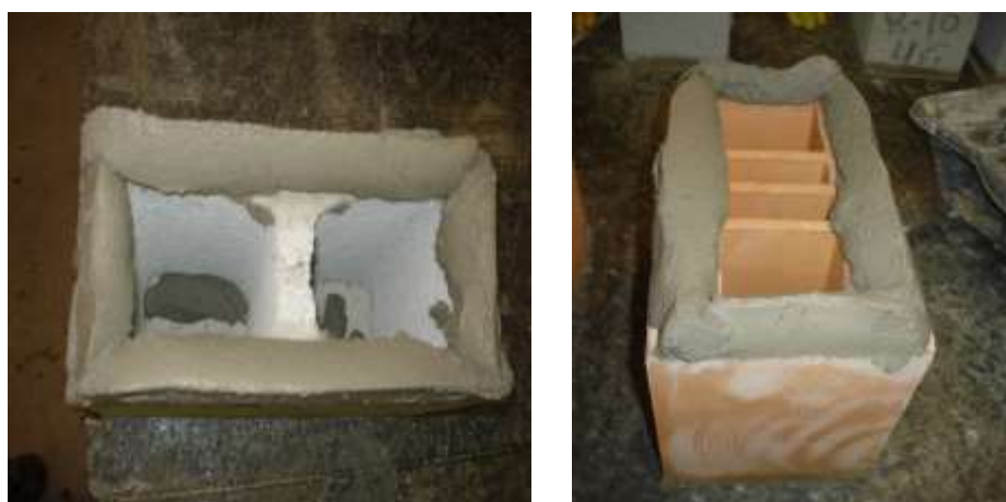
Figura 20. Paredes longitudinais e transversais externas argamassadas.
