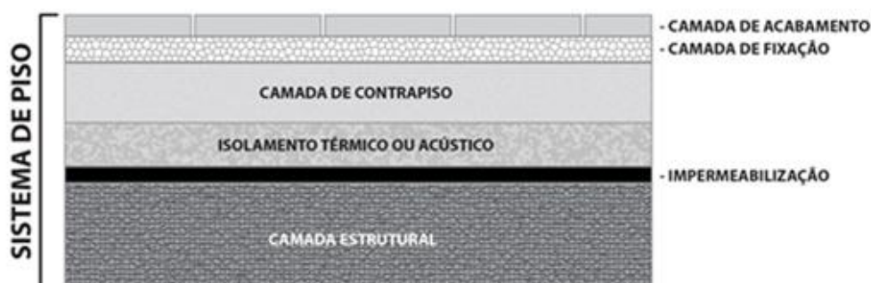
Figura 7 - Exemplo genérico de um sistema de pisos e seus elementos
