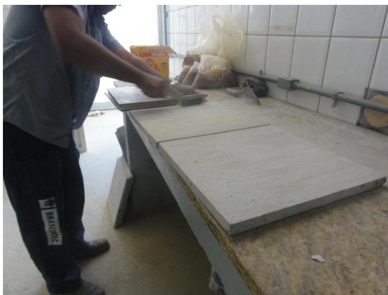
Figura 37 – Preparação do substrato padrão utilizado: placas de Granilite com resistência de 2,00 Mpa.
