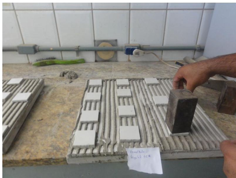
Figura 40 – Assentamento das pastilhas cerâmicas sobre piso de referência.
