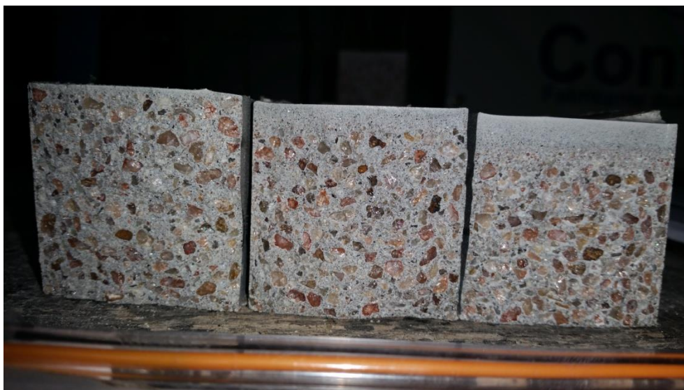
Foto 15-Diferença na exsudação dos corpos de prova.
