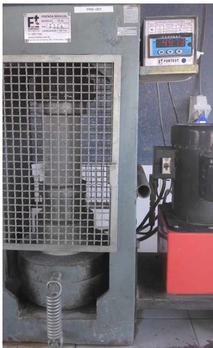
Foto 8-Procedimento de ruptura dos corpos de prova.
