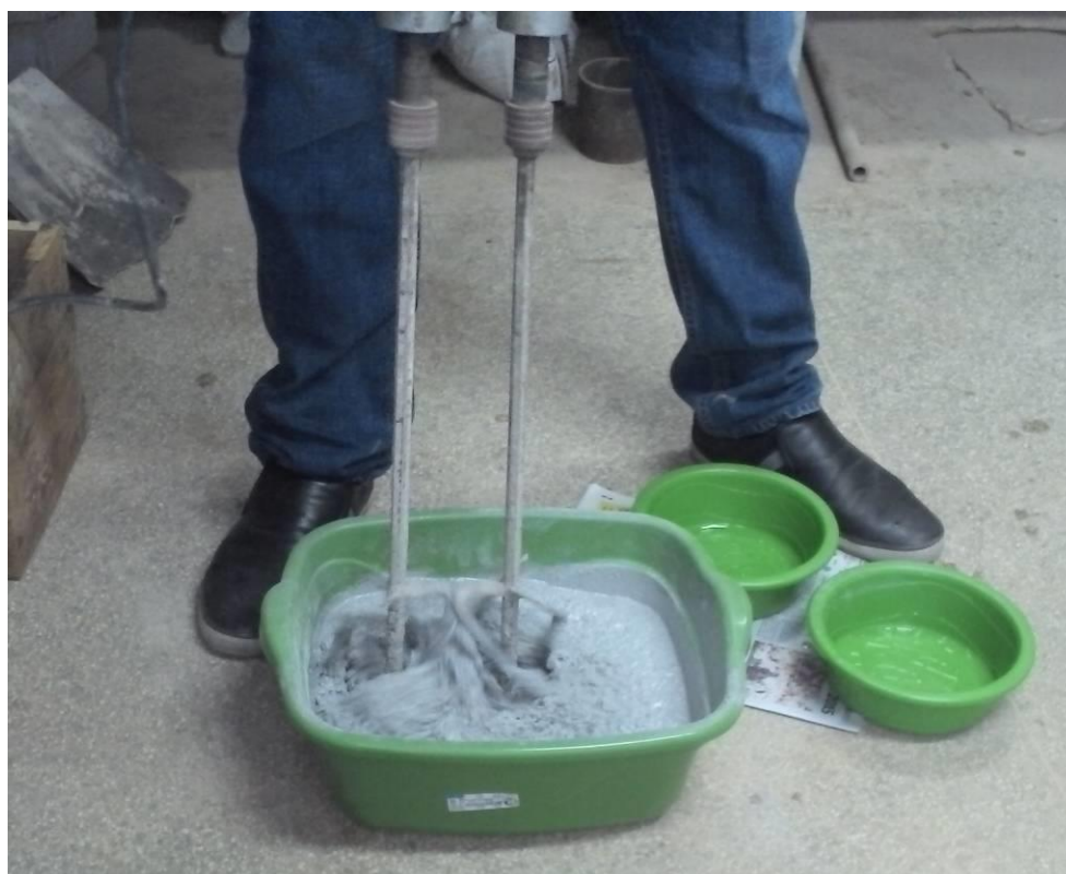
Foto 12-Procedimento de mistura dos componentes do graute.
