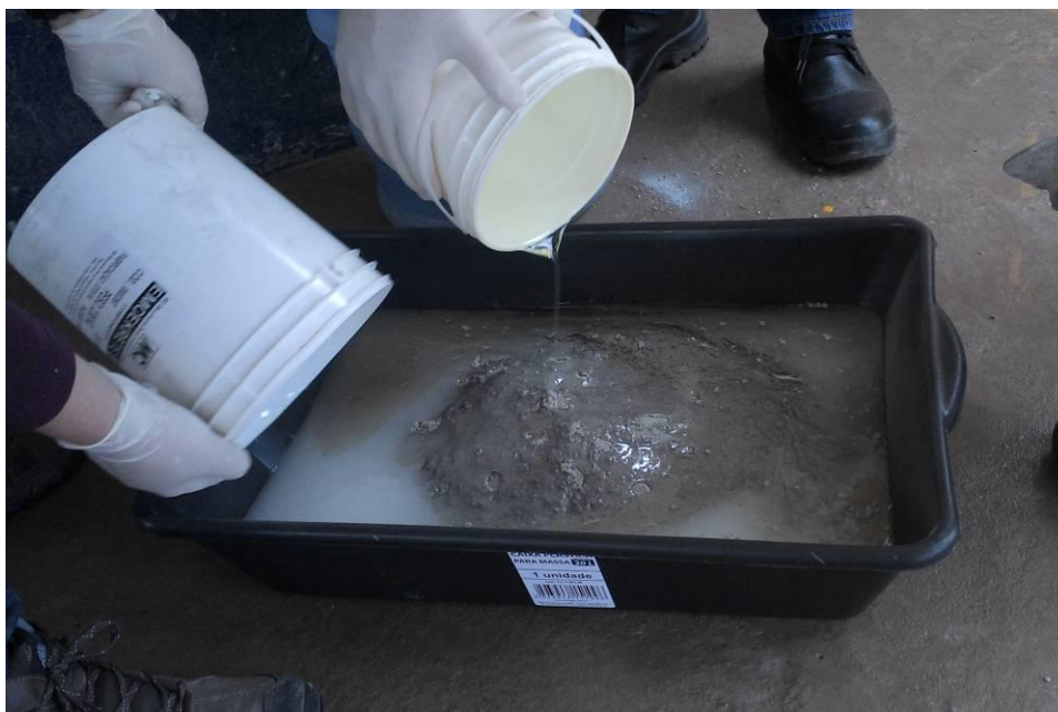
Foto 6- Procedimento de mistura dos componentes do graute.
