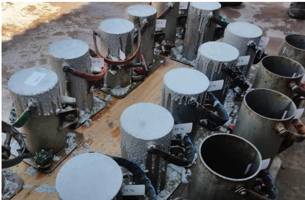
Foto 7-Procedimento de moldagem dos corpos de prova.
