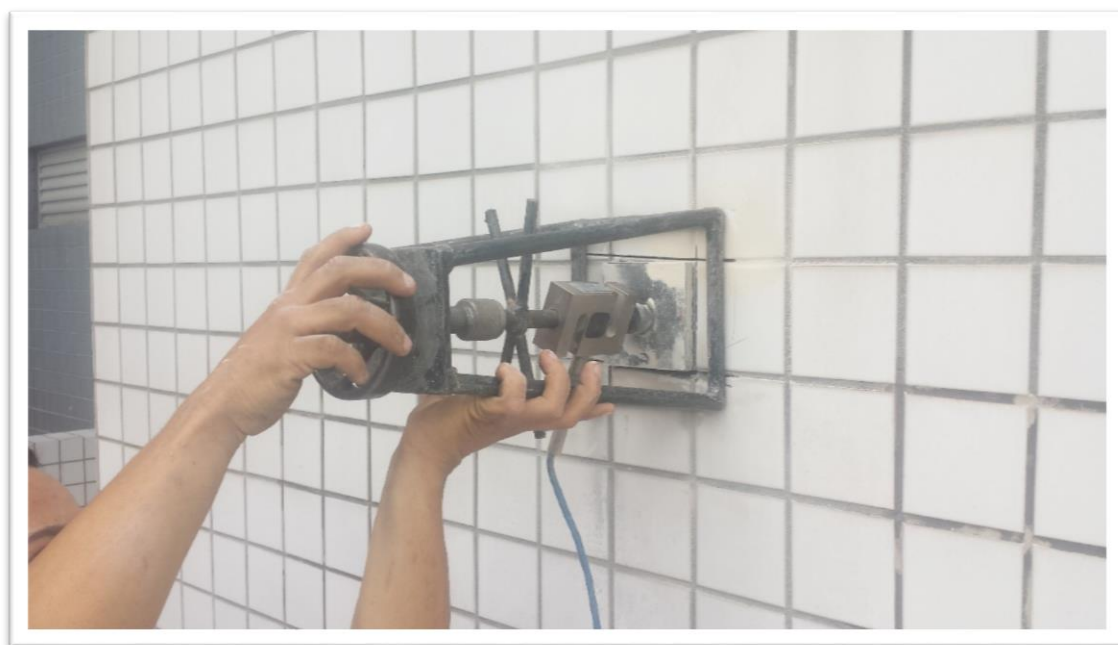
Figura 8 - Célula de carga e "volante" de tração
