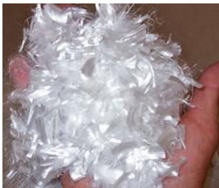
Figura 5 – Microfibras de polipropileno Fonte: www.google.com/images
