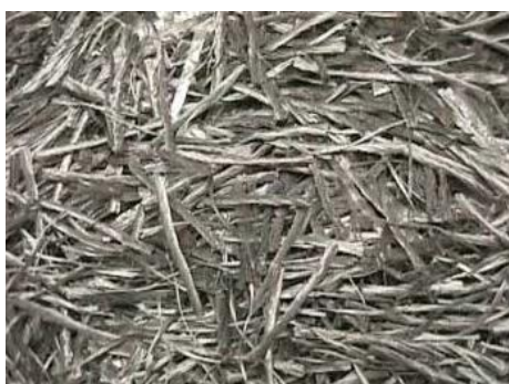
Figura 7 – Macrofibras de polipropileno Fonte: www.google.com/images
