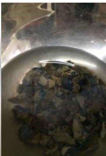
Figura 65 – Amostra de concreto reduzida Fonte: Laudo pericial
