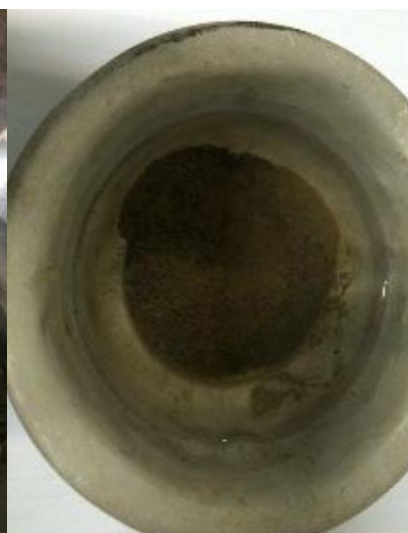
Figura 66 – Amostra de concreto coletada moída em frações mínimas Fonte: Laudo pericial
