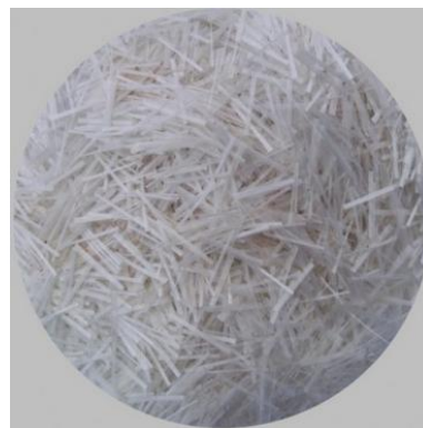
Figura 6 – Microfibras de vidro Fonte: www.google.com/images
