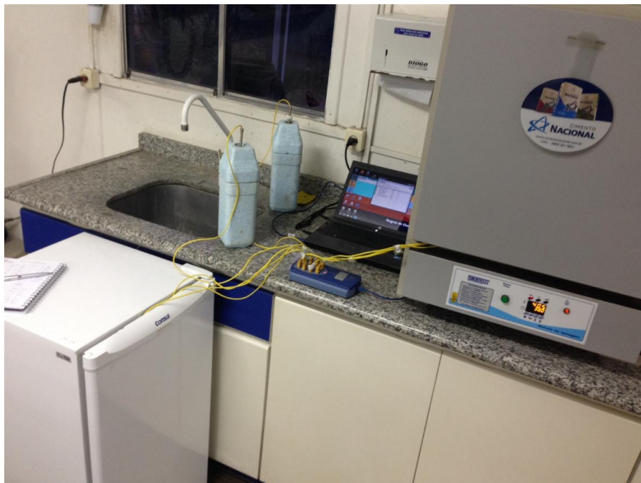
Disposição dos aparelhos medidores em ambiente normal, geladeira e estufa Fonte: Acervo do grupo
