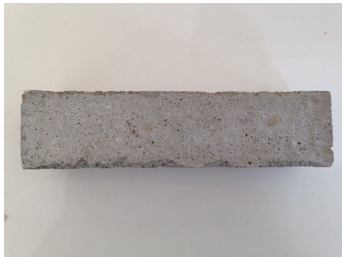
Foto 5 – Corpo de Prova Prismático moldado
