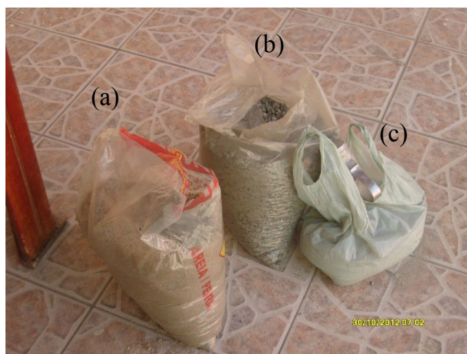
Foto 1 – Materiais utilizados – (a) Areia Grossa; (b) Pedrisco; (c) Cimento
