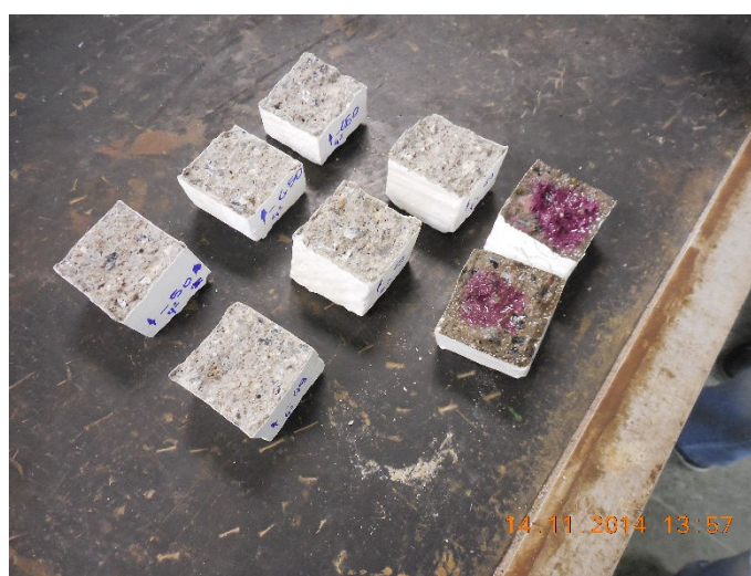
Foto 13 – Fatias dos corpos de prova durante a aplicação da solução de Fenolftaleína
