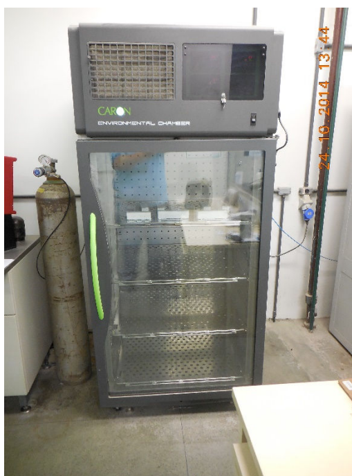
Foto 8 – Câmara para ensaio acelerado de carbonatação
