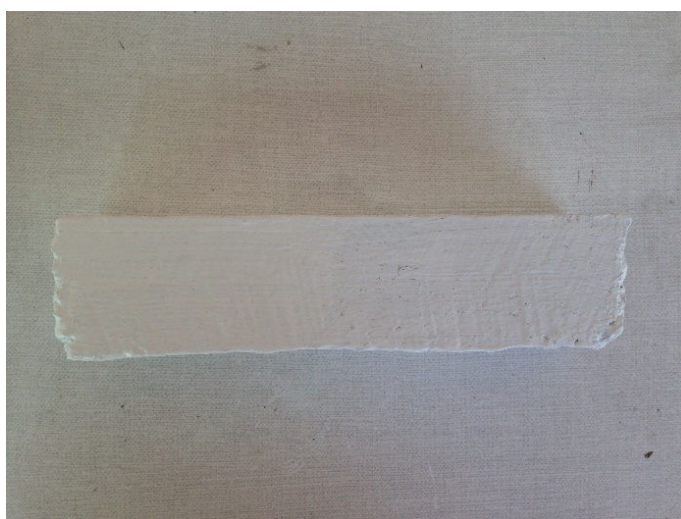
Foto 7 – Pintura dos Corpos de Prova Prismáticos – 2ª demão
