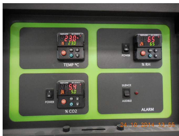
Foto 9 – Parâmetros da câmara de carbonatação
