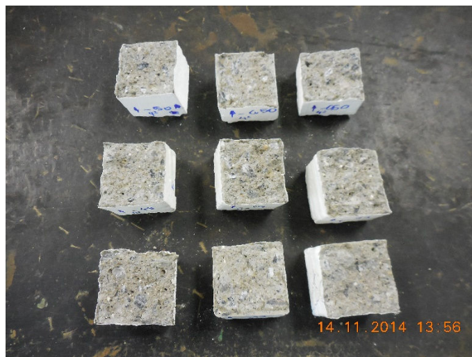
Foto 12 – Fatias dos corpos de prova antes da aplicação da solução de Fenolftaleína
