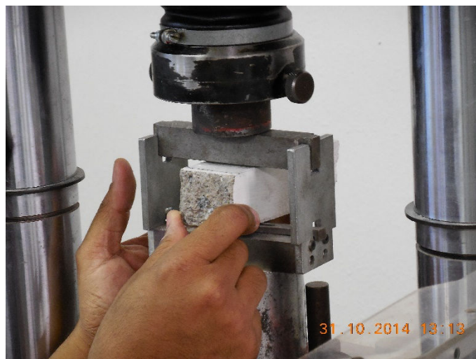
Foto 11 – Corpos de Prova Prismáticos sendo cortados para o ensaio
