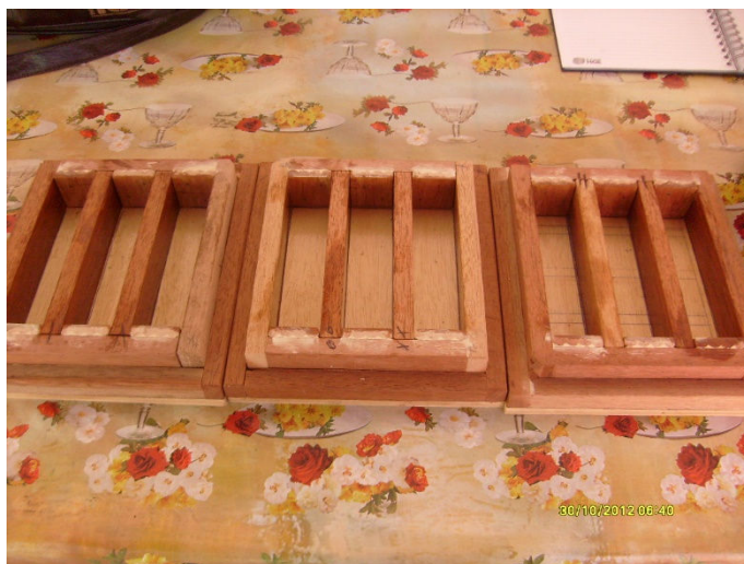
Foto 2 – Formas de madeira para os Corpos de Prova Prismáticos
