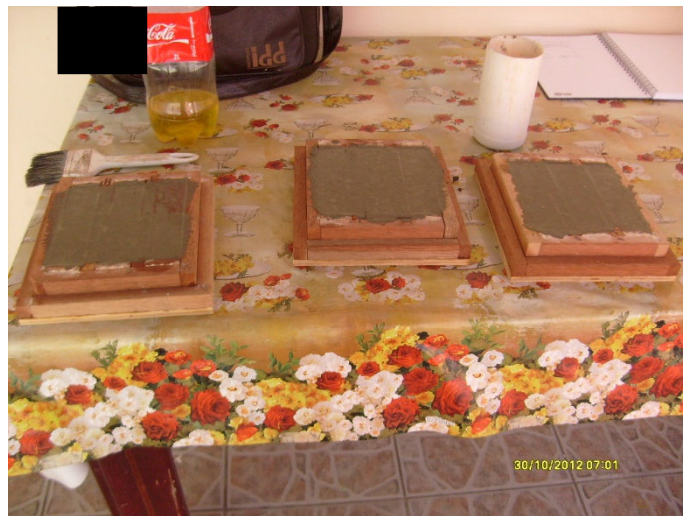
Foto 4 – Corpos de Prova moldados Prismáticos
