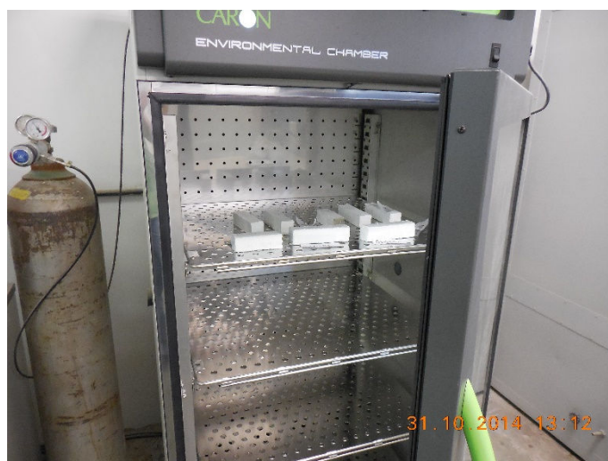
Foto 10 – Corpos de Prova Prismáticos dentro da Câmara para ensaio
