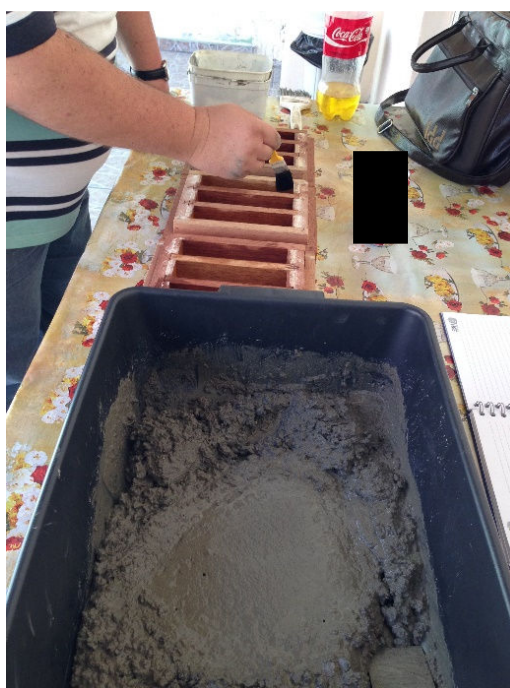
Foto 3 – Moldagem dos Corpos de Prova Prismáticos
