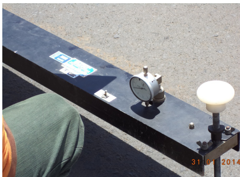
Figura 30– Viga Benkelman. (PMPU, 2014)
