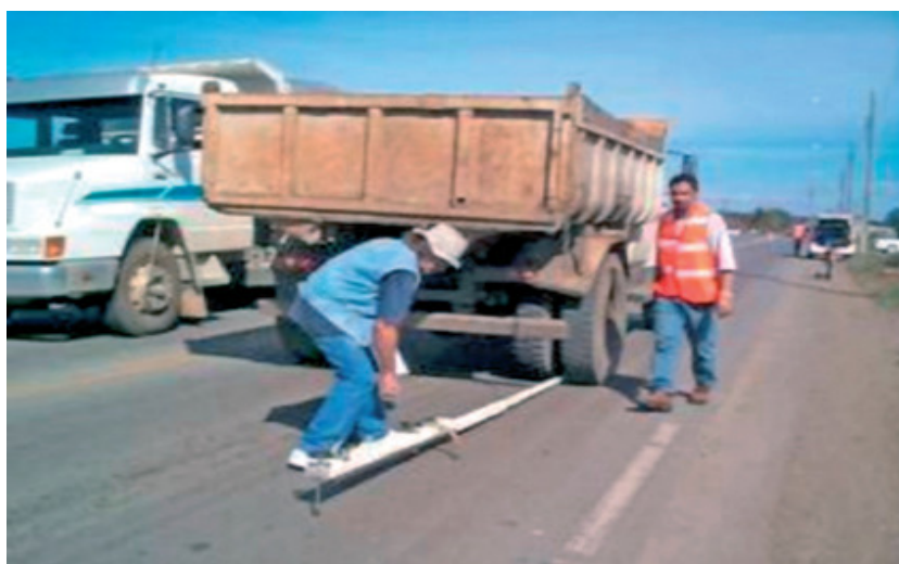
Figura 13 – Posicionamento de Viga Benkelman (BERNUCCI, et al , 2010)
