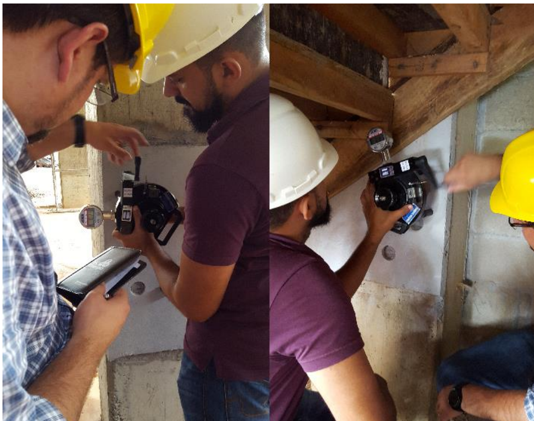
Fig. 08 – Teste de arrancamento
