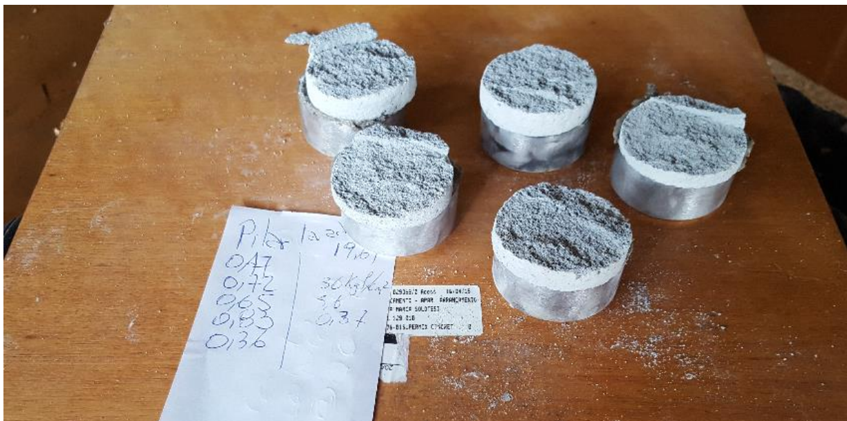
E a figura 10, resultado do rompimento dos corpos de prova do concreto com tratamento prévio de lixamento e lavagem, o qual teve um corpo de prova perdido por problemas durante a perfuração do emboço e rompimentos que tiveram pouca influência da interface chapisco / emboço.
