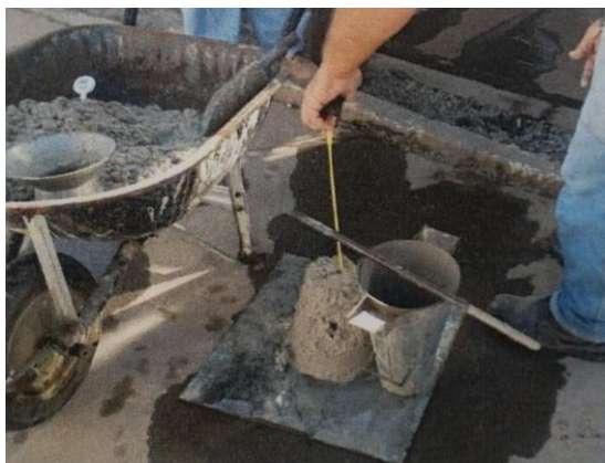
Figura 2 - Ensaio de abatimento do tronco de cone de Abrams (SLUMP)
