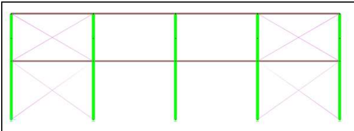
Figura 11 – Vista lateral da estrutura - Contraventamento em “x”
