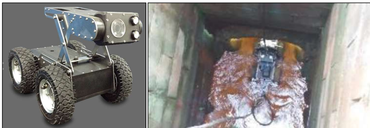
Figura 11 – Ilustração do robô utilizado da inspeção e posicionamento a partir do poço de visita
