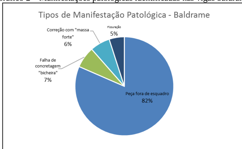
Gráfico 2 – Manifestações patológicas identificadas nas vigas baldrame.
