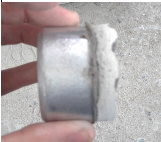
Figura 48 – Corpo de prova - nº 10 - Placa de concreto - Fck 70 MPa
