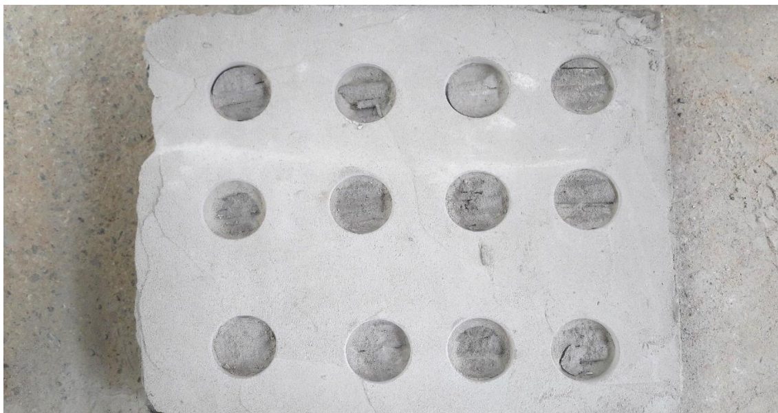
Figura 50 – Corpo de prova - Fck 70 MPa - Após a realização do ensaio de arrancamento.
