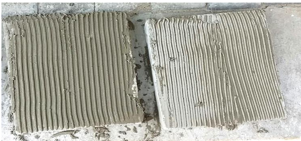
Figura 24 – Chapisco aplicado nas placas de 30 e 80 MPa, respectivamente.
