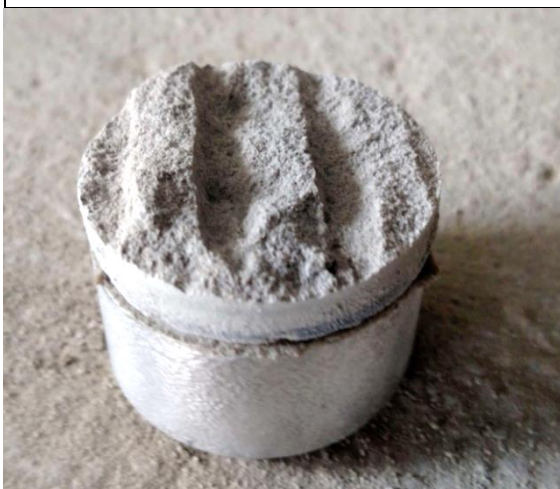
Figura 45 – Corpo de prova - nº 07 - Placa de concreto - Fck 60 MPa
