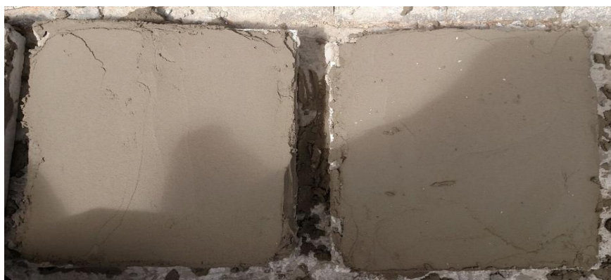
Figura 28 – Argamassa aplicada nas placas de 90 e 70 MPa respectivamente.
