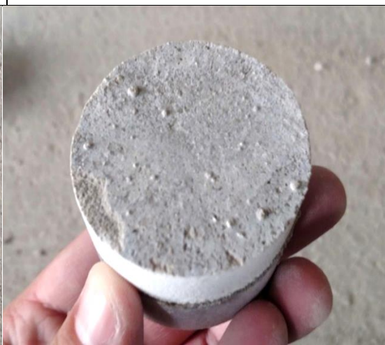
Figura 43 – Corpo de prova - nº 08 - Placa de concreto - Fck 50 MPa
