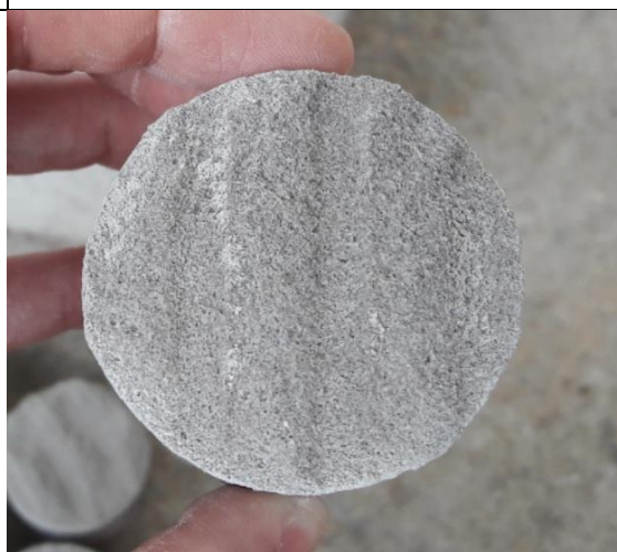
Figura 52 – Corpo de prova - nº10 - Placa de concreto - Fck 80 MPa
