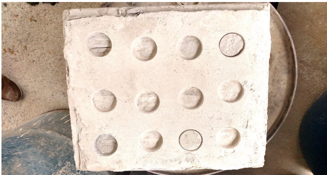
Figura 44 – Corpo de prova - Fck 50 MPa - Após a realização do ensaio de arrancamento.
