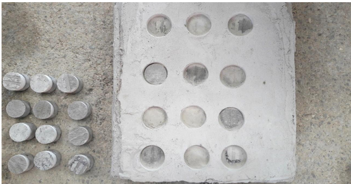
Figura 41 – Corpo de prova - Fck 40 MPa - Após a realização do ensaio de arrancamento.
