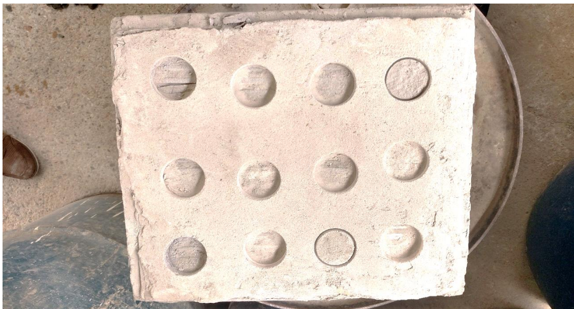
Figura 47 – Corpo de prova - Fck 60 MPa - Após a realização do ensaio de arrancamento.
