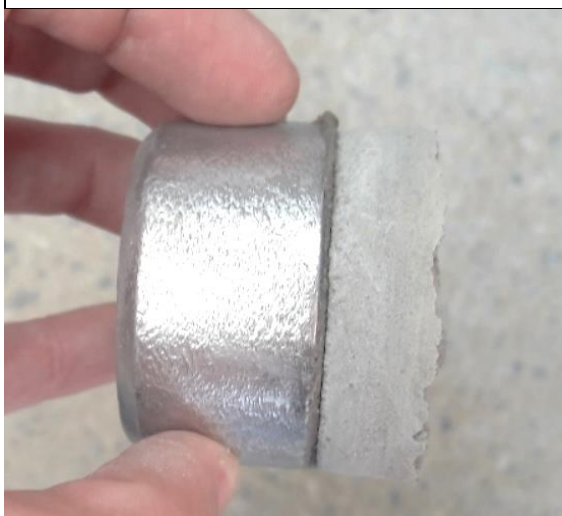
Figura 54 – Corpo de prova - nº 10 - Placa de concreto - Fck 90 MPa
