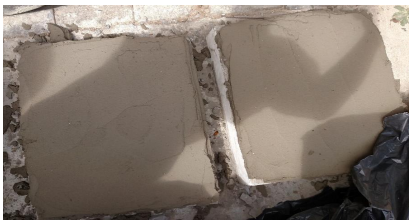
Figura 29 – Argamassa aplicada nas placas de 30 e 80 MPa respectivamente.
