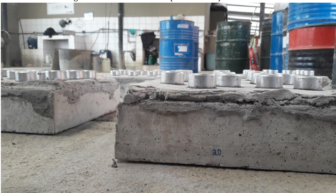
Figura 31 – Pastilhas coladas para a realização dos ensaios.
