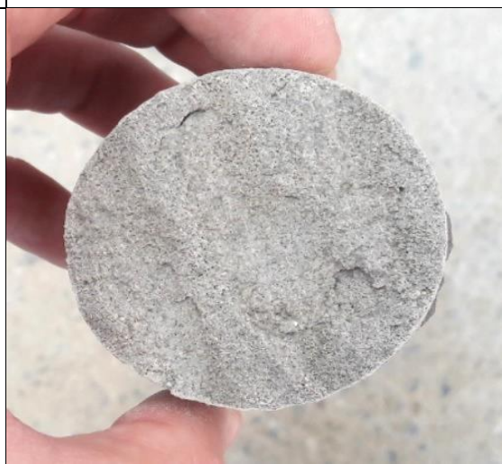
Figura 55 – Corpo de prova - nº10 - Placa de concreto - Fck 90 MPa
