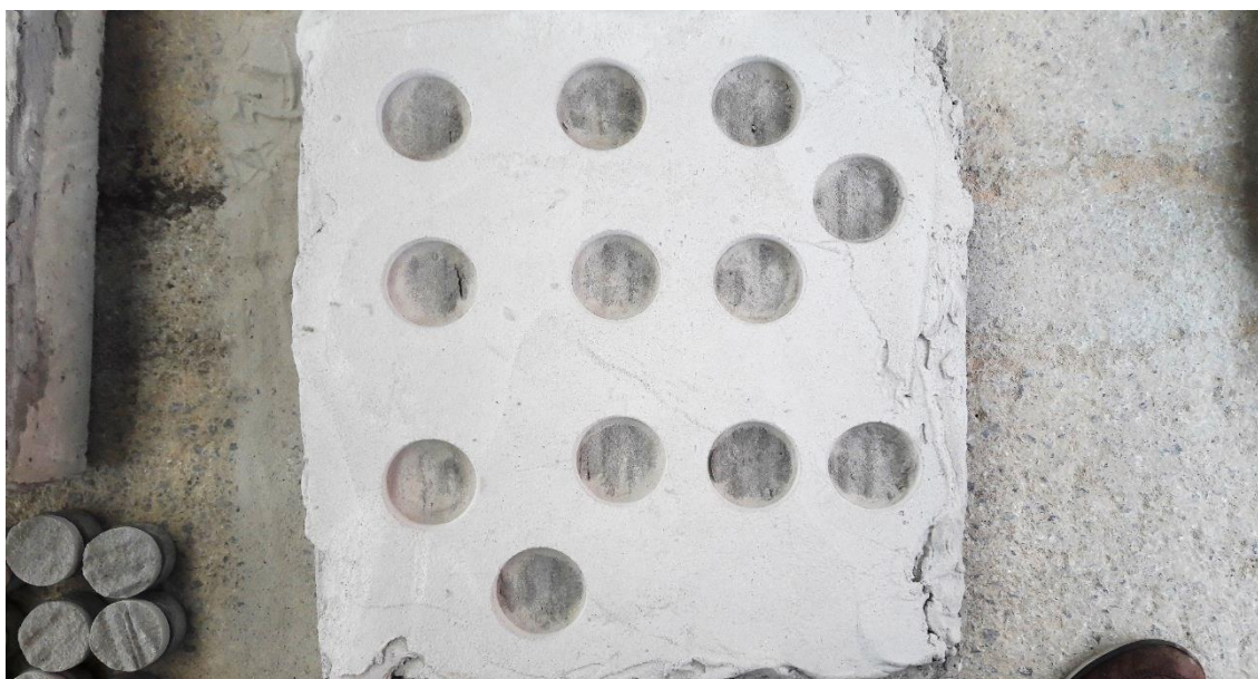
Figura 35 – Corpo de prova - Fck 20 MPa - Após a realização do ensaio de arrancamento.
