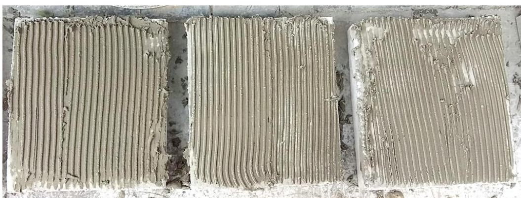
Figura 23 – Chapisco aplicado nas placas de 20, 90 e 70 MPa, respectivamente.
