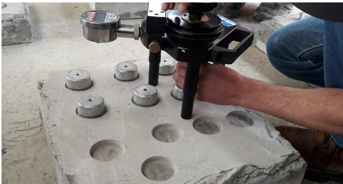
Figura 32 – Posicionamento do aparelho de arrancamento - placa de concreto - Fck 20 MPa.
