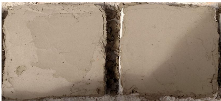
Figura 27 – Argamassa aplicada nas placas de 60 e 20 MPa respectivamente.
