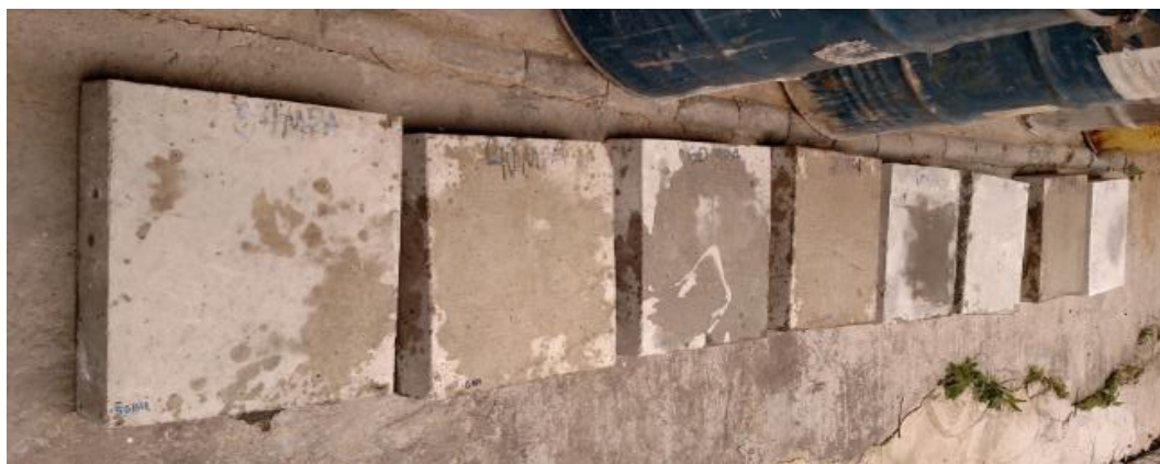
Figura 18 – Placas de concreto de após a retirada do tanque de cura.
