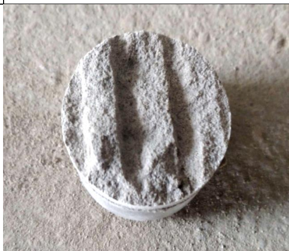
Figura 46 – Corpo de prova - nº 07 - Placa de concreto - Fck 60 MPa
