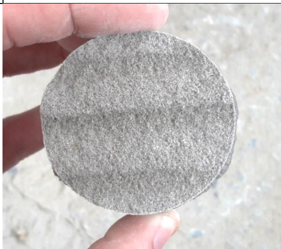
Figura 49 – Corpo de prova - nº10 - Placa de concreto - Fck 70 MPa
