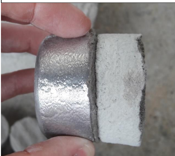
Figura 51 – Corpo de prova - nº 10 - Placa de concreto - Fck 80 MPa
