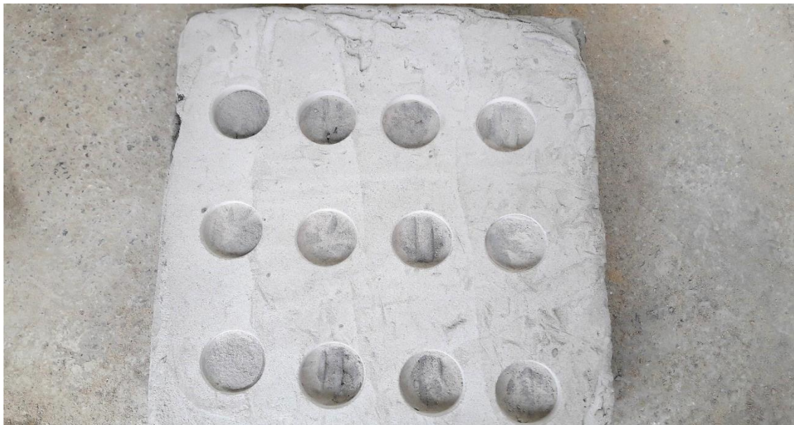
Figura 53 – Corpo de prova - Fck 80 MPa - Após a realização do ensaio de arrancamento.
