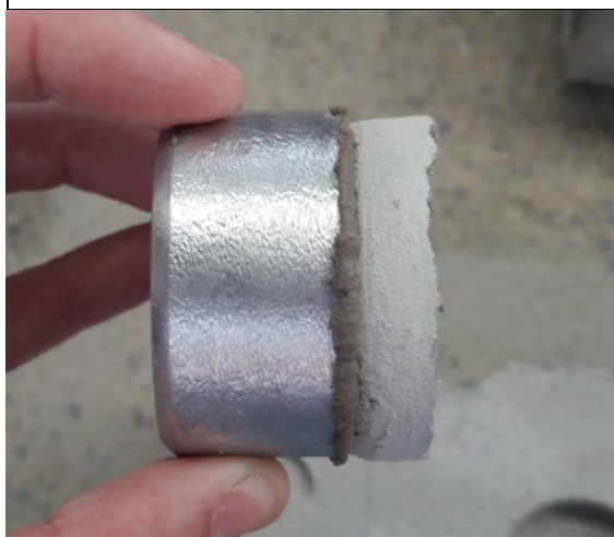
Figura 39 – Corpo de prova - nº 07 - Placa de concreto - Fck 40 MPa
