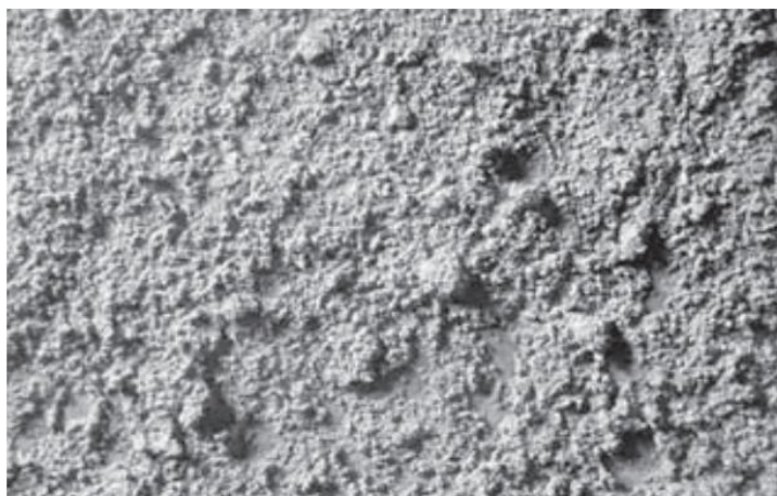
Figura 4 – Aspecto da superfície do chapisco convencional.
