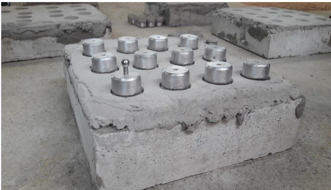
Figura 30 – Pastilhas coladas para a realização do ensaio - placa de concreto - Fck 80 MPa.
