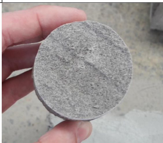
Figura 40 – Corpo de prova - nº 07 - Placa de concreto - Fck 40 MPa
