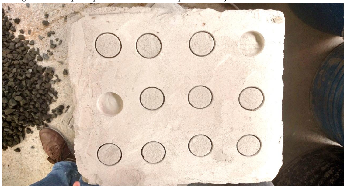
Figura 38 – Corpo de prova - Fck 30 MPa - Após a realização do ensaio de arrancamento.
