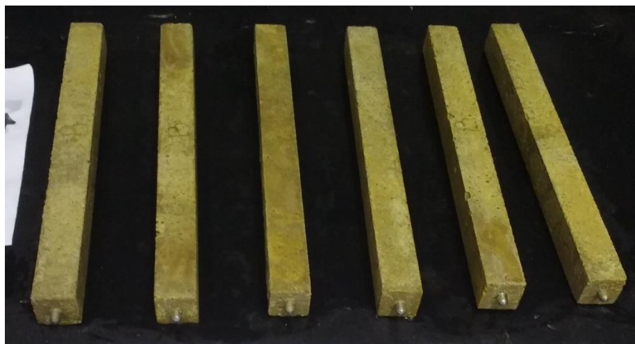
Figura 20. Corpos de prova moldados com cimento CP V, após 44 dias de imersão em ácido sulfúrico, face B (Os autores, 2016).
