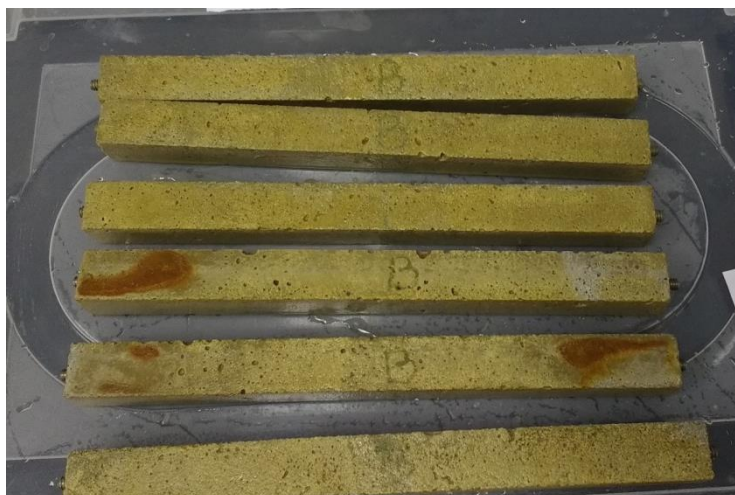
Figura 18. Corpos de prova moldados com cimento CP V, após 7 dias de imersão em ácido sulfúrico, face B (Os autores, 2016).
