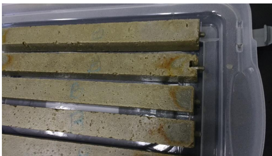
Figura 68. Imagem ampliada das barras moldadas com cimento CP II Z imersas em solução de ácido sulfúrico aos 7 dias de idade (Os autores, 2016).
