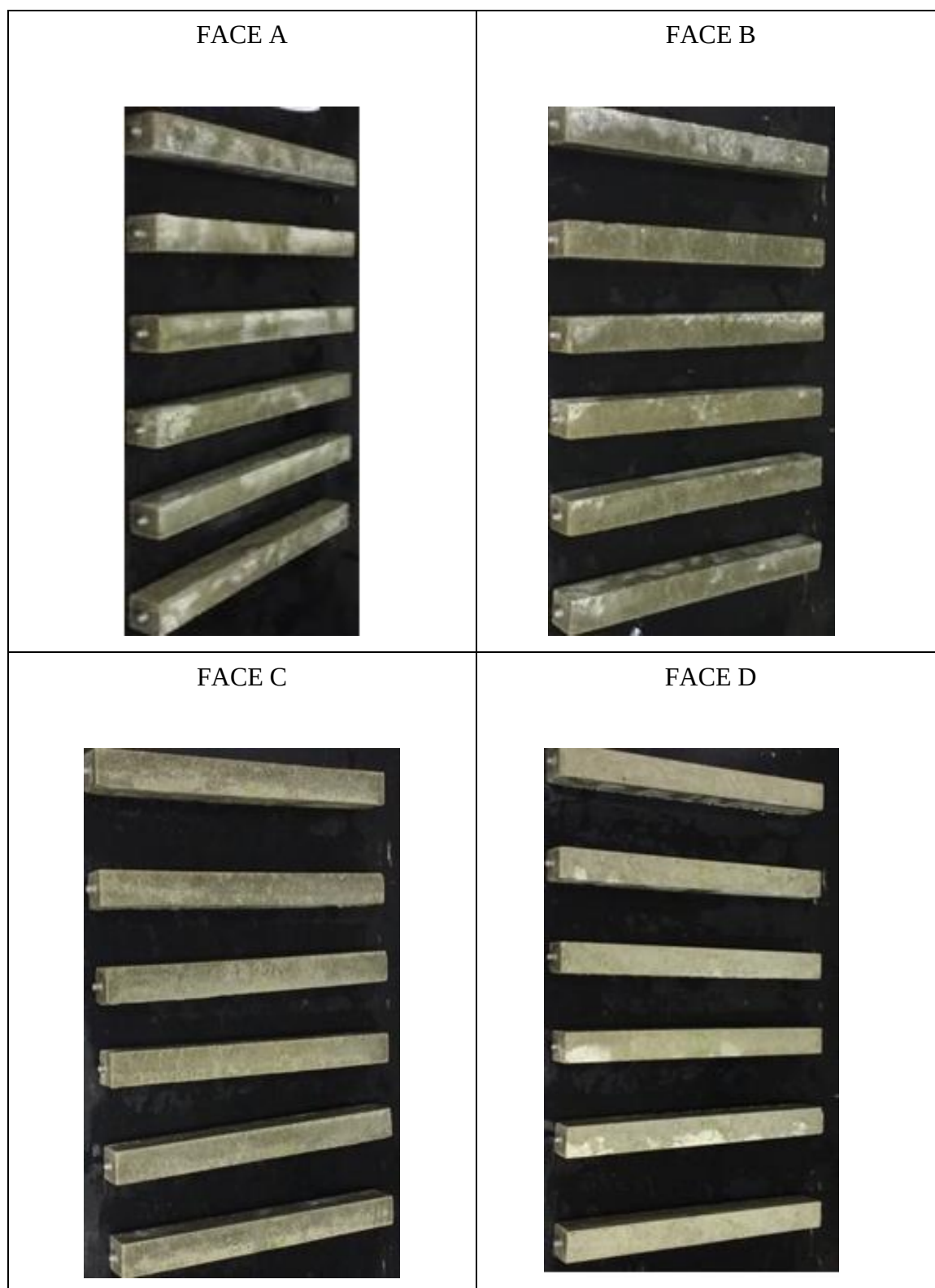
Figura 56. Barras moldadas com cimento CP V imersas em solução de sulfato de sódio aos 44 dias de idade (Os autores, 2016).
