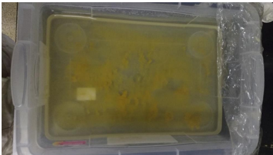
Figura 71. Solução em que estavam imersas as barras moldadas com cimento CP II Z imersas em solução de ácido sulfúrico aos 14 dias de idade (Os autores, 2016).
