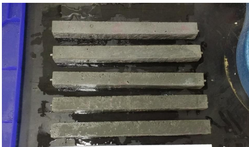
Figura 37. Corpos de prova moldados com cimento CP IV-32 RS, após 14 dias de imersão em solução de sulfato de sódio, face C (Os autores, 2016).
