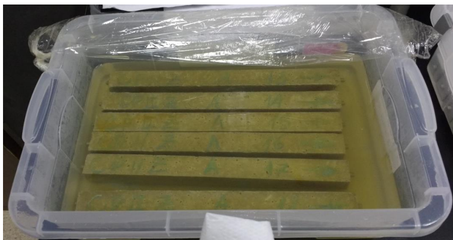
Figura 42. Solução de ácido sulfúrico com corpos de prova de CP II V, após 7 dias de imersão (Os autores, 2016).
