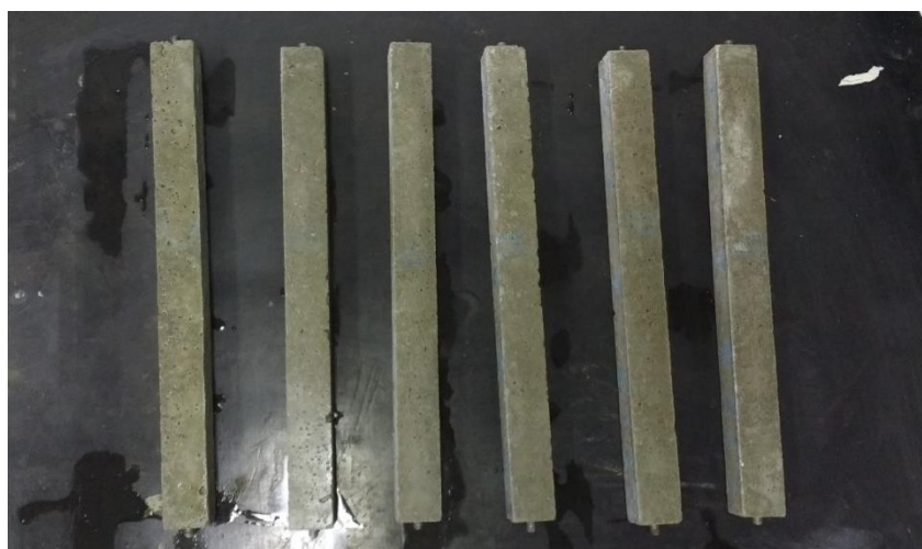
Figura 21. Corpos de prova moldados com cimento CP II Z, antes de imersão em ácido sulfúrico, face B (Os autores, 2016).
