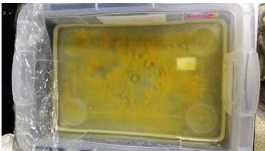
Figura 39. Solução de ácido sulfúrico com corpos de prova de cimento CP IV-32 RS (Os autores, 2016).
