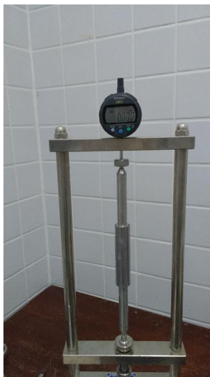
Figura 11. Relógio comparador utilizado para medição dos corpos de prova (Os autores, 2016)
