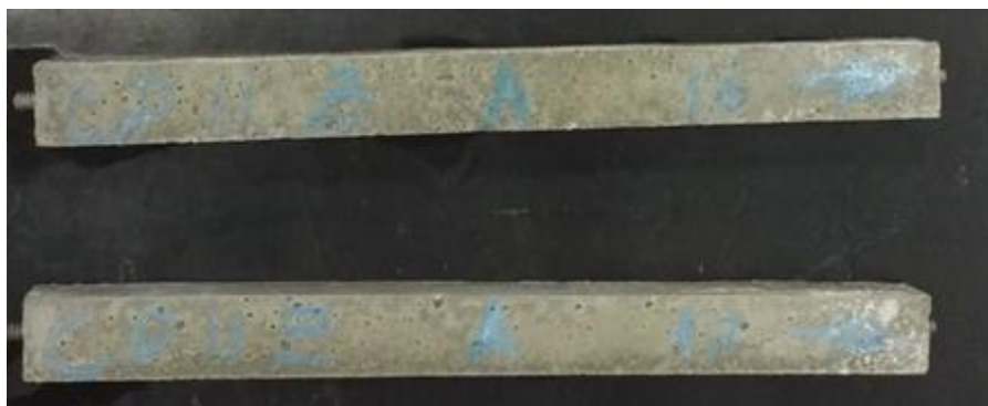
Figura 13. Detalhe da identificação dos corpos de prova, contendo o tipo do cimento, face, número do corpo de prova e direção do ensaio de variação dimensional (Os autores, 2016).
