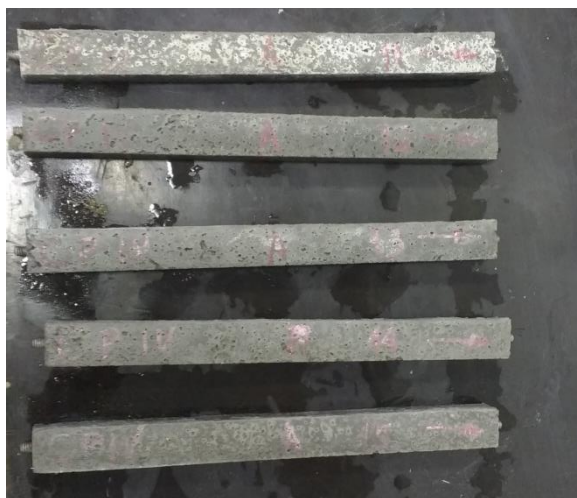
Figura 25. Corpos de prova moldados com cimento CP IV-32 RS, antes da imersão em ácido sulfúrico (Os autores, 2016).
