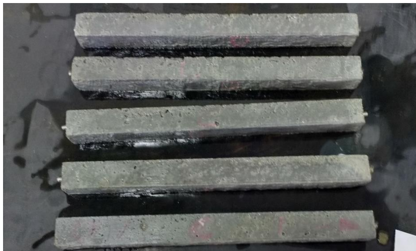
Figura 36. Corpos de prova moldados com cimento CP IV-32 RS, após 7 dias de imersão em solução de sulfato de sódio, face C (Os autores, 2016).
