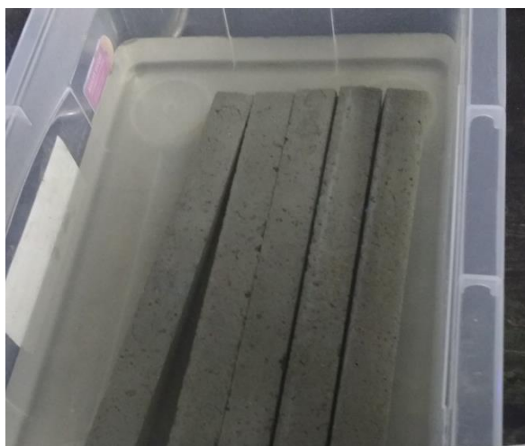
Figura 74. Solução onde estavam imersas as barras moldadas com cimento CP IV-32 RS imersas em solução de ácido sulfúrico aos 7 dias de idade (Os autores, 2016).
