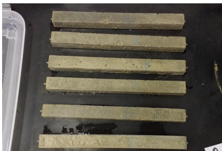
Figura 35. Corpos de prova moldados com cimento CP II Z após 14 dias de imersão em solução de sulfato de sódio, face B (Os autores, 2016)
