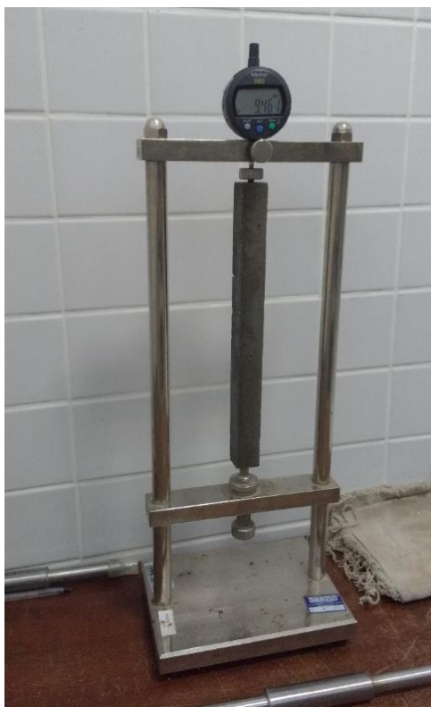
Figura 16. Barra sendo medida em um comparador de medidas (Os autores, 2016).
