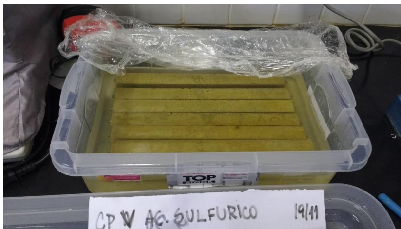
Figura 64. Solução onde estavam imersas as barras moldadas com cimento CP V imersas em solução de ácido sulfúrico aos 7 dias de idade com coloração alterada.
