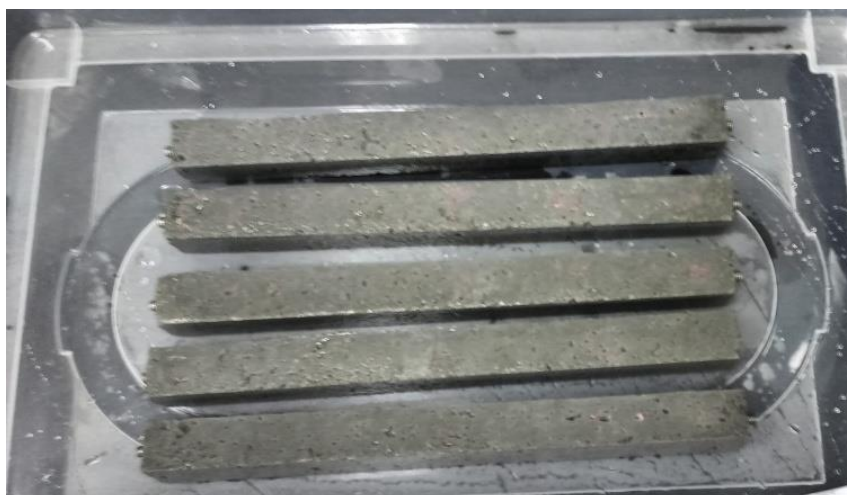
Figura 26. Corpos de prova moldados com cimento CP IV-32 RS, após 7 dias de imersão em ácido sulfúrico (Os autores, 2016)
