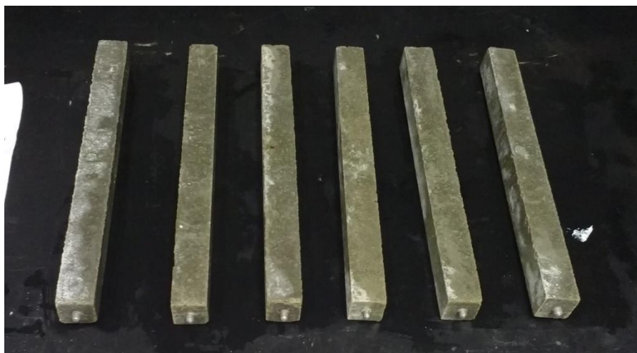
Figura 32. Corpos de prova moldados com cimento CP V, após 44 dias de imersão em solução de sulfato de sódio, face B (Os autores, 2016)
