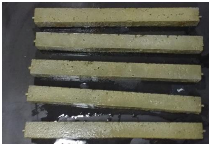
Figura 27. Corpos de prova moldados com cimento CP IV-32 RS, após 14 dias de imersão em ácido sulfúrico (Os autores, 2016).
