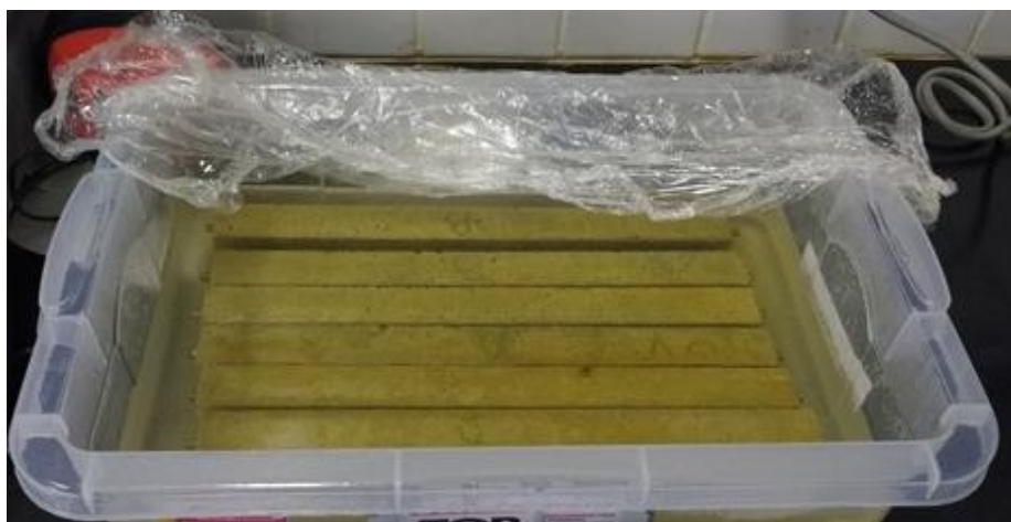
Figura 41. Solução de ácido sulfúrico com corpos de prova de CP V após 7 dias (Os autores, 2016).
