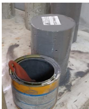
Aplicação do revestimento epoxídico no perímetro e face superior dos CP's para formação de barreira de vapor antes da aplicação do inibidor
