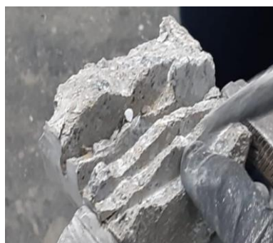
Detalhe das fatias e da retirada das amostras dos CP's
