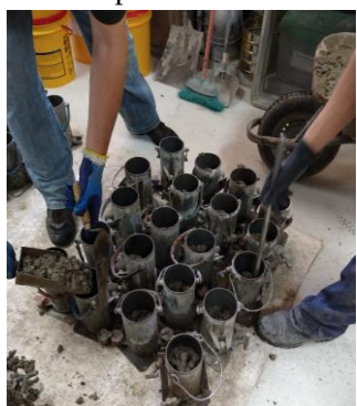
Adensamento manual do concreto nas formas
