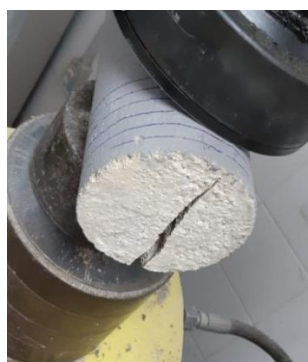
Rompimento do corpo de prova à tração por compressão diametral para facilitar retirada das amostras
