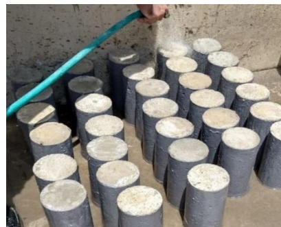
Lavagem superficial dos CP's nas 24 horas após a aplicação do inibidor de corrosão.
