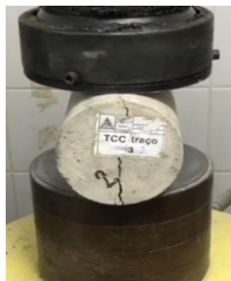
Rompimento à tração por compressão diametral para medição da absorção (visual)
