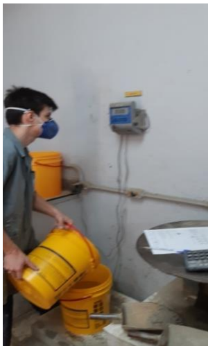
Pesagem da água de amassamento, conforme NBR 15900-1 (2009)
