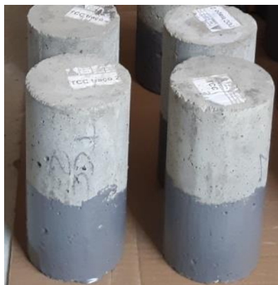
Aplicação parcial do revestimento epóxi no perímetro dos CP's para ensaio de absorção
