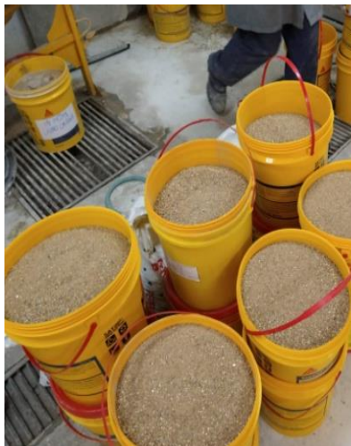
Separação do agregado miúdo após pesagem – Areia Grossa
