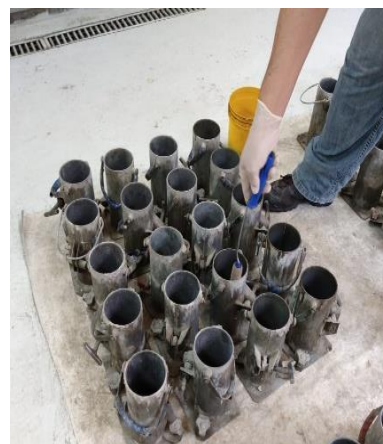
Aplicação de desmoldante nas formas
