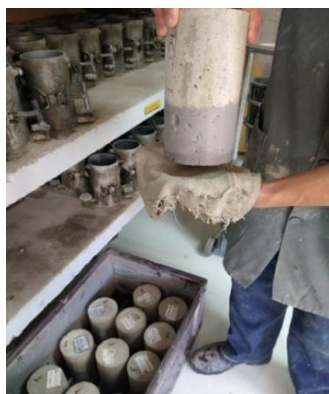
Detalhe da secagem do ensaio de absorção de água por capilaridade
