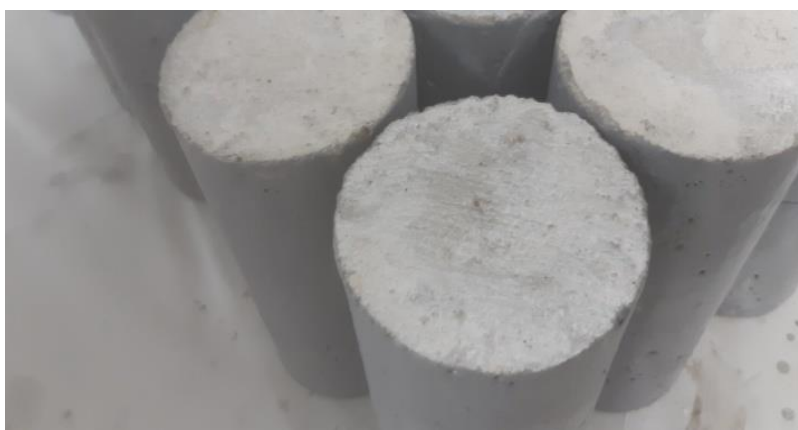
Figura 39. Formação de sais esbranquiçados na superfície do corpo de prova após 24 horas de aplicação do inibidor
