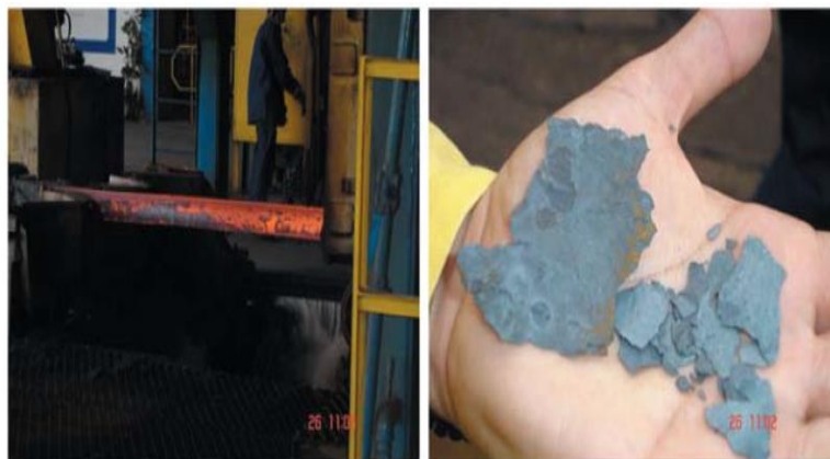
Figura 15. Carepas na superfície do tarugo de aço (esquerda) e carepas eliminadas durante o processo (direita). https://www.scielo.br/pdf/rem/v59n1/a014.pdf - acesso 11/10/2020
