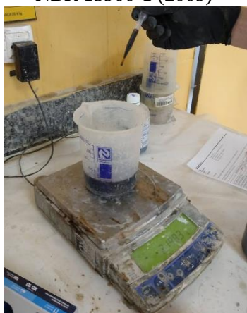
Pesagem do aditivo plastificante
