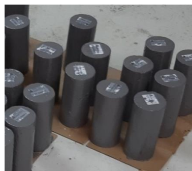
Revestimento epoxídico no perímetro e face superior dos CP's para formação de barreira de vapor antes da aplicação do inibidor
