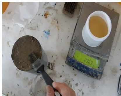
Aplicação do Inibidor de Corrosão na face sem epóxi dos CP's utilizando pincel e com medição de consumo por peso
