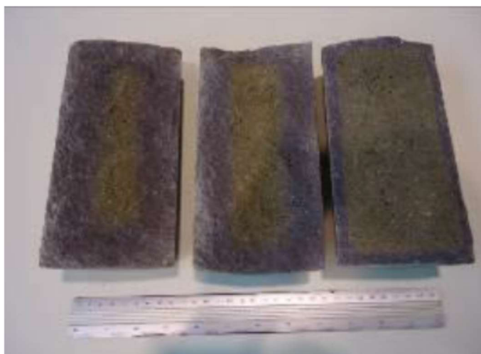
Figura 20: CP II-F, CP II-Z e CP IV, respectivamente, após a aspersão do nitrato de prata
