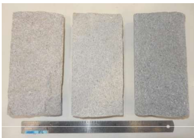
Figura 17: CP II-F, CP II-Z e CP IV, respectivamente, antes da aspersão de nitrato de prata
