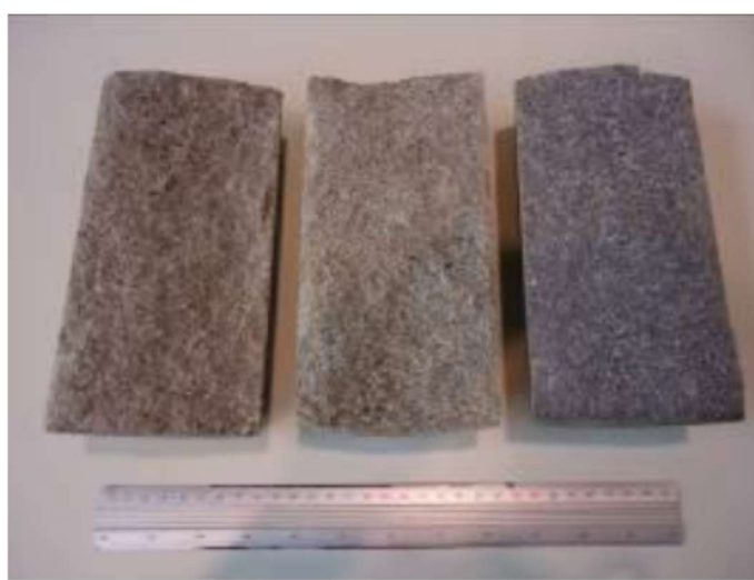
Figura 19: CP II-F, CP II-Z e CP IV, respectivamente, antes da aspersão de nitrato de prata
