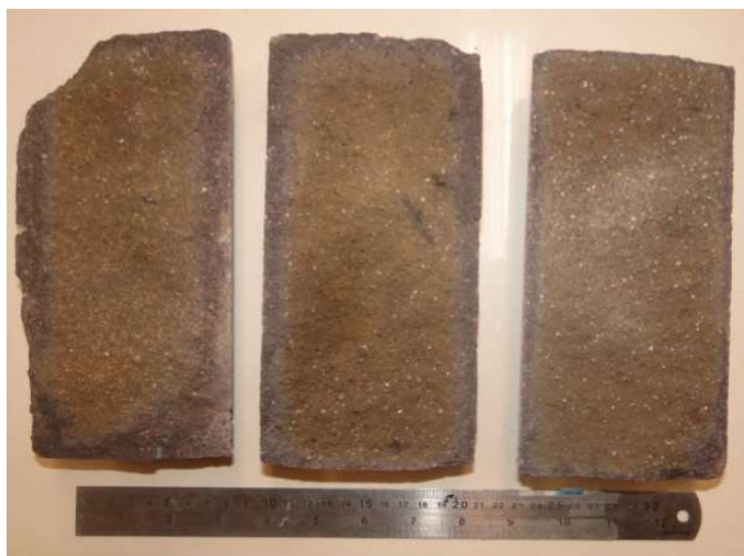
Figura 16: CP II-F, CP II-Z e CP IV, respectivamente, após a aspersão do nitrato de prata
