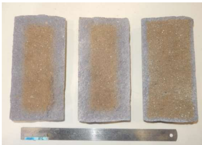
Figura 18: CP II-F, CP II-Z e CP IV, respectivamente, após a aspersão do nitrato de prata
