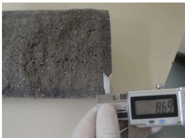
Figura 9: Medição da penetração de cloretos na argamassa
