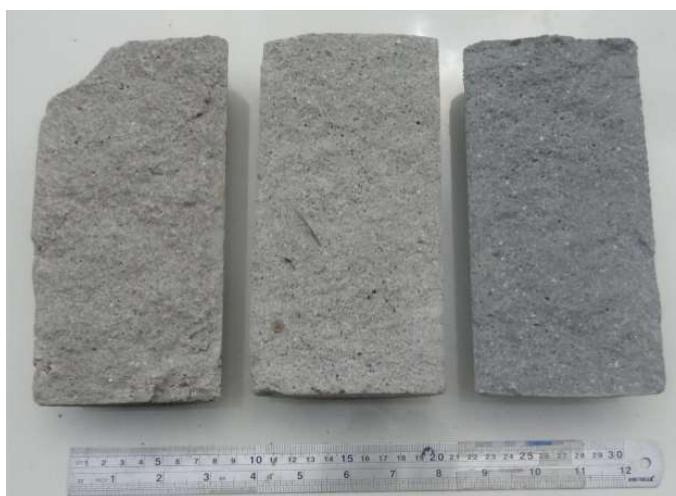
Figura 15: CP II-F, CP II-Z e CP IV, respectivamente, antes da aspersão de nitrato de prata
