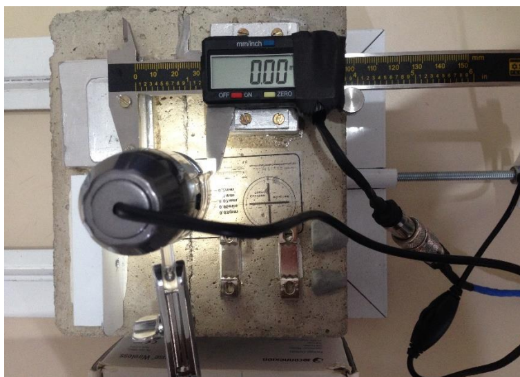
Figura 38 – Ensaio para confiabilidade do paquímetro (acervo pessoal).
