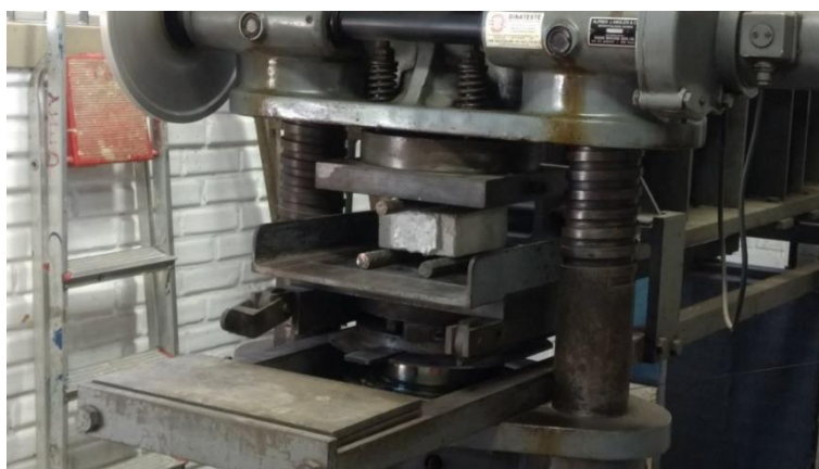
Figura 32 - Rompimento do bloco em concreto na prensa hidráulica (Acervo pessoal).
