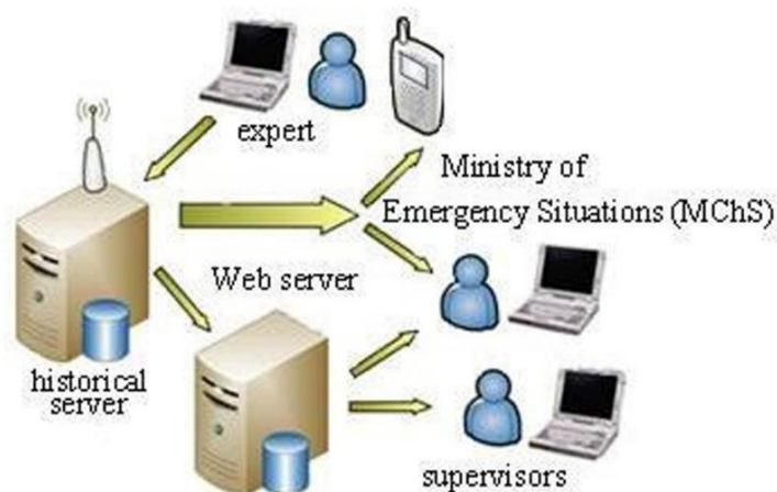
Figura 2 - Estrutura do pequeno sistema de monitoramento de pontes de concreto. (KRAKHMAL'NY et al., 2016, p. 2372).
