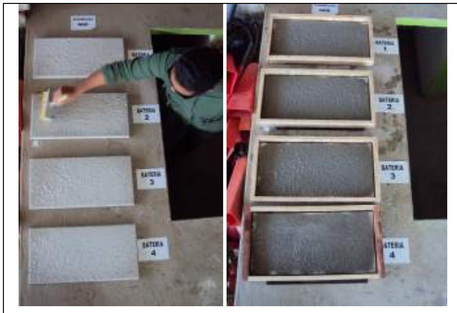
Figura 27. Preparo das bases para revestimentos – Grupo A (AUTORES)
