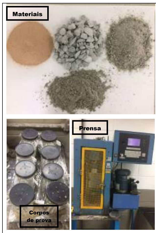
Figura 6. Validação do concreto dos Substratos Padrão (ALVES, 2016)
