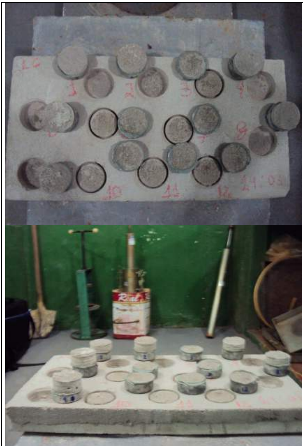
Figura 42. Formas de ruptura – Amostra 1C (AUTORES)
