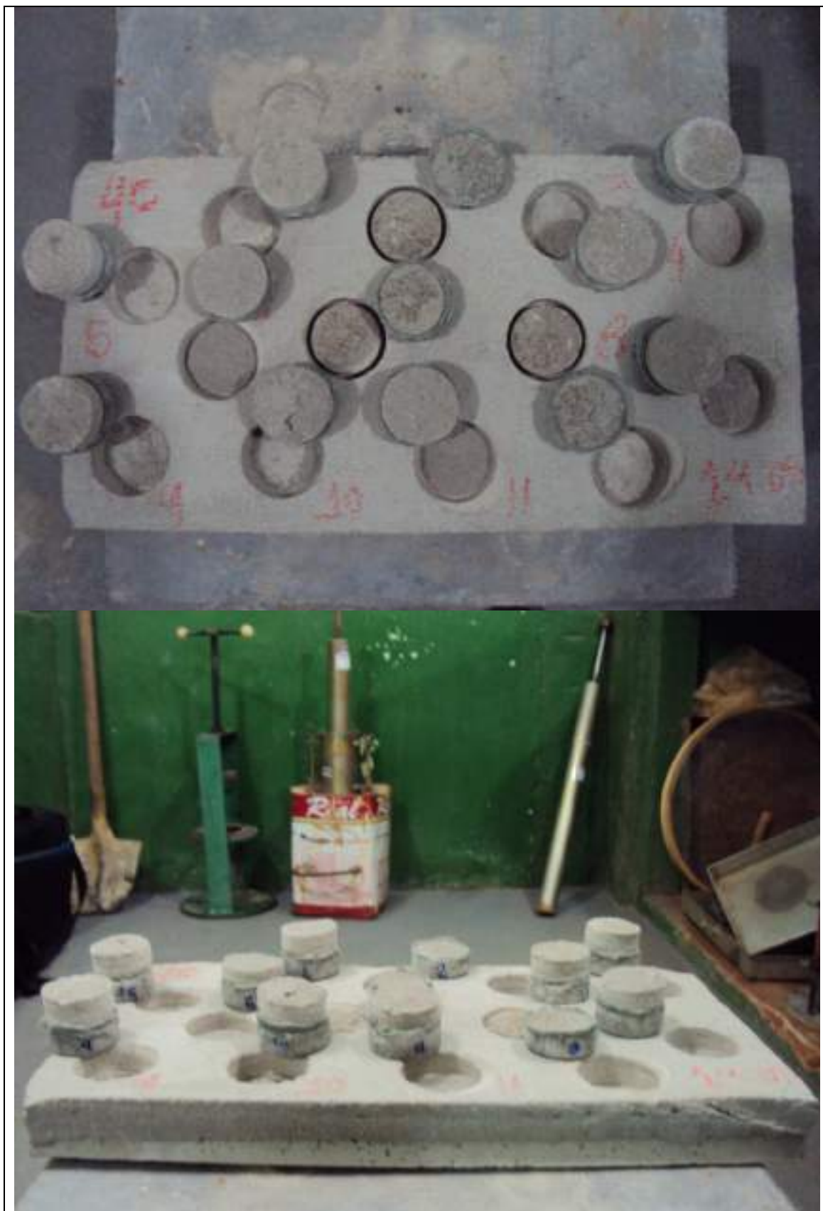
Figura 54. Formas de ruptura – Amostra 4C (AUTORES)
