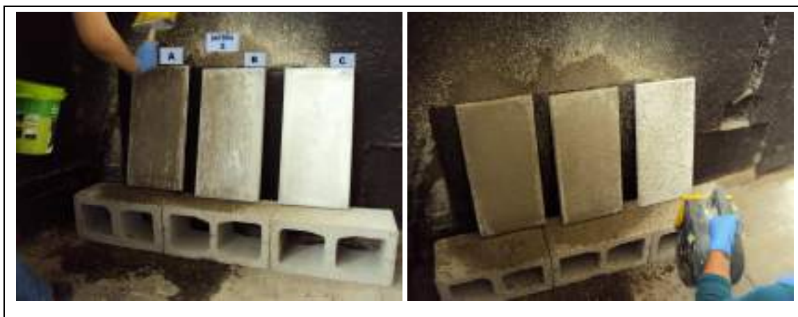
Figura 16. Preparo e aplicação chapisco – Bateria 2 – Adição de adesivo PVA 1:1 (AUTORES)
