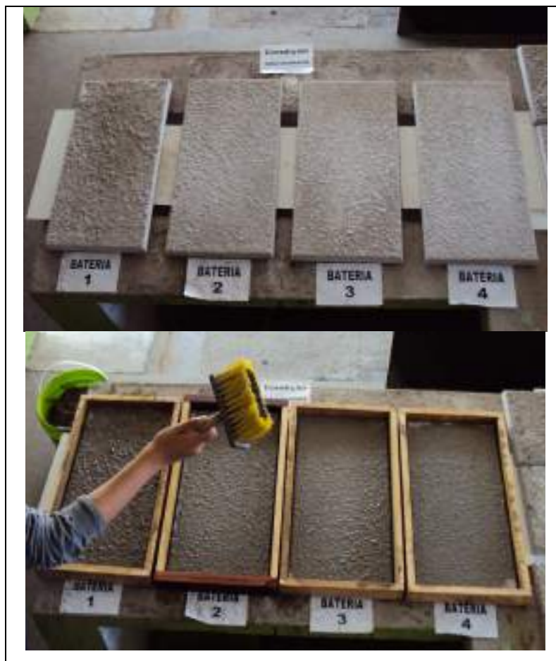
Figura 30. Preparo das bases para revestimentos – Grupo B (AUTORES)
