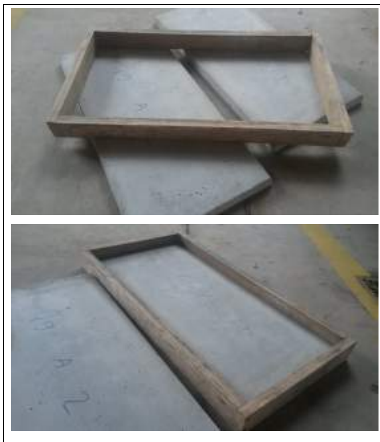
Figura 24. Gabarito em madeira para uniformizar espessura do revestimento (AUTORES)
