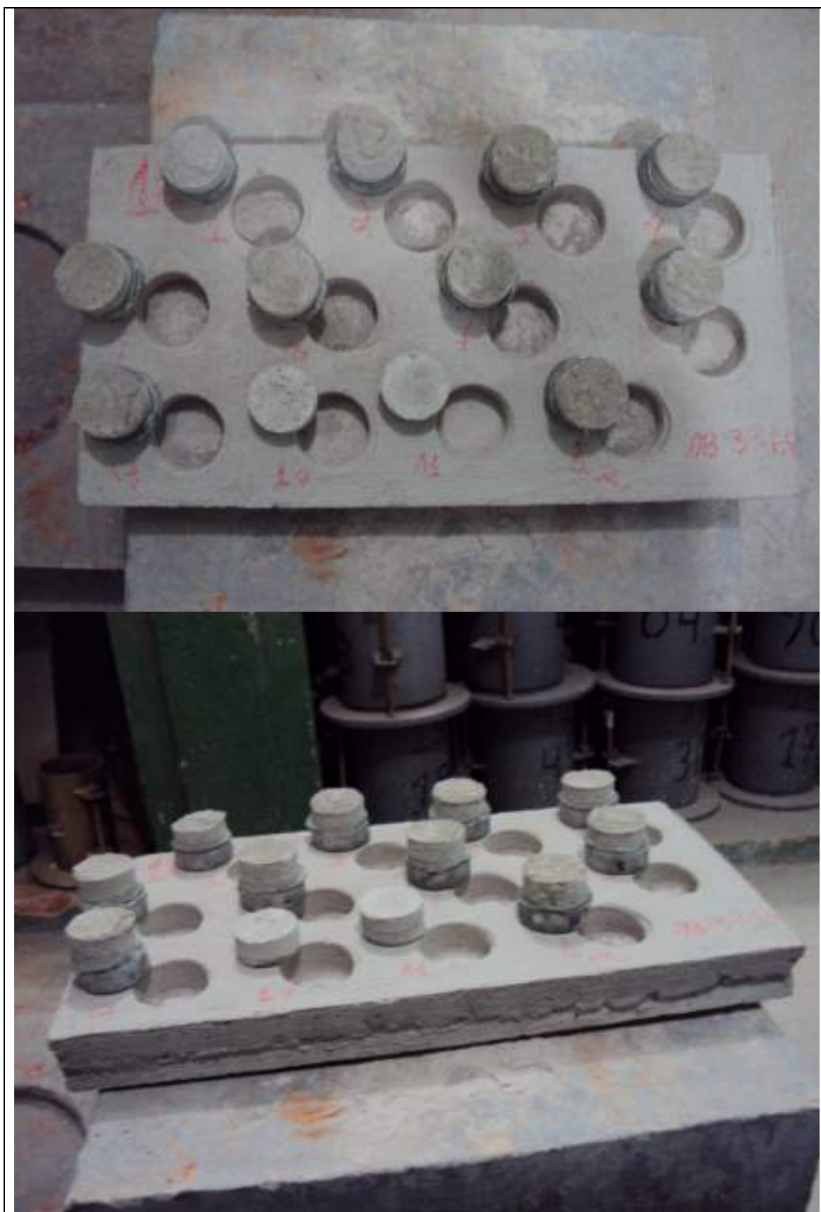
Figura 41. Formas de ruptura - Amostra 1B (AUTORES)
