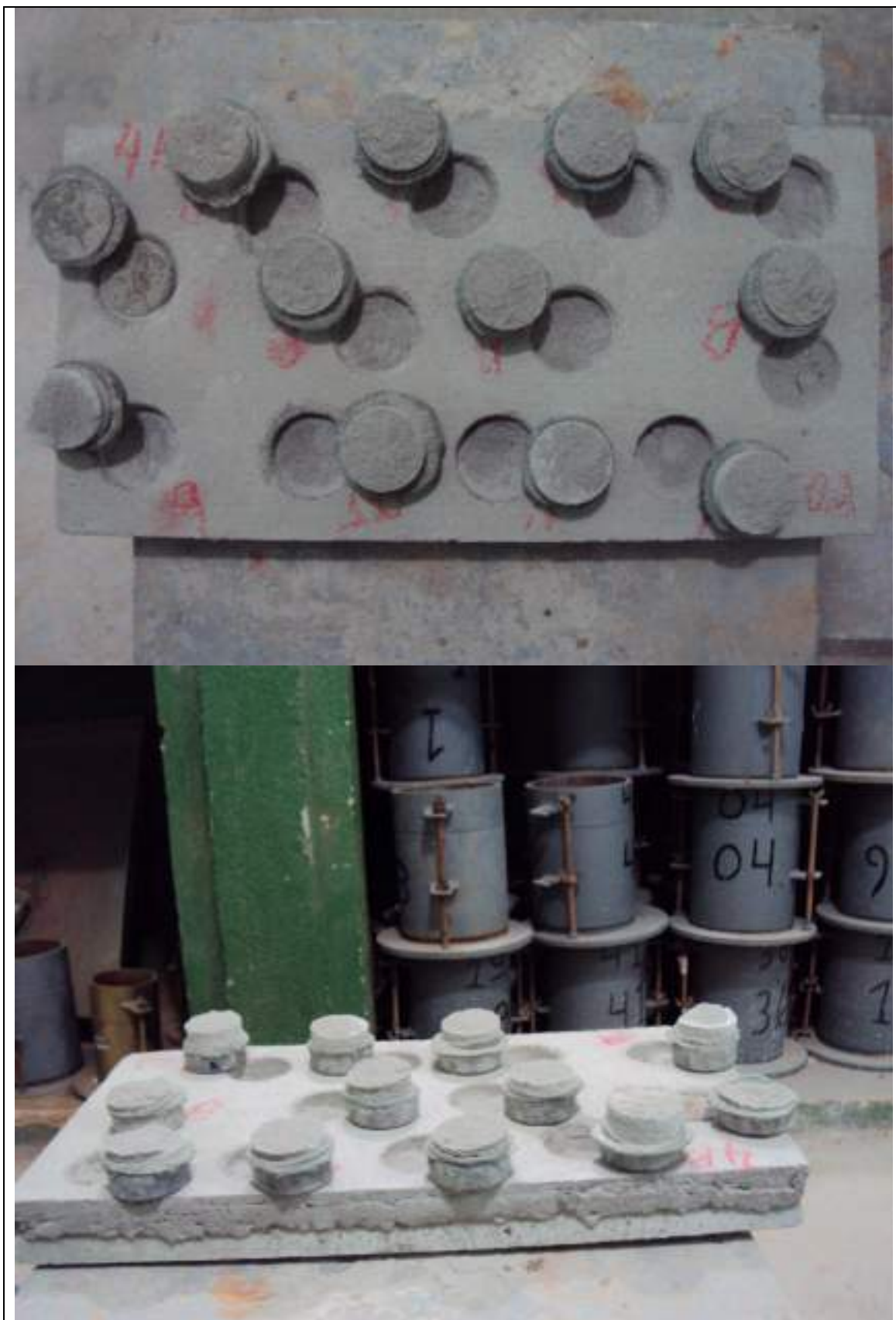
Figura 53. Formas de ruptura – Amostra 4B (AUTORES)
