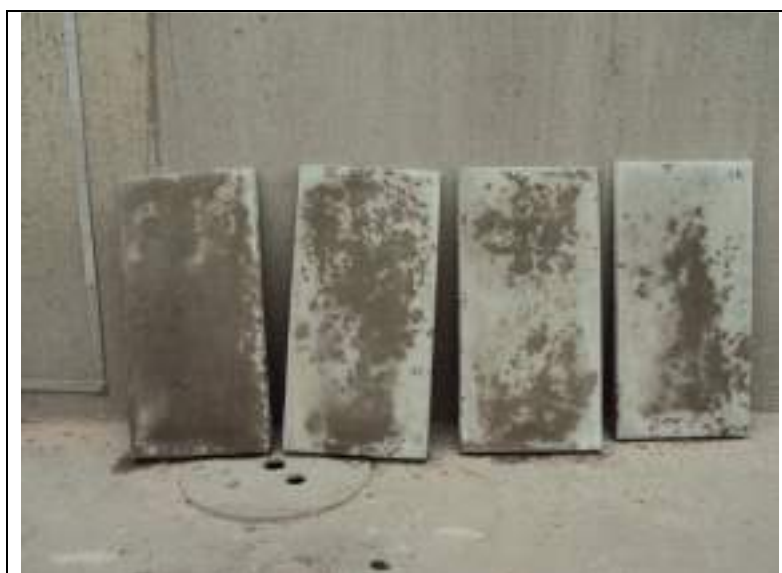
Figura 10. Preparação das bases de revestimento – Placas GRUPO A secando (AUTORES)
