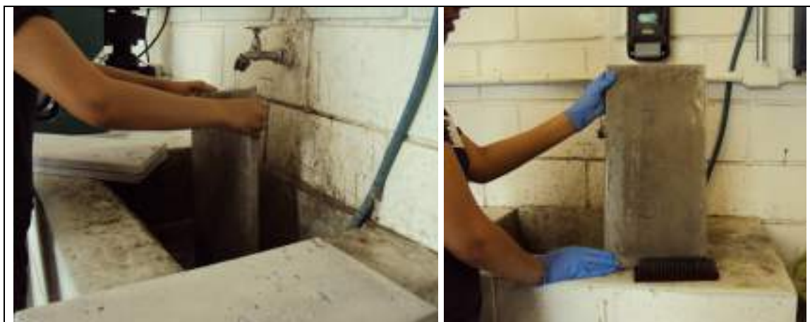
Figura 9. Preparação das bases de revestimento – Placas GRUPO A limpeza (AUTORES)
