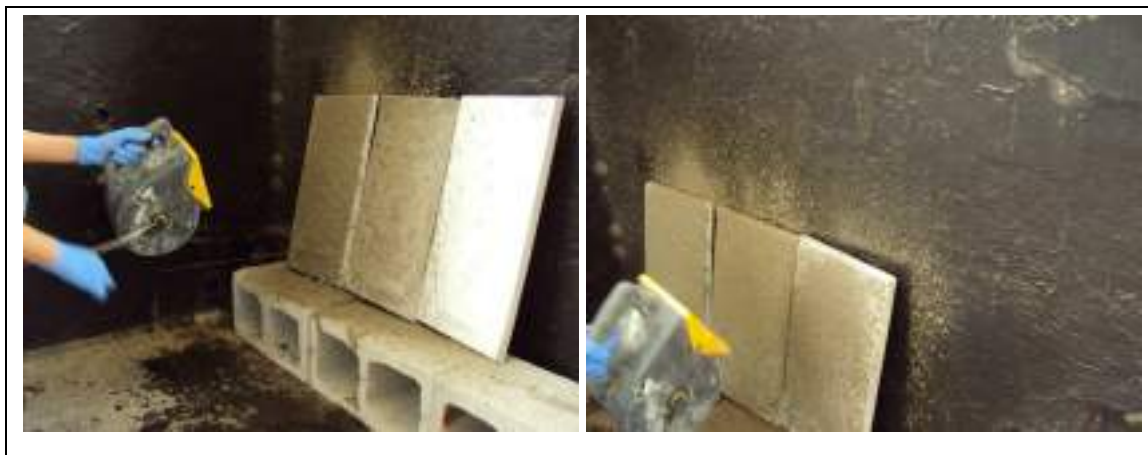
Figura 15. Aplicação chapisco sem adição de adesivo PVA – Bateria 1 (AUTORES)
