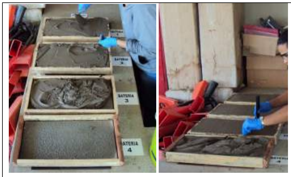
Figura 28. Preparo das bases para revestimento – Grupo A (AUTORES)
