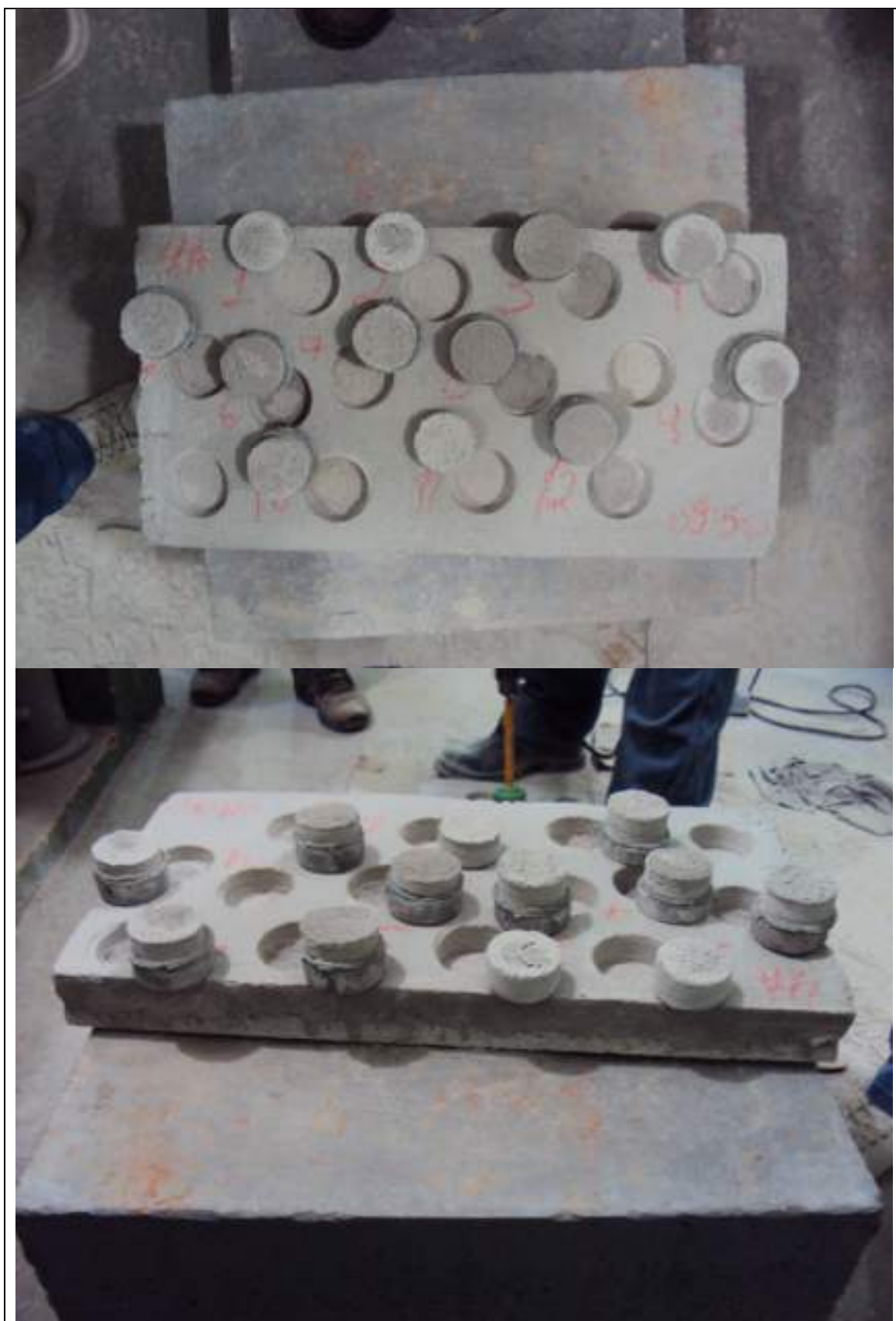
Figura 52. Formas de ruptura - Amostra 4A (AUTORES)
